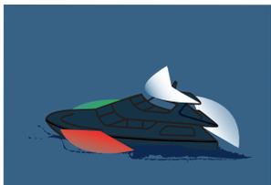
Маломерное судно на ходу, использует механический двигатель
