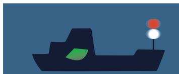
Использует иное орудие лова, чем трал, длина до 50 м, орудие лова выходит за судно менее чем на 150 м, на ходу
