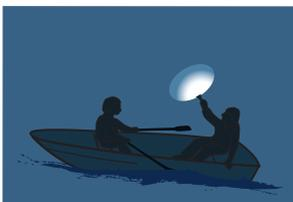
Гребная лодка (отсутствуют механический двигатель и парус), для идентификации зажечь белый огонь
