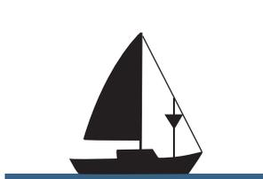
Использует механический двигатель, при расхождении отсутствует приоритетное право парусного судна
