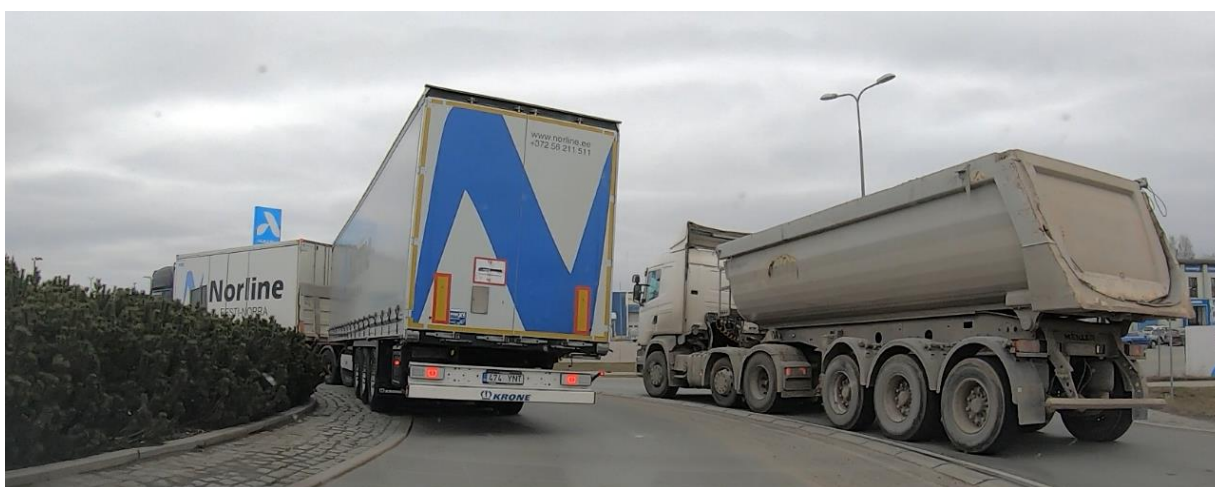
Foto 24. EMS autorongi liikumine väiksema raadiusega turboringi siseringil Keilas
