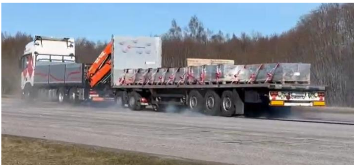
Foto 4. EMS autorongi 1 haagise rataste blokeerumine pidurduskatsel
