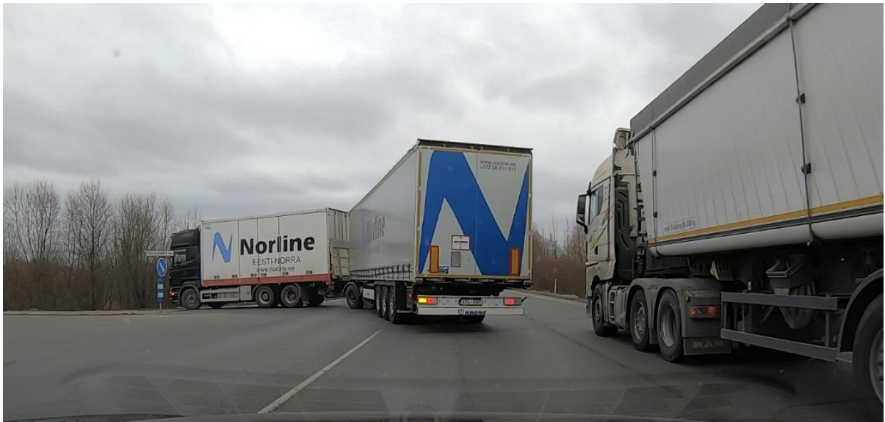
Foto 15. EMS autorongi vasakpööre testmarsruudi läbimisel
