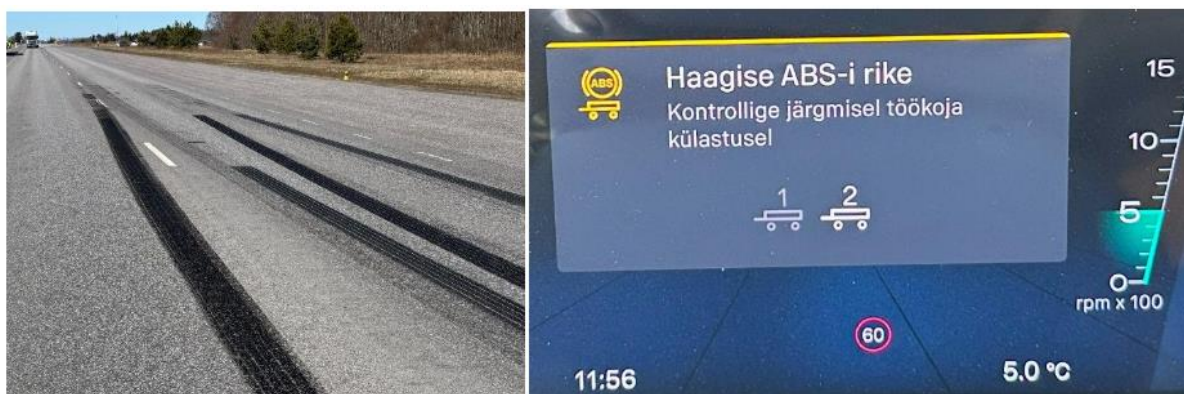
Foto 5. Blokeeritud ratastega pidurdamisele viitavad jäljed teekattel ( vasakpoolne ) ja Haagise ABS-süsteemi veateade EMS-autorong 1 pidurdamisel ( parempoolne )
