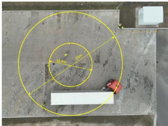
Foto 11. Tavapärase 16,5m pikkuse autorongi pöördekatse minimaalse nõutud pöördekoridori ja 25m laiuse tee korral.
