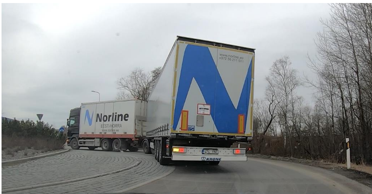
Foto 22. EMS autorongi liikumine väiksema raadiusega Keila ringil
