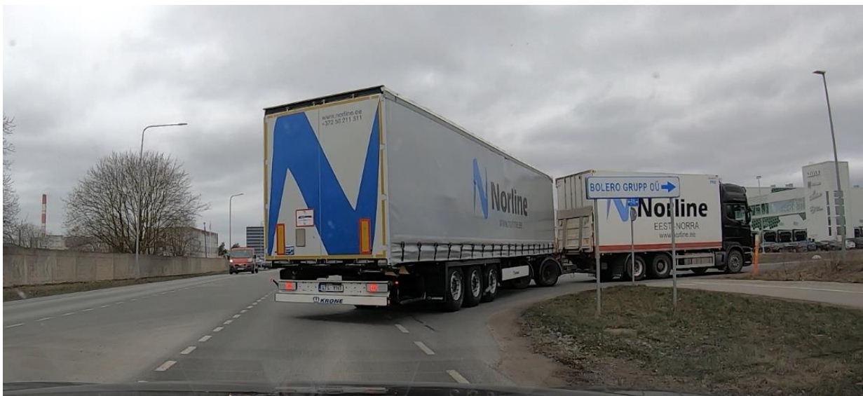
Foto 16. EMS autorongi parempööre testmarsruudi läbimisel
