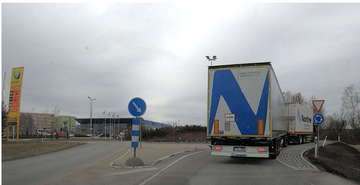
Foto 21. EMS autorongi liikumine väiksema raadiusega Keila ringil
