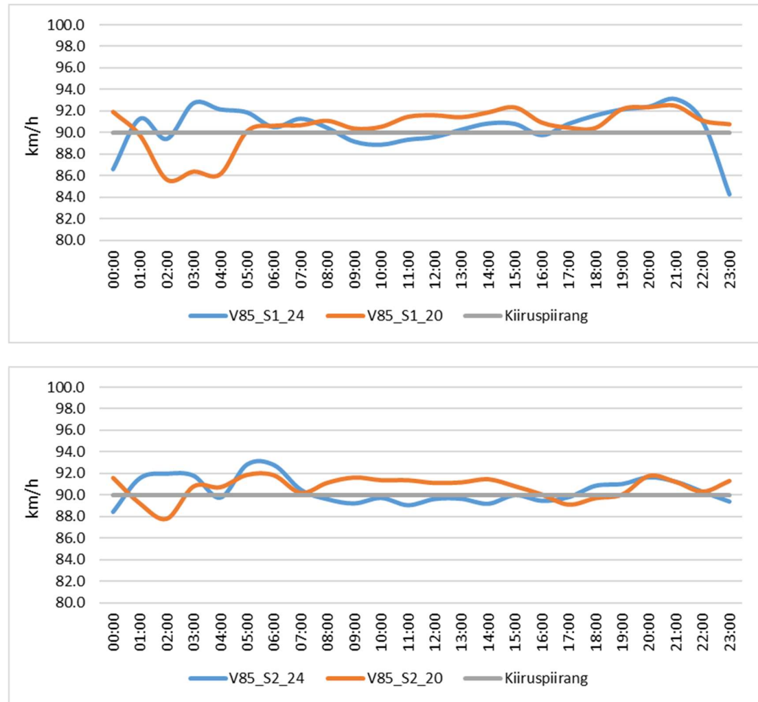
Joonis 4.8. Keskpiirdega teelõigu V_{kesk} andmed ööpäeva tundide lõikes loenduspunktides LP_2_24 ja LP_2_20 (S1 – sõidusuund 1; S2 – sõidusuund 2)
