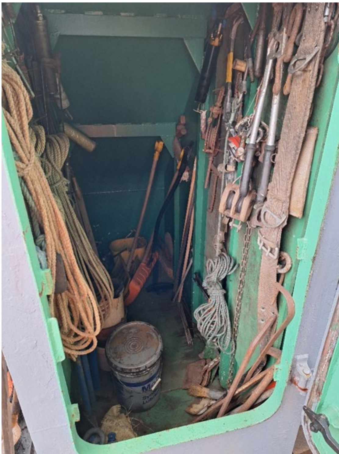
Foto 10 Laoruumiks muudetud vasaku parda avariiväljapääs
