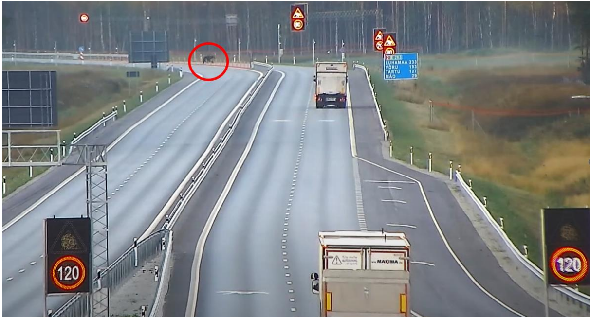
Pilt 1. Liikluskaamera video kuvatõmmis karu tee ületamisest, kui häire on aktiveeritud (Transpordiamet, 2021)
