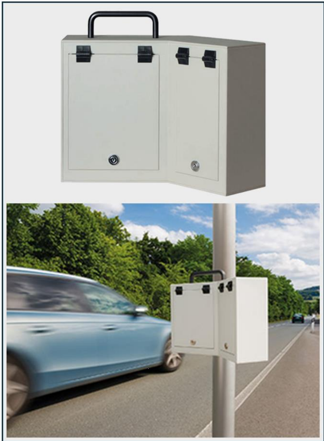
Joonis 5. Mobiilne radar Viacount II. Radar salvestab järgmised andmed: sõidukite kiirused, sõidukite arvu, sõidukite klassi ja vahe sekundites. (Via Traffic Controlling, s.a.)
