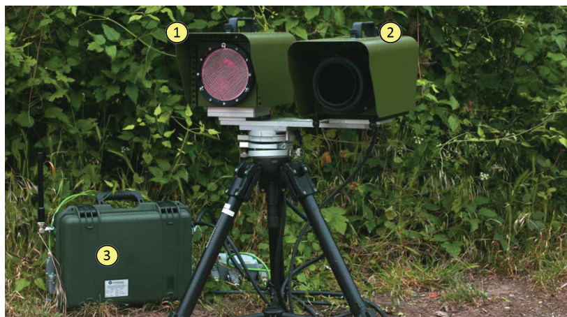
Foto 3. Teisaldatava süsteemi markeeringu selgitused: 1 - punane välklamp, 2 - nutikaamera, 3 - lisamoodul (foto: Vitronic PoliScan RC kasutusjuhend)
