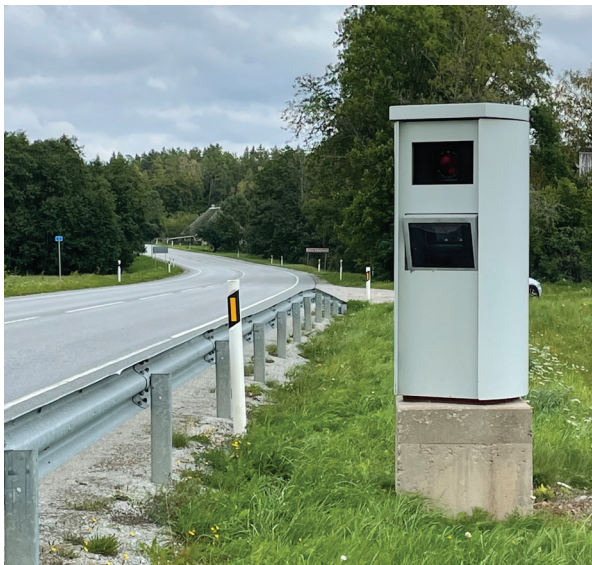
Foto 4 (vasakul). Foto 4 (vasakul) Statsionaarse mõõtesüsteemi ühes suunas mõõta võimaldav mõõtekabiin Ääsmäe-Haapsalu-Rohuküla mnt 3,4 km.
