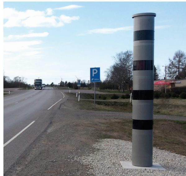
Foto 4 (vasakul). Foto 4 (vasakul) Statsionaarse mõõtesüsteemi ühes suunas mõõta võimaldav mõõtekabiin Ääsmäe-Haapsalu-Rohuküla mnt 3,4 km.
