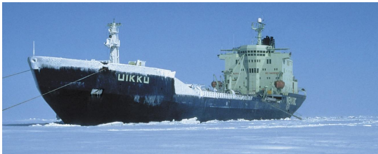
Joonis 44. IA Super jääklassi tootetanker jääd murdva vööriaga.
