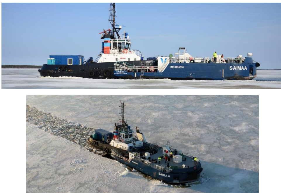
Joonis 51. Eemaldatav käituriiga jäämurdevöör Saimaa (sinine) kinnitatud pukserile Calypso (must).
