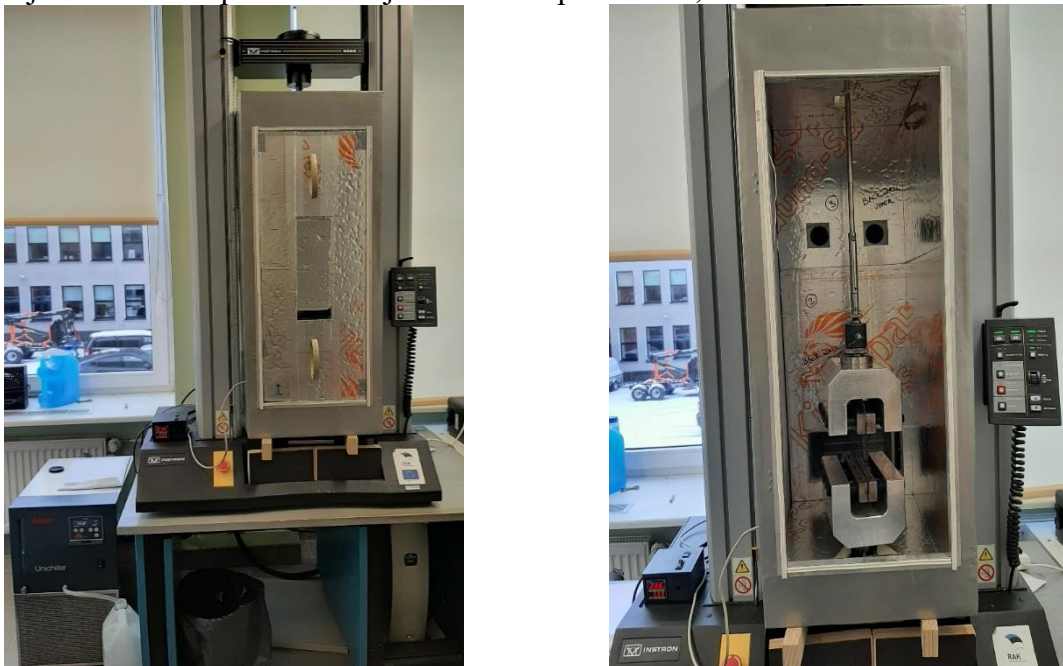
Joonis 7. Temperatuuri kontrolli kamber tõmbemasinal Instron 5866, kus (vasakul) kamber suletud uksega ning (paremal) avatud uksega kamber, kus sees on haaratsid.
