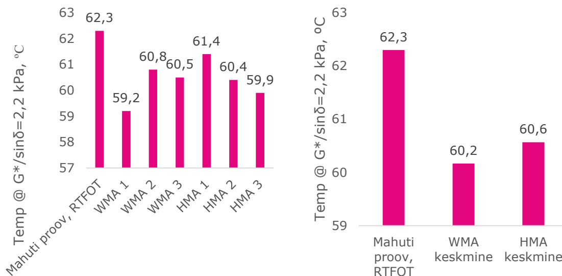
Joonis 13. Tehase mahutist võetud sideaine ja segudest eraldatud sideainete temperatuur, mille juures kompleksmooduli ja faasinurga suhe võrdub 2,2 kPa.
