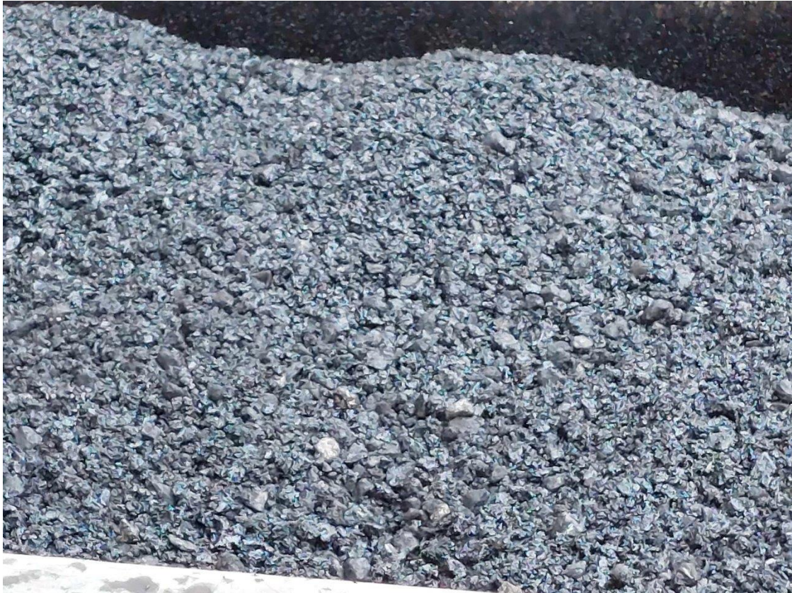
Joonis 4. Esimene WMA kogus veoki kastis. Üksikute terade puhul oli märgata, et bituumen ei olnud täitematerjali täielikult katnud.
