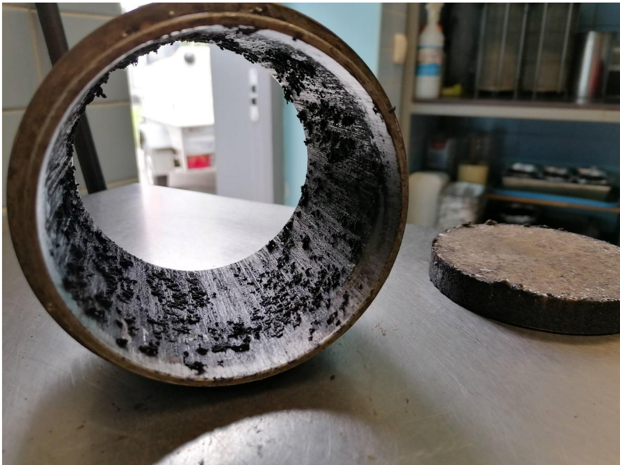
Joonis 4. Soe segu kleepus vormist väljasurumisel veidi vormi seintele
