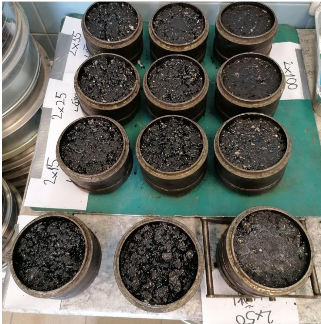
Joonis 1. Tihendatud sooja segu proovikehad
