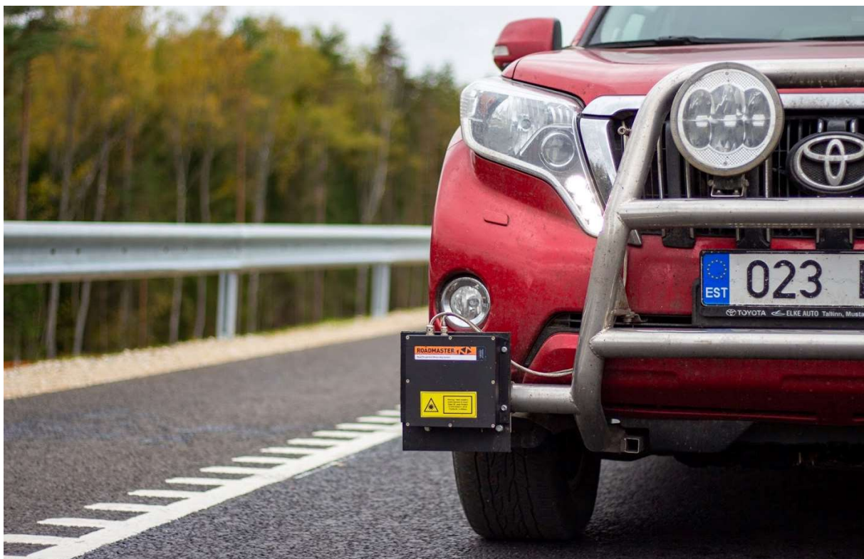
Joonis 4. Katte tasasuse ja tekstuuri mõõteseade LTM-1
