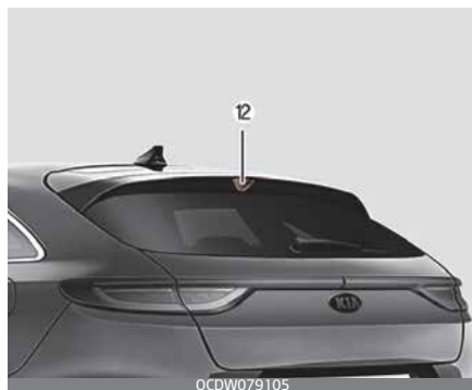
Дополнительный верхний стоп-сигнал — купе-универсал
