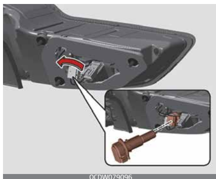
Задняя комбинированная фара — универсал (тип В)
