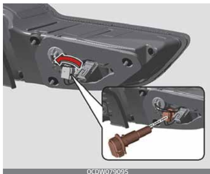
Задняя комбинированная фара — универсал (тип В)
