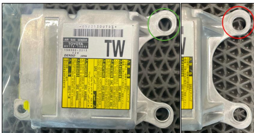
Sele 5. Toyota IQ ACM korduval paigaldamisel tekkivad jäljed
