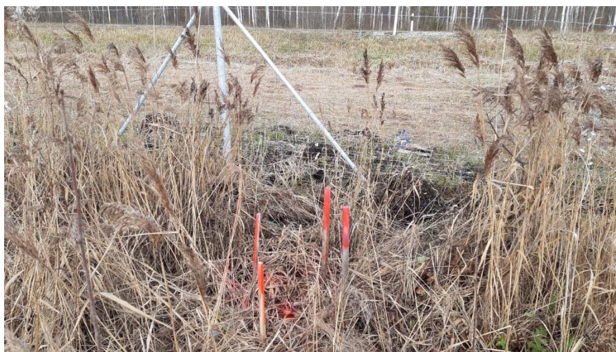
Foto 9. Geodeetilise nivelleerimise lähtepunkt, 2015. aastal paigaldatud pinnasreeper RP.
