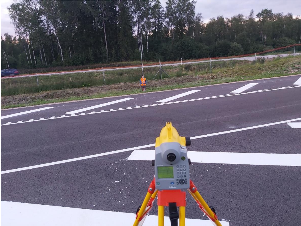
Foto 12. Nivelleerimisel kasutatud digitaalnivelliir Trimble DiNi03 (esiplaanil) suunatuna 4-meetri pikkusele mõõdulatile.
