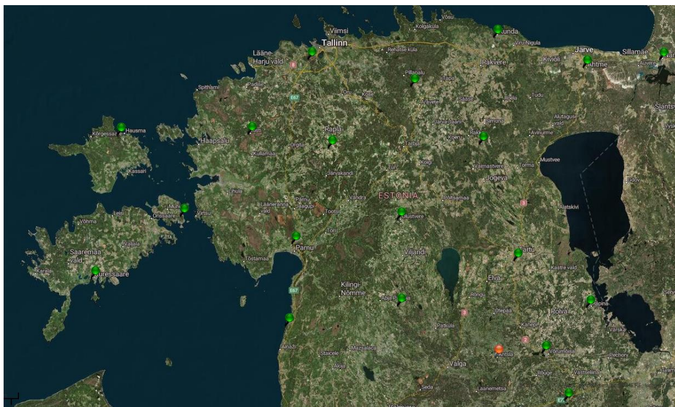
Joonis 5. Trimble VRS Now püsijaamad võrk Eestis (allikas: www.vrsnow.ee ).
