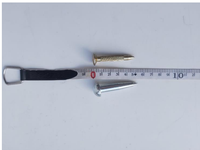
Foto 3. Kasutatud katendireeperid. Märka, et kollakast metallist 2 mm sügavuse tsentreerimisavaga katendireeperid n- ja s-profiilides tähistavad skaneerimistähiste (vt Foto 4) asukohti.
