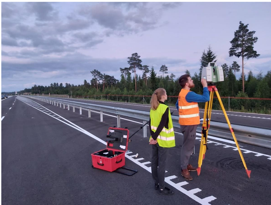
Foto 14. Teekatendi laserskaneerimine 07.08.2020 laserskanneriga Leica ScanStation C10.
