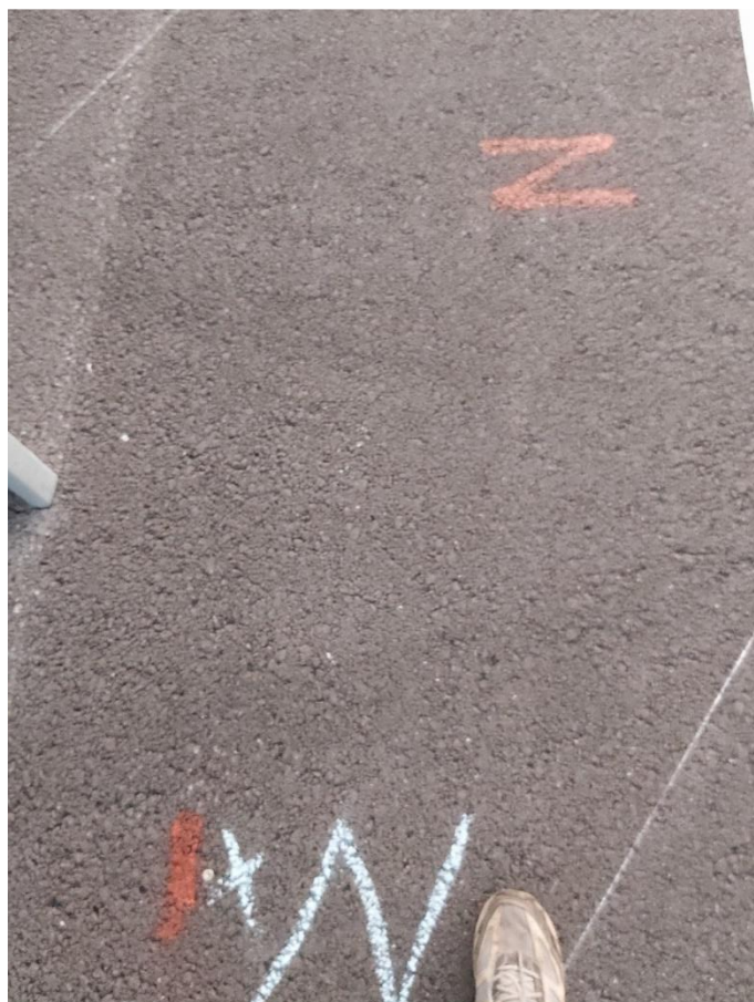
Foto 13. nivelleerimisjaamade asukohad punase markervärviga N-tähega tähistatult asfaldil
