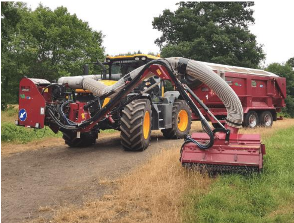
Joonis 5.1.1. UK tootja Scotts Precision Manufacturing teeservade hekseldamise ja heksli kogumise süsteem. Foto: https://www.scottssuk.com
