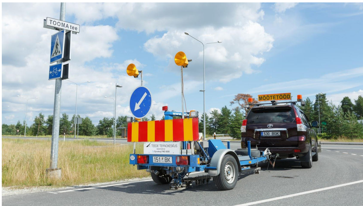
Joonis 7: Kandevõime mõõtmistel kasutatud koormusseade Dynatest FWD-8002
