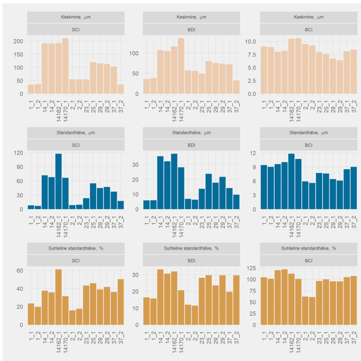
Joonis 31: Keskmine SCI, BDI ja BCI ja kogutud standardhälve FWD ja TSD mõõtmistulemuste põhjal
