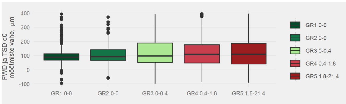
Joonis 42: TSD-ga ja FWD-ga mõõdetud d0 mõõtmistulemuste vahe ja teekatte defektide vaheline seos
