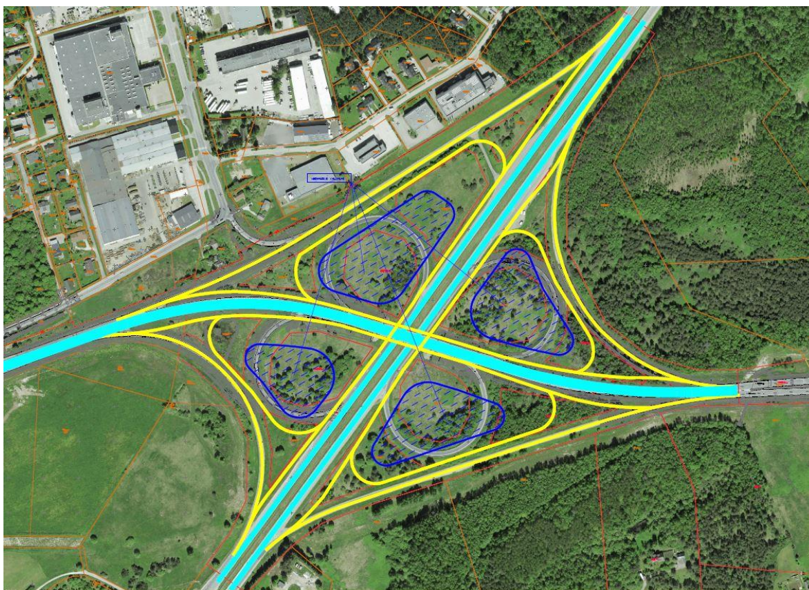
Joonis 1. Kavandatav tegevus. Väljavõte projekti eskiisjoonisest. Illustreeriv. Tumesinisega piiritletud sademevee kogumislohud. Projekt jääb samade katastriüksuste piiresse nagu olemasolev viadukt.
