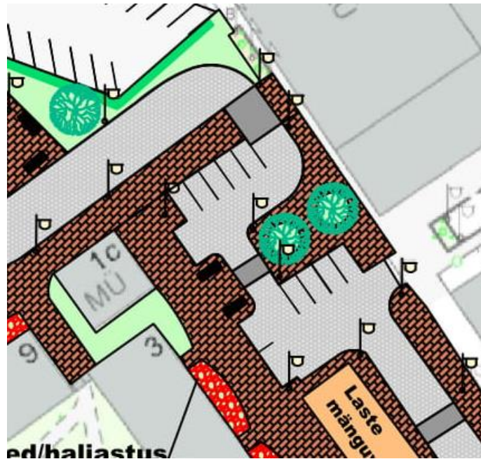
Sele 36. Suunamuutetakistustena on kasutatud tänavavalgustuse poste ja puid (väljavõte Lisast 10)
