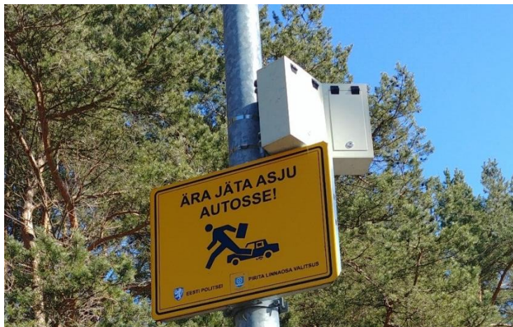
Sele 14. Mõõteseadme Viacount II paigaldatuna mõõtmiseks tänavavalgustusepostile
