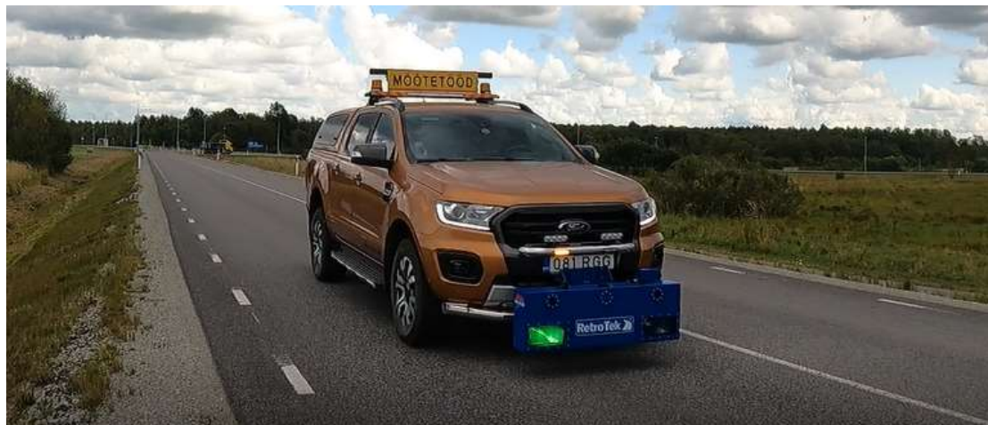
Joonis 2.1. Mõõtesõidukile paigaldatud RetroTek-D™
