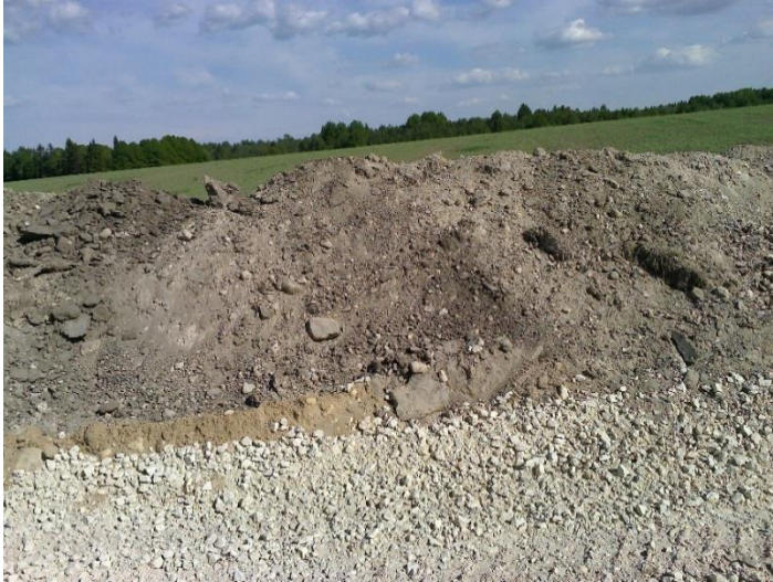
Joonis 4. Katte alt väljakaevatud külmakerget põhjustav pinnas
