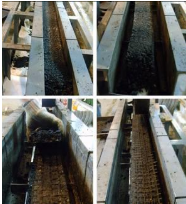
Joonis B VI.2 – Geovõrgu väljavõtmine konstruktsioonist
