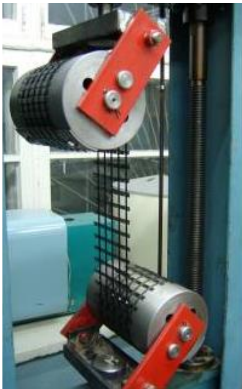
Joonis B I.1 – Geosünteesilise materjali tõmbetugevuspiiri määramine
