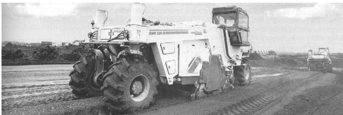
Joonis 4.5 Tsemendi laotamine segamisfreesiga Wirtgen WR 2500 SK
