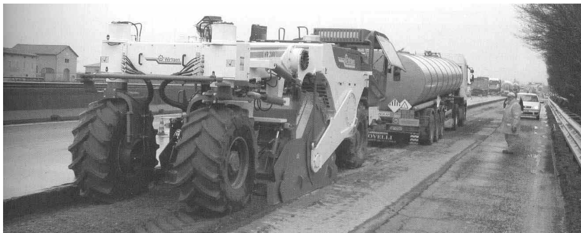
Joonis 2.6 Segamisfrees Wirtgen WR 2500 S
