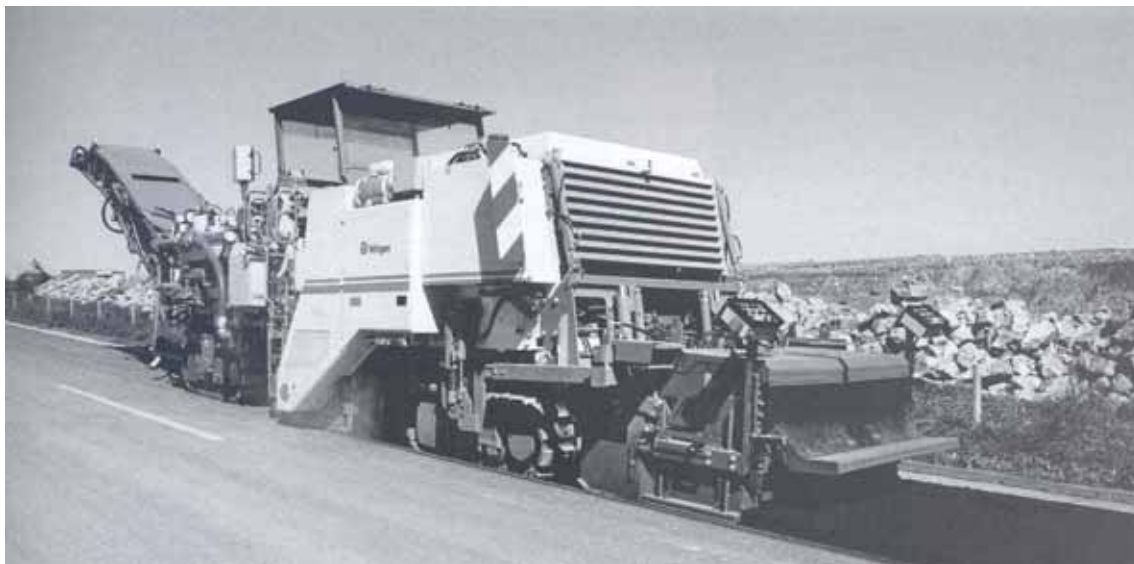
Joonis 2.8 Segamisfreees Wirtgen 2200 CR
