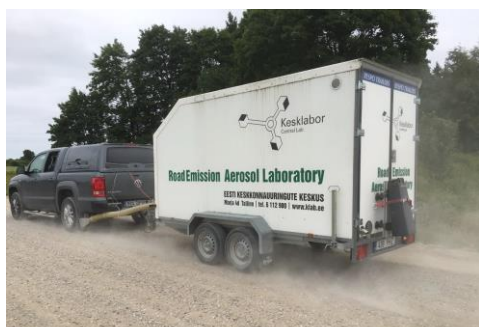
Pilt 16 ja 17. Lendtolmu mõõtmine seadmega REAL
