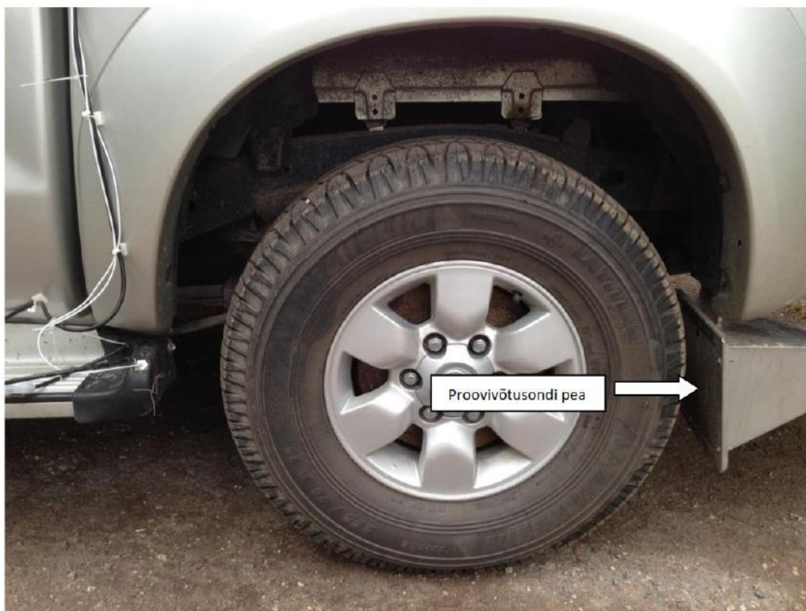
Joonis 1 Proovivõtusondi ja temperatuurianduri paigutus tagarehvi juures
