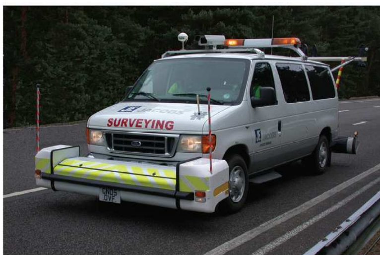
Joonis 3.6. TRACS seade teekatte seisukorra parameetrite, sh tekstuuri mõõtmiseks
