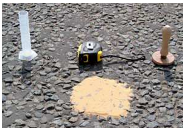
Joonis 3.6. Liivalaigukatse teekatte tekstuuri parameetrite määramiseks
