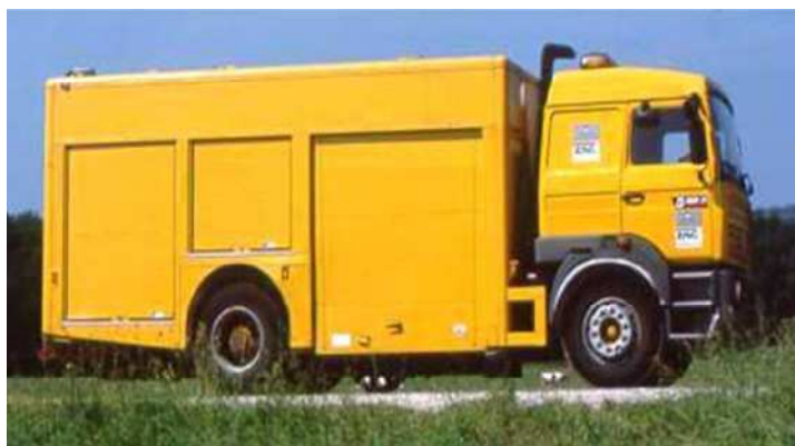
Joonis 3.3. Sloveenias kasutatav seade SCRIM, millele on lisatud teekatte tekstuuri mõõtmiseks vastav laser
