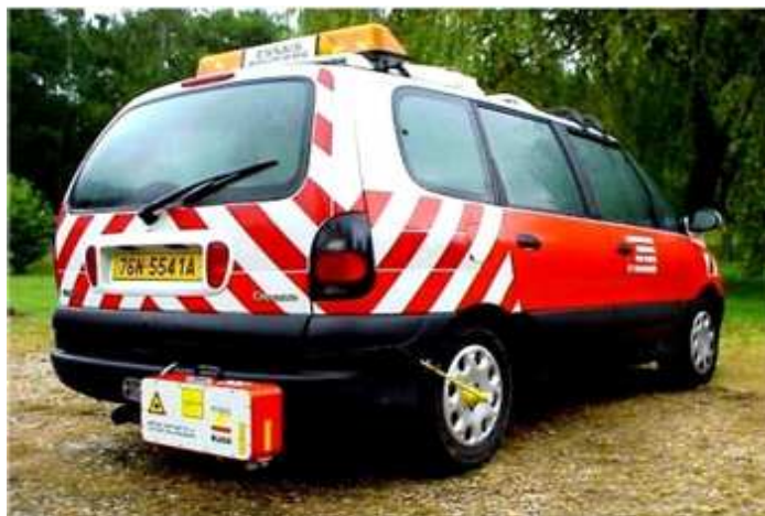
Joonis 3.5. RUGO seade teekatte tekstuuri mõõtmiseks 2
