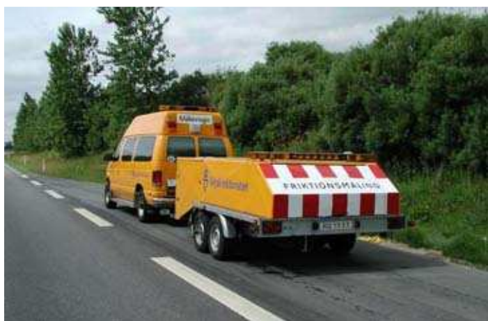
Joonis 3.9. Taanis kasutatav RoAR-seade teekatte haardeliste omaduste mõõtmiseks
