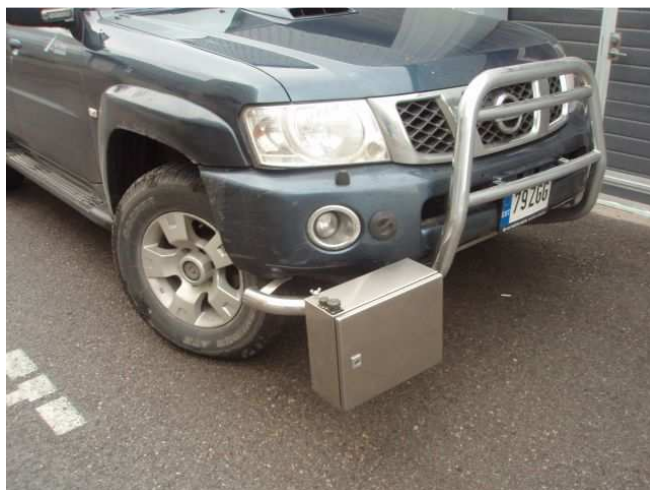
Joonis 3.11. Teekatte tekstuuri ja tasasuse mõõtmise seade Laser Texture Meter LTM-1
