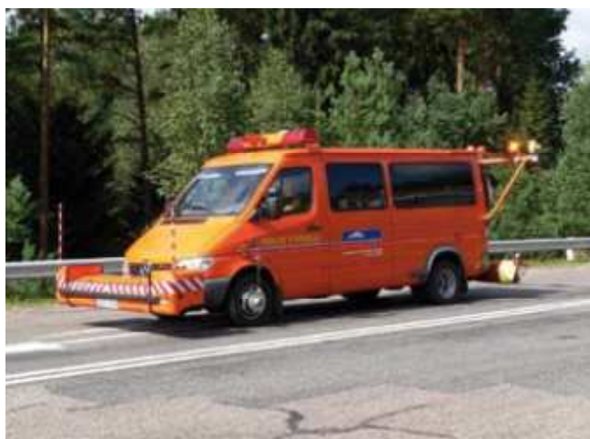
Joonis 3.2. Leedus kasutatav RST28 mõõtmisseade teekatte erinevate omaduste mõõtmiseks
