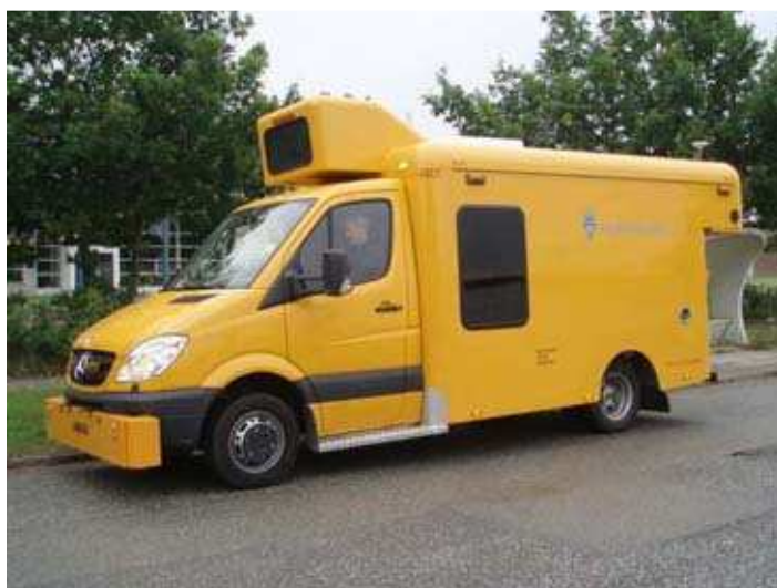
Joonis 3.8. Taanis kasutatav ARAN-seade teekatte seisukorra parameetrite mõõtmiseks
