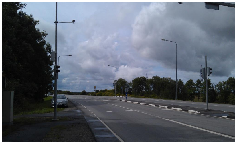
Joonis 3.3 Hüüru teekaamera tänavavalgustuse ja foori mastil
