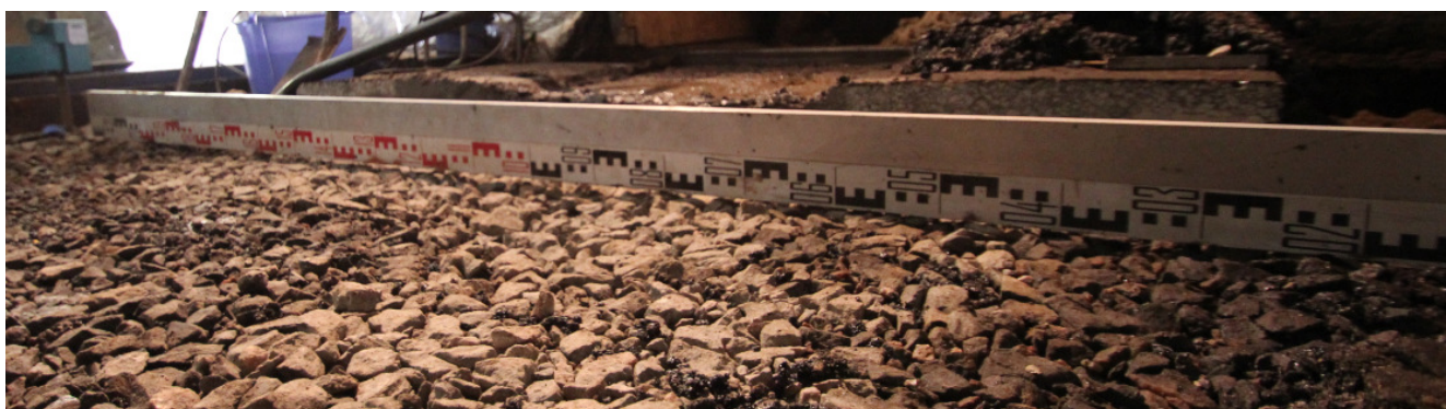
Joonis 3.60. Roopa mõõtmine killustikaluselt.
