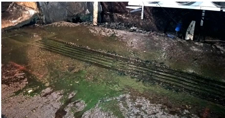
Joonis 3.37. Kattele lisatud värvitud soolvesi.
