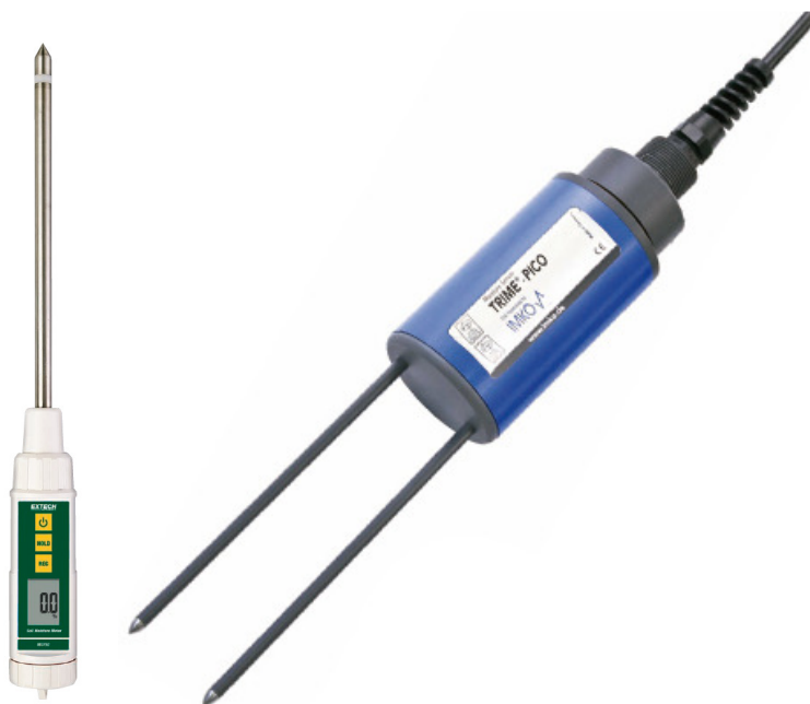
Joonised 2.5 ja 2.6. Extech M0750 [Extech] ja Trime PICO [IMCO] niiskumõõdikud.
