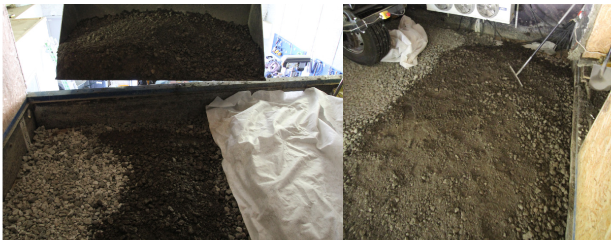
Joonised 3.11 ja 3.12. Stabiliseeritud segu tõsteti katsekasti laaduriga ning planeeriti käsitsi.
