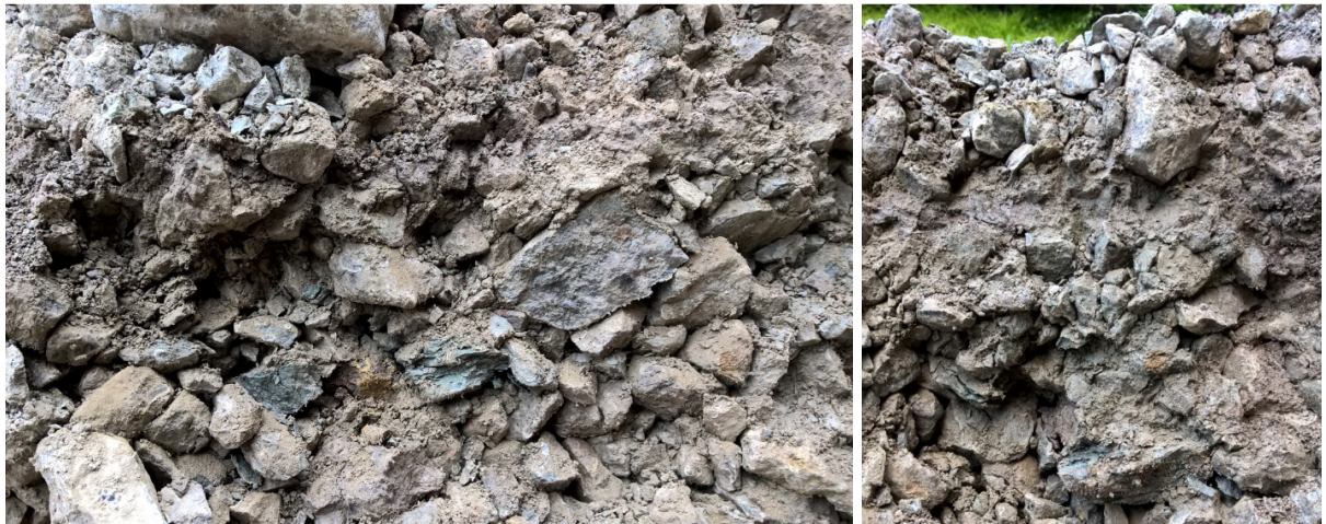
Joonised 3.73 ja 3.74. Killustik lõhenes ja murenas tugevalt.
