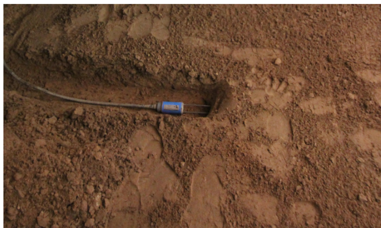
Joonis 3.22. Muldkehasse paigaldatud niiskus- ja temperatuuriandur
