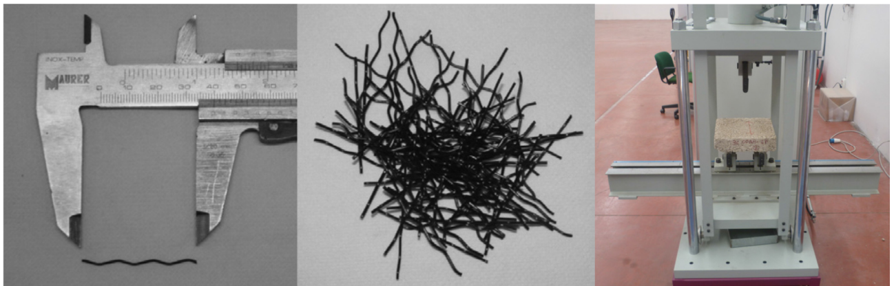
Joonised 1.12...1.14. Uuringus [19] kasutatud polümeerfiibrid ja kolme punkti testi aparaat.
