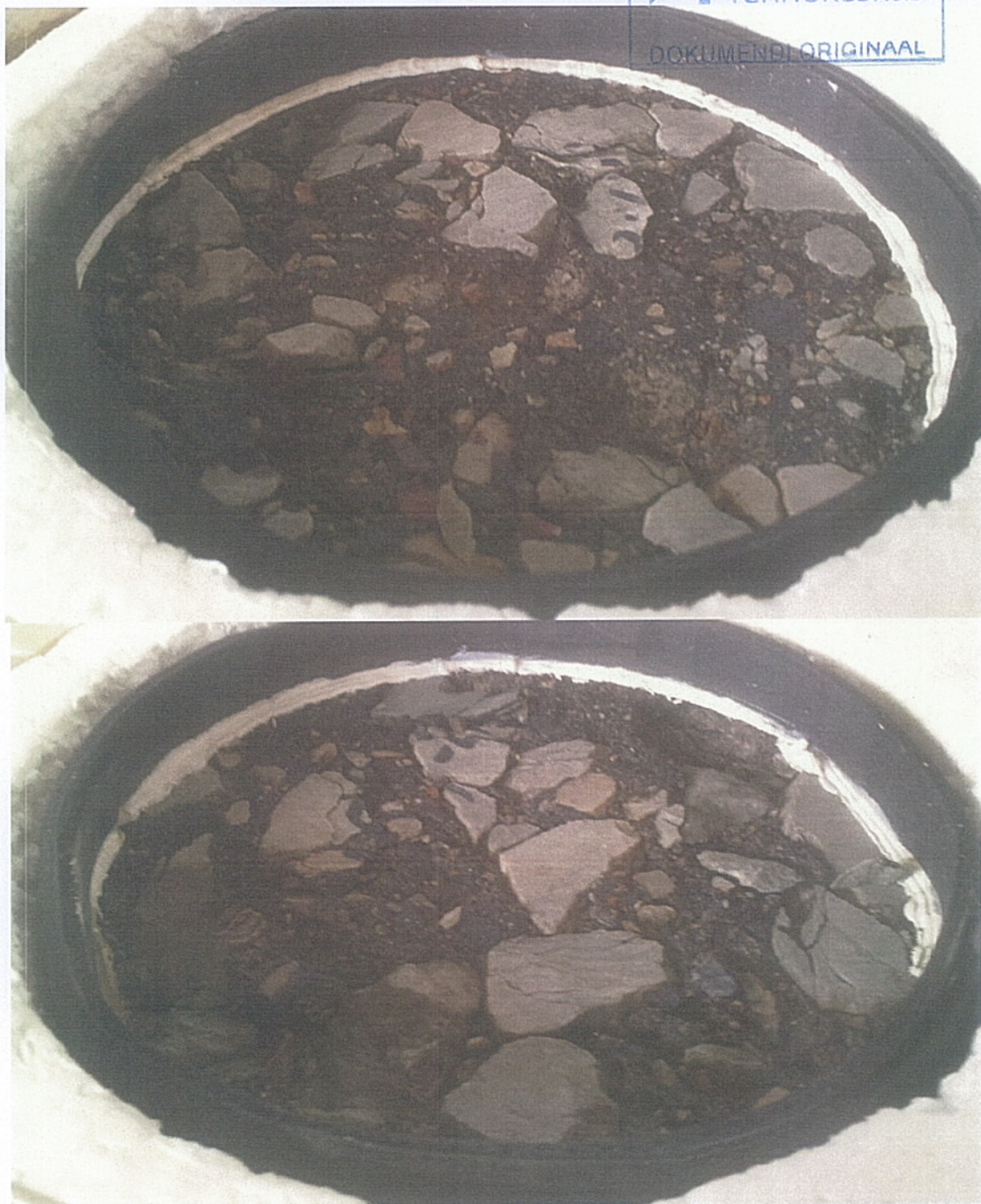
Foto 3. Külmakindluse proovikeha peale katsetust
