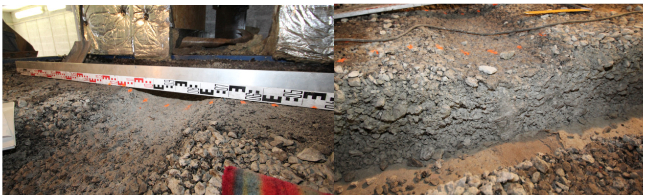
Joonised 3.79 ja 3.80. Uuringust [30] pärit fotod seoses sellega, kuidas killustikalus koormamise käigus on purunenud. Selle all olnud liiv oli täiesti deformeerumata.
