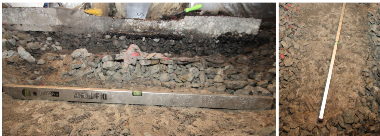
Joonised 3.81 ja 3.82. Roopa mõõtmine killustikkihi all olnud drenliivalt
