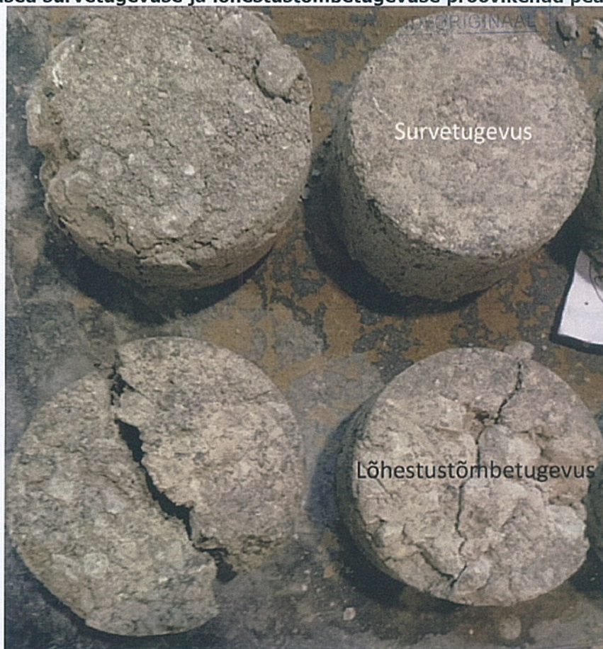
Foto 2. Veekindluse proovikehad peale katsetust
