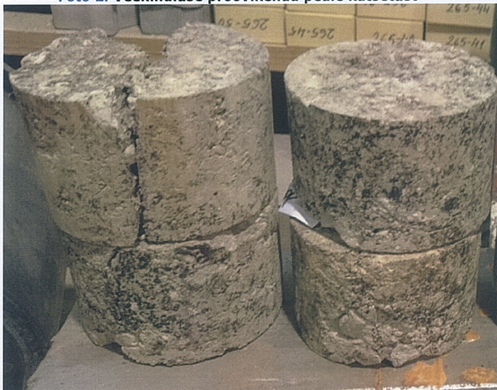
Foto 2. Veekindluse proovikehad peale katsetust
