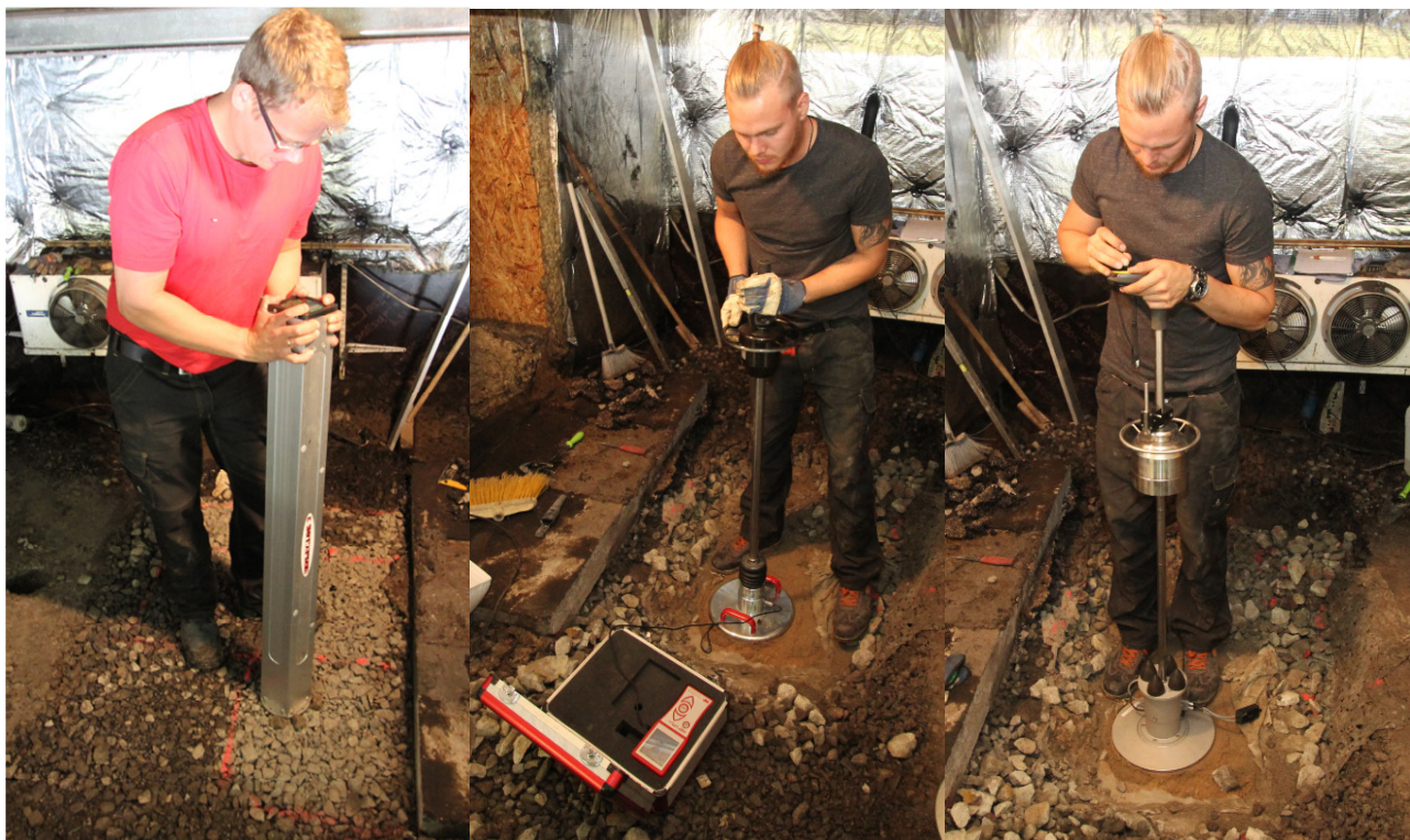
Joonised 3.83 ... 3.85. Kandevoimemõõtmised Inspector III, Saksa HMP ja Taani PRIMA 100-ga.
