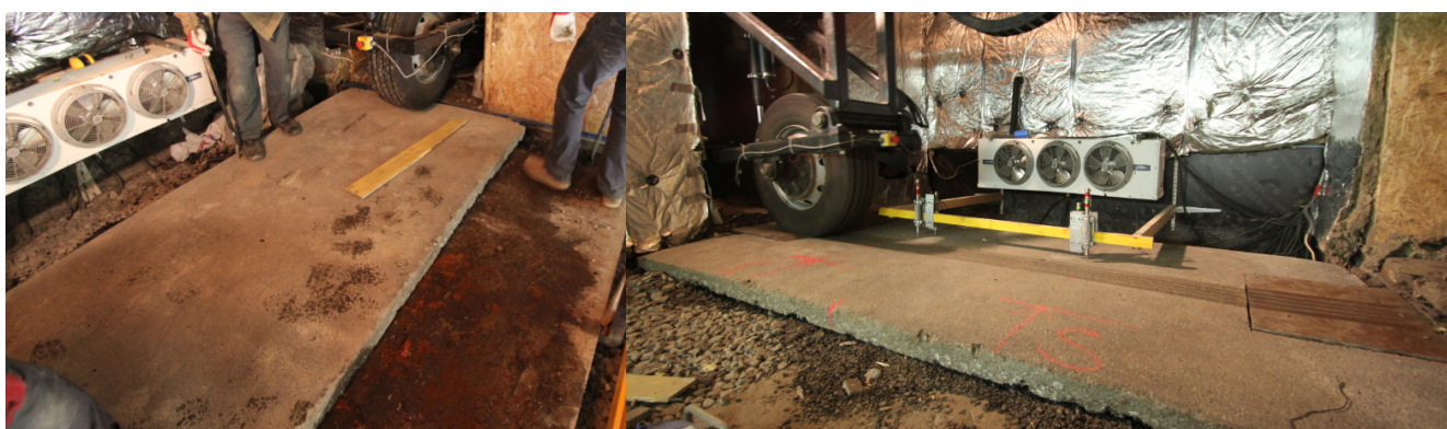
Joonised 3.4 ja 3.5. Plaat saadi edukalt paika ning näha on olukord, millest alates loeti katse alganuks.
