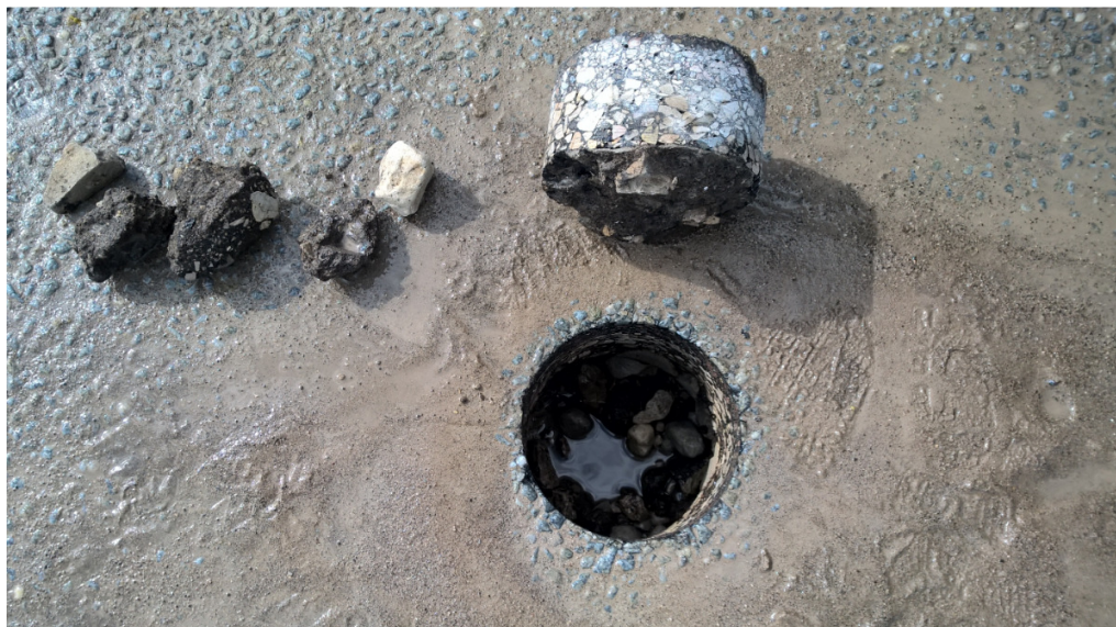
Joonis 2.13. Asfaltbetoon ja stabiliseeritud kiht olid nakkunud omavahel väga hästi, kuid puurimisel viimane lagunes. Koos veega tuli puuraugust välja väga palju liiva.
