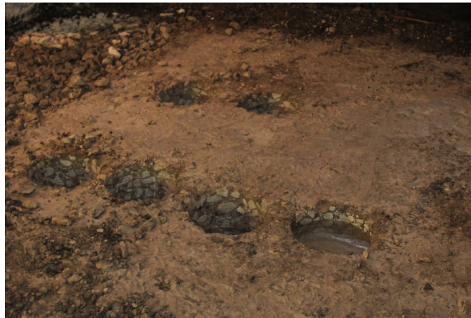
Joonis 3.55. Stabiliseeritud kihist puuritud proovikehad – kaks sõidujäljest ja neli sellest eemal
