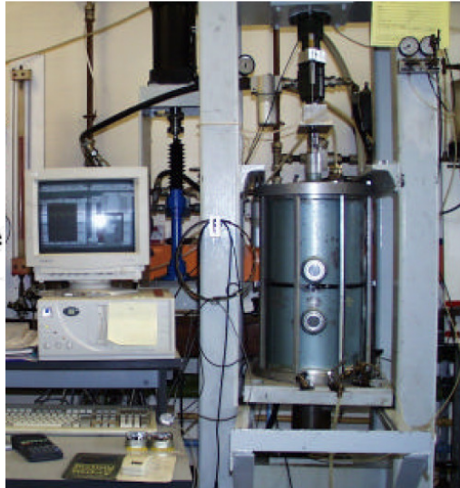
Joonis 4.9 ja 4.10. Deviaatorpingete illustratiivne joonis ja selle määramise aparaat [55]
