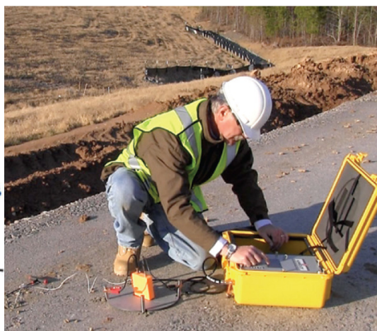
Joonised 2.7 ja 2.8. Radioaktiivse isotoobiga mõõteseadet [Troxler] ja elektriline tihedusemõõtja [Humboldt]
