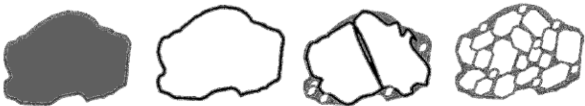
Joonis 1.11. Asfaldipuru probleemid - me ei tea, mis musta kihi all on.
