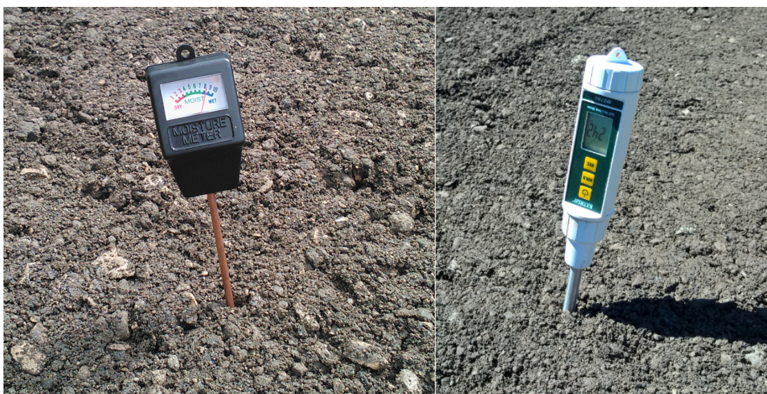
Joonised 2.3 ja 2.4 „Aedniku“ niiskussvarras ja professionaalne niiskumõõdik.
