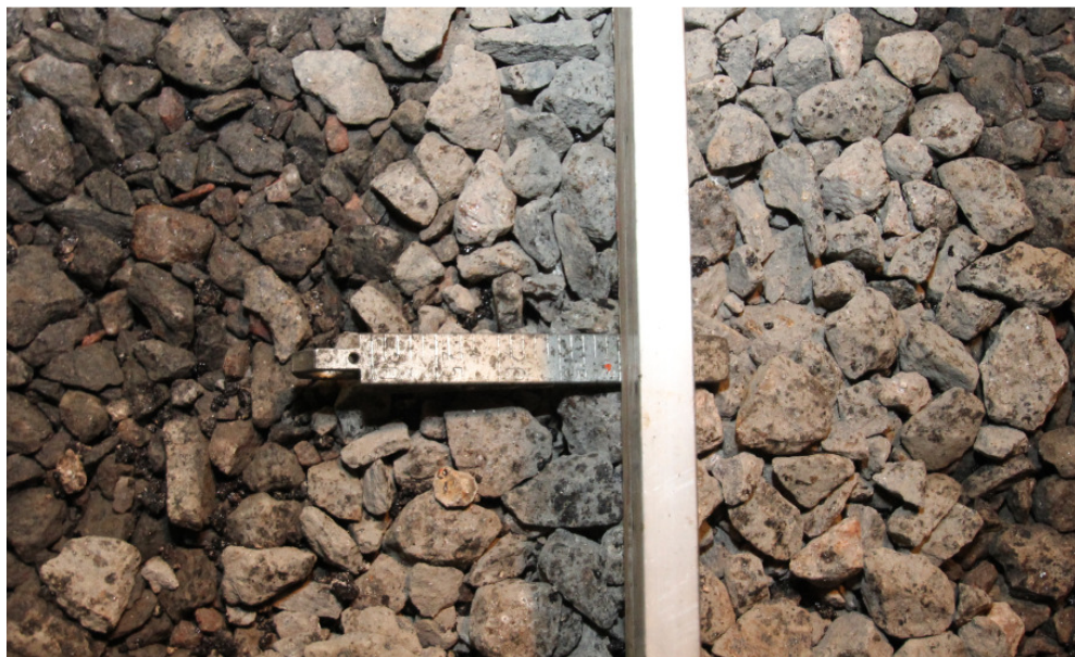
Joonis 3.61. Roopa mõõtmise killustikaluselt, mõõtetulemus oli täpselt 10 mm.
