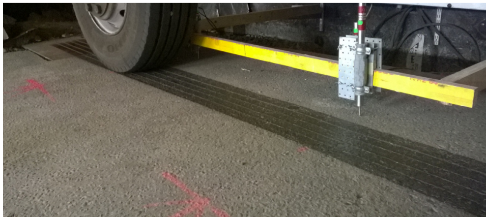
Joonis 3.34. Olukord peale 120'000 koormustsükli läbimist. Kattes roobast sees pole, kuid killustiku sektsioon on võrreldes stabiliseeritud sektsiooniga vajunud kergelt allapoole.
