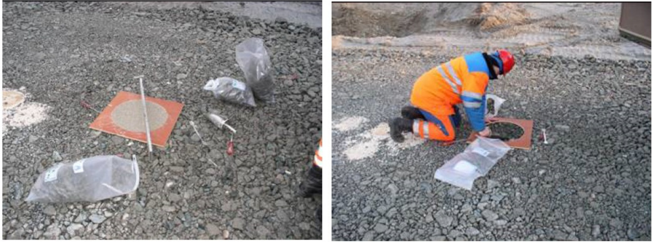
Joonis 2.9 Tihedusemõõtmine liivakoonuse meetodil.
