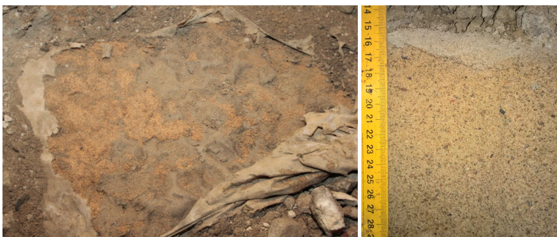
Joonised 3.95 ja 3.96. Dreenliiva peale ehk killustikaluse alla oli paekivist settinud tolmu.
