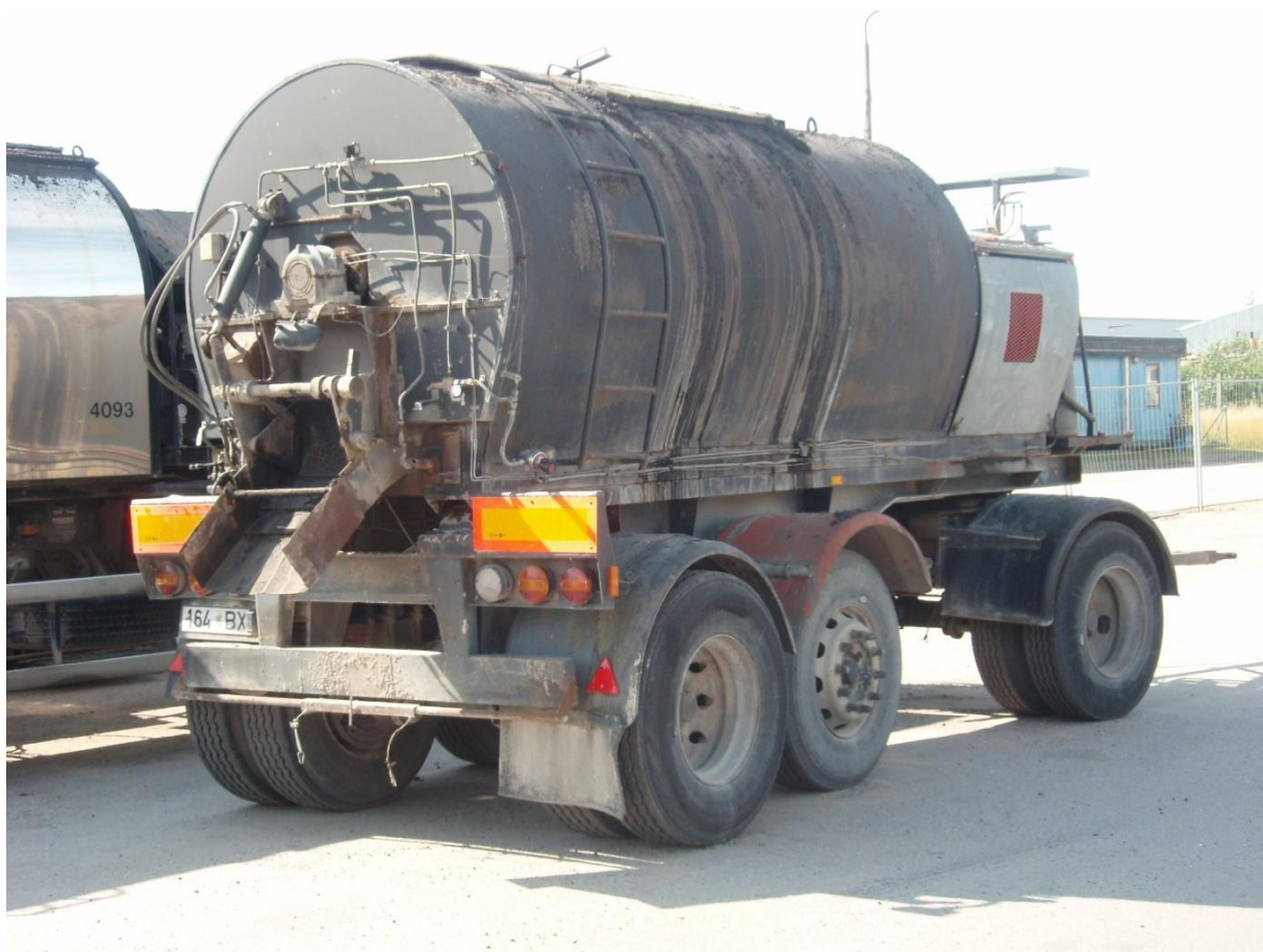
Foto 12 – Lõplik mastiks- ja valuasfaldi segamine toimub transporditavas segukatlas
