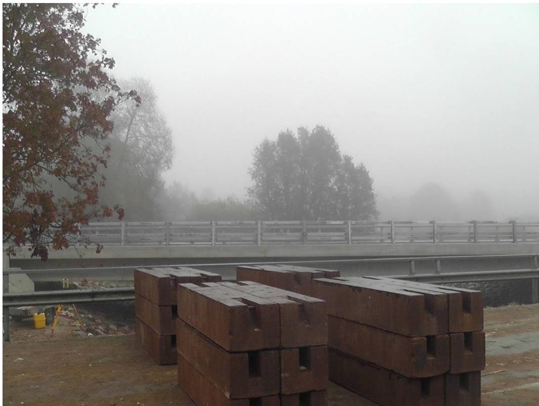
Joonis 12. Koormusskeem N-30 silla äärmisel aval.
