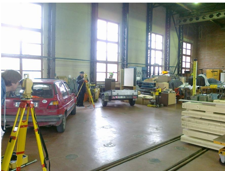
Joonis 3. Invarlati ja ümarvesiloodi telgede paralleelsuse kontroll ja justeerimine kahe elektron-tahhümeetriga
