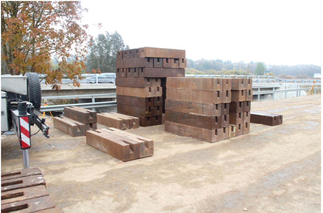
Joonis 24. Koormusmudeli KM1 modelleerimine Säreveere silla esimesel aval
