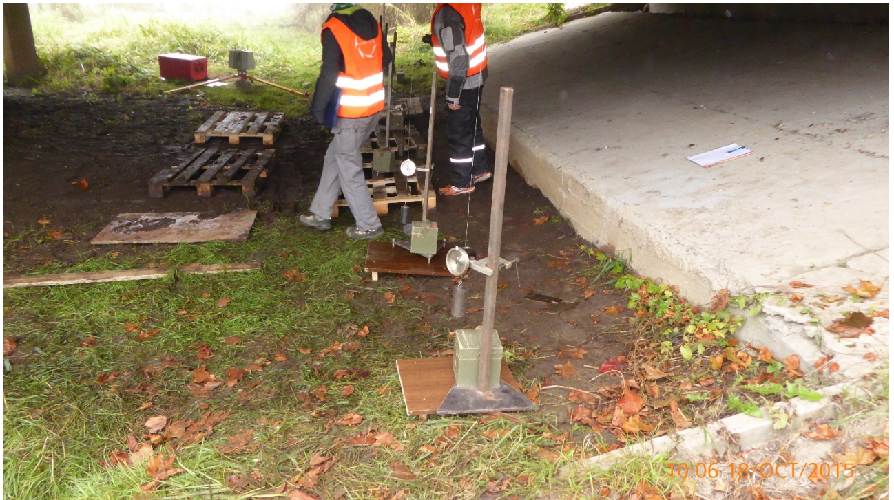
Joonis 26. Särevere silla esimese ava talade keskkoha kinnitati Maksimovi tüüpi lõpmata käiguga mõõtkellad.
