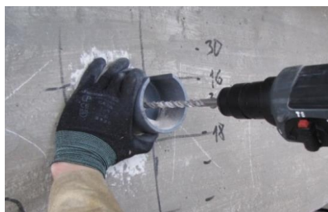
Foto 27. Kloriidide sisalduse määramiseks vajaliku betoonipulbri kogumine
