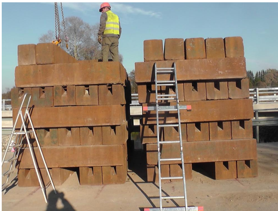
Joonis 11. Täiskoormuse (288t) paigutus keskmise ava koormuskatsetusel. Koormusena kasutatud metallraskuste (mõõtmed 2m x 0.4m x 0.35m) virna kogukõrguseks kujunes 2.80 m (+ lisaraskused virna otsas), laiuseks 4.0 m, kogupikkus 4,45 m. Vaade sillalt.
