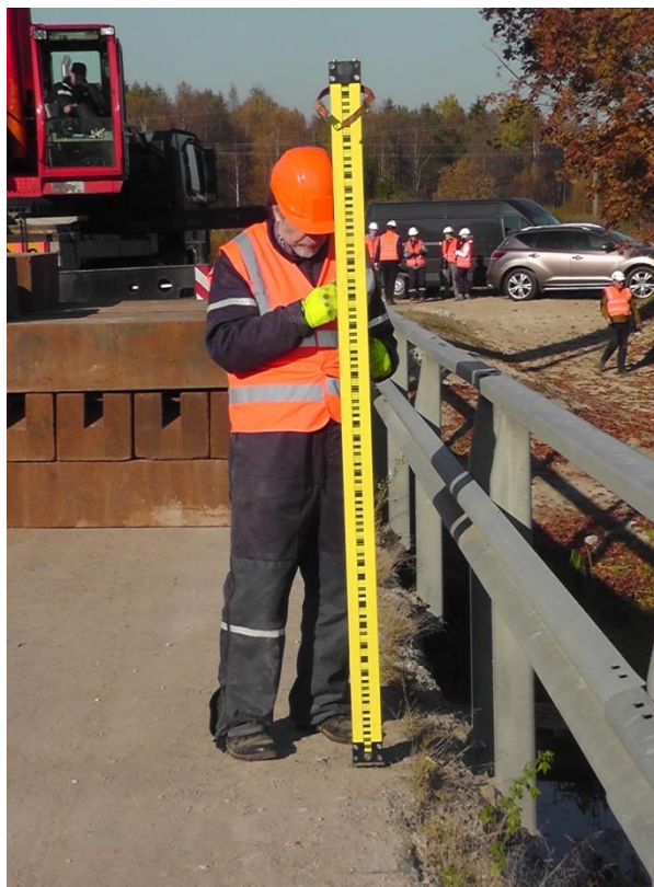
Joonis 2. Nivelleerimisel kasutatud 2 m pikkune invarribaga koodlatt LD12.
