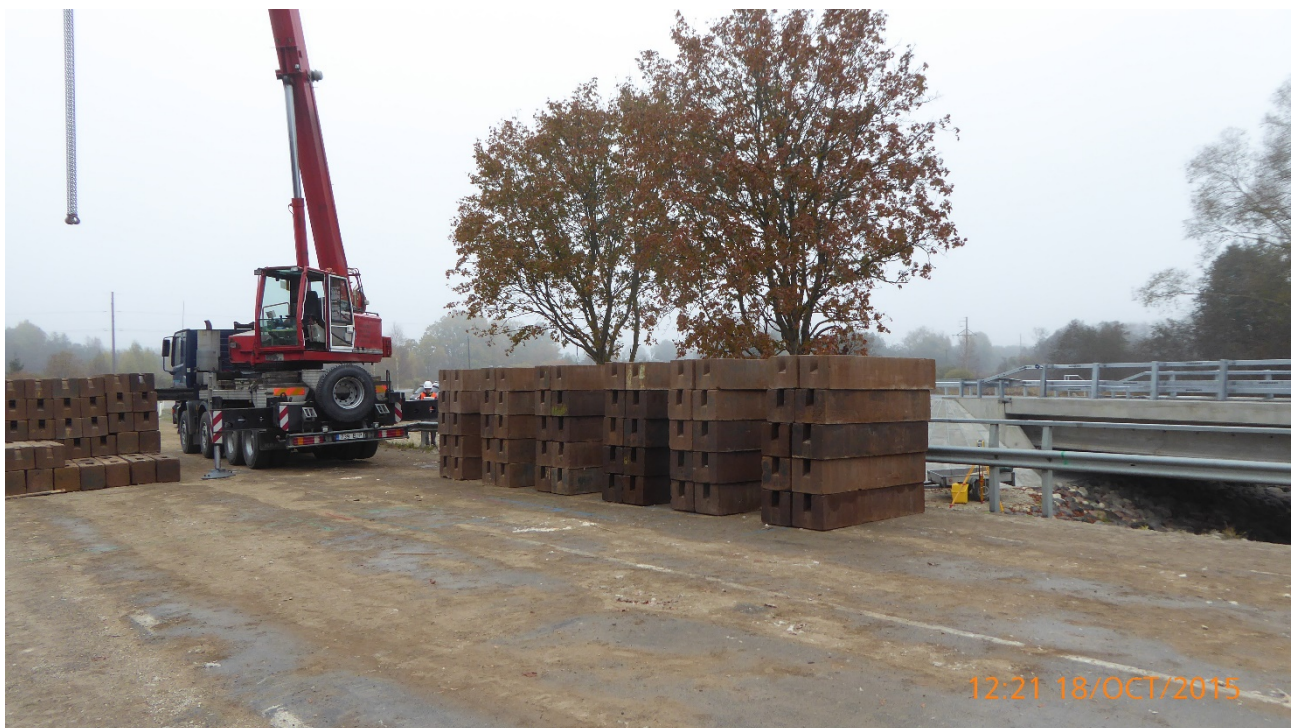
Joonis 22. Eriveoki koormus , 6 telge a'20t Särevere silla esimesel aval
