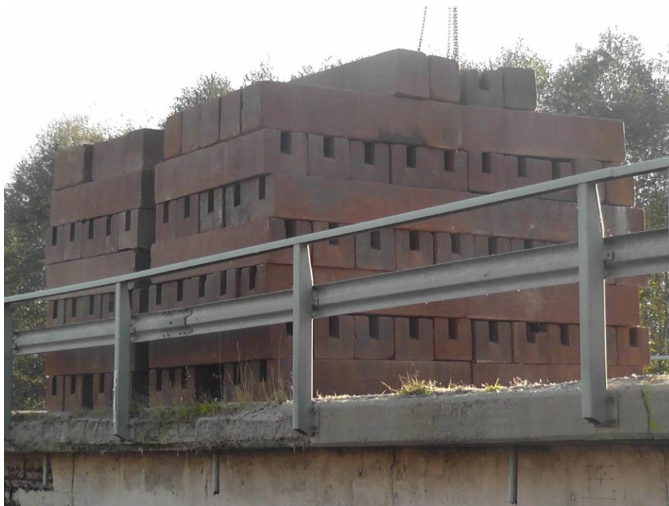
Joonis 10. Täiskoormuse (288t) paigutus keskmise ava koormuskatsetusel. Koormusena kasutatud metallraskuste (mõõtmed 2m x 0.4m x 0.35m) virna kogukõrguseks kujunes 2.80 m (+ lisaraskused virna otsas), laiuseks 4.0 m, kogupikkus 4,45 m. Vaade silla küljelt.
