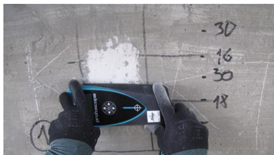
Foto 22. Terasarmatuuri paiknemine ja betoonist kaitsekihi mõõtmine seadmega Proceq Profoscope+
