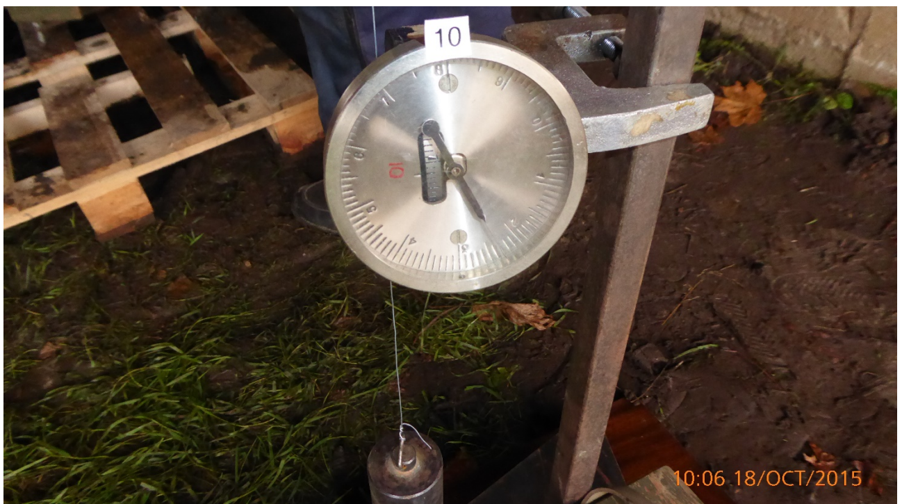
Joonis 26. Särevere silla esimese ava talade keskkoha kinnitati Maksimovi tüüpi lõpmata käiguga mõõtkellad.
