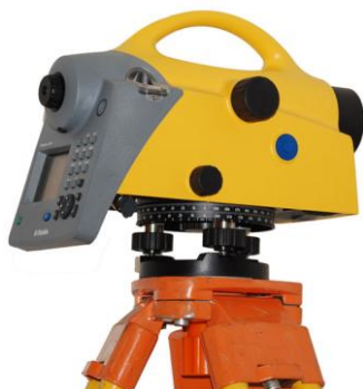
Joonis 1. Nivelleerimisel kasutatud kõrgtäpne digitaalnivelliir Trimble DiNi03
