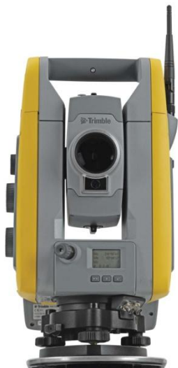
Joonis 15. Sillamõõtmistel kasutatud laser-tahhümeeter Trimble S6
