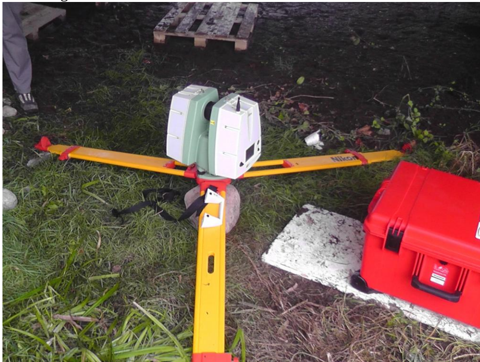
Joonis 27. Skaneerimisjaam äärmise ava all.
