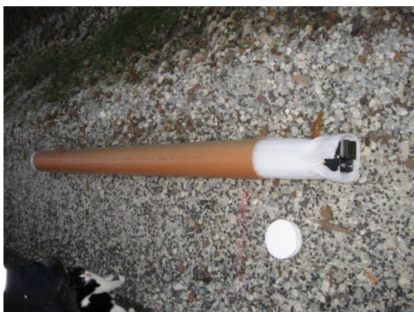
Joonis 4. Plastikust transporditaara, millesse sisestamisel invarlatid ka polsterdati
