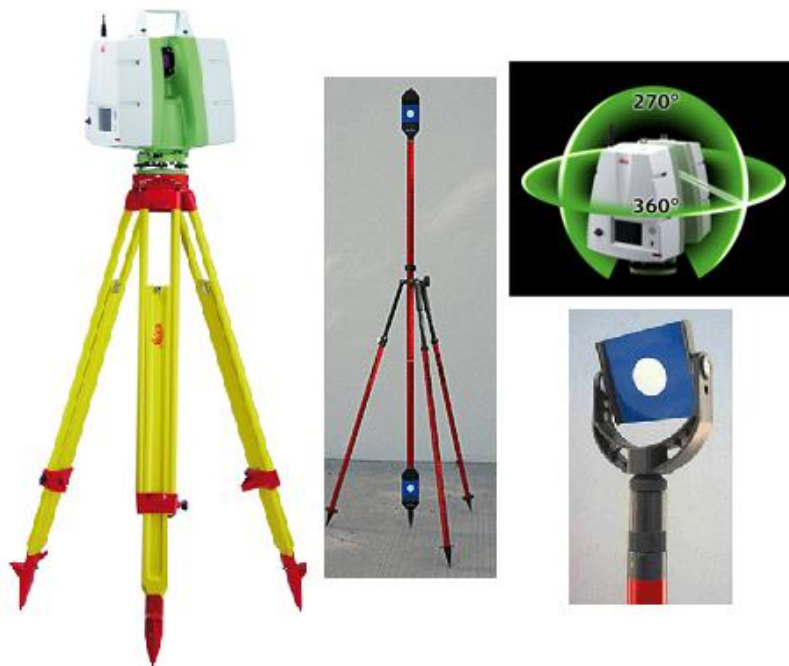
Joonis 23. Laserskanner, tähised ning mõõtmisulatus
