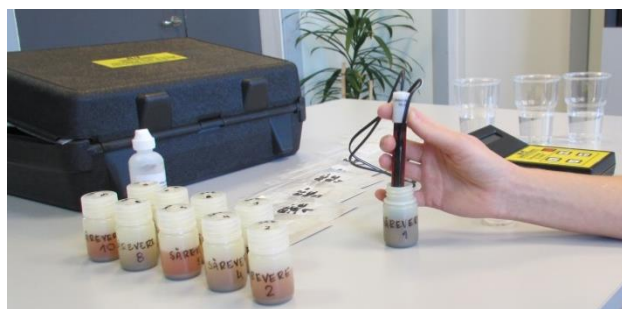
Foto 28. Betooni kloriidide sisalduse määramine seadmega C-CL-3000 Chloride Test System
