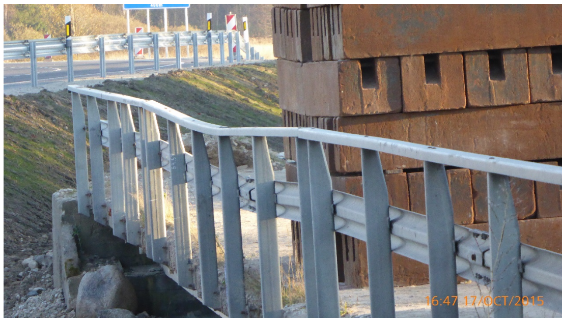
Joonis 19. Säreveere silla keskmise ava koormamine HK-80 mudeli kohaselt, kogukaal 288 t. Pärast koormuse eemaldamist jäi talale jääv deformatsioon suurusega 35 mm
