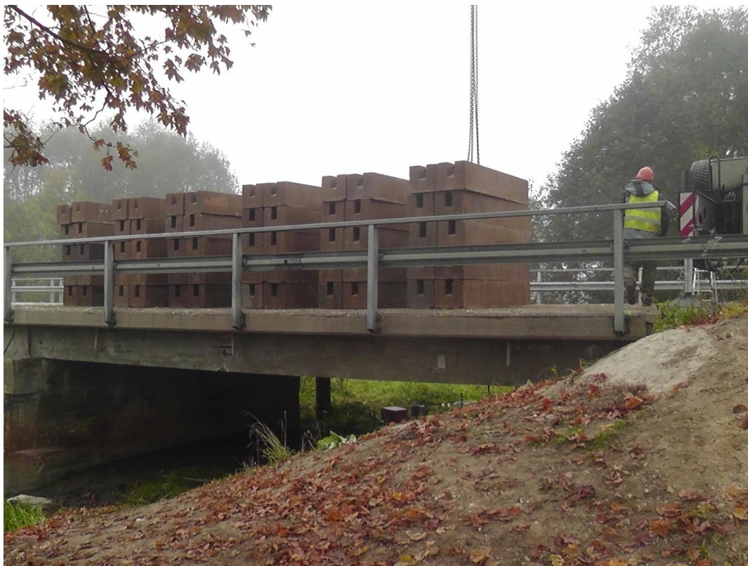
Joonis 13. Koormuskeem KM-3 silla äärmisel aval.
