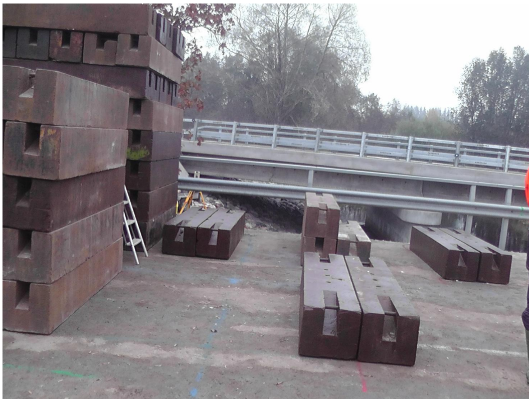
Joonis 14. Koormuskeemi KM-1 lõunapoolne osa
