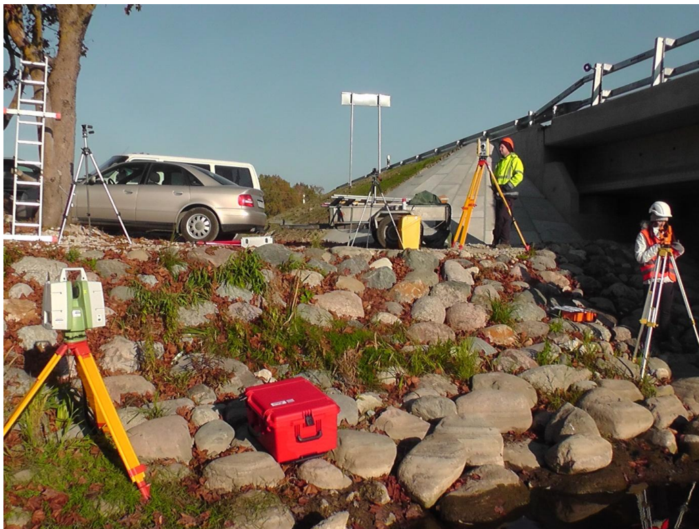
Joonis 16. Tahhümeeter Trimble S6 ning terrestriline laserskanner silla idaküljel keskmise ava katsetusel
