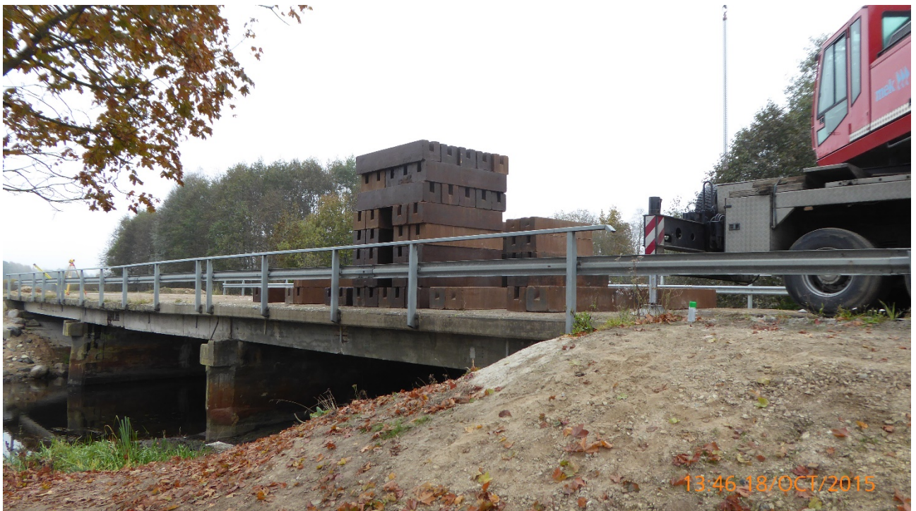
Joonis 25. Koormusmudeli KM1 modelleerimine Säreveere silla esimesel aval
