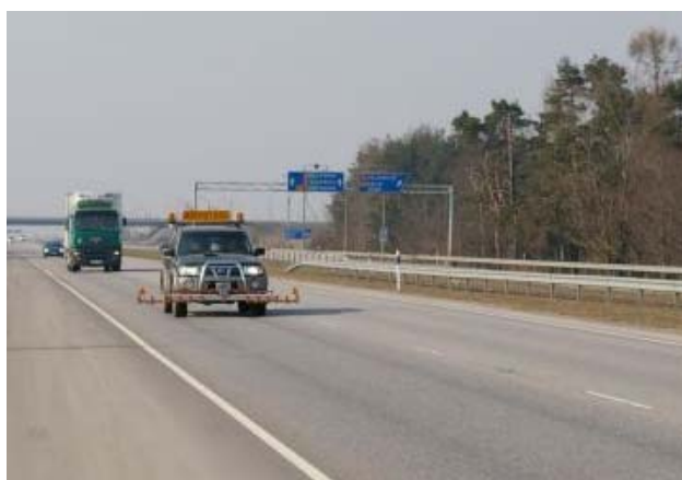
Foto 2. Roopa sügavuse mõõtmine roopa sügavuse mõõtmise seadmega
