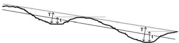
Joonis 7. Roopa sügavuse mõõtmise põhimõte
