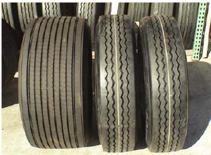
Foto 6. Rehvide võrdlus - 445/50R22,5 vs 2*275/80R22,5; foto allikas: Auburni Ülikooli uurimistöö 2005
