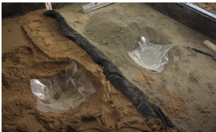
Foto 17. Infiltratsioonikatse ettevalmistus tihendatud materjali pinnal. Autor Sven Sillamäe
