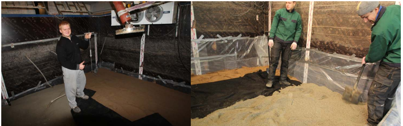
Fotod 13 ja 14. Tihedust kvartslüivas kontrolliti ka penetromeetriga. Katseseadme põhjas on hüdroisolatsiooniks kile. Autor Sven Sillamäe
