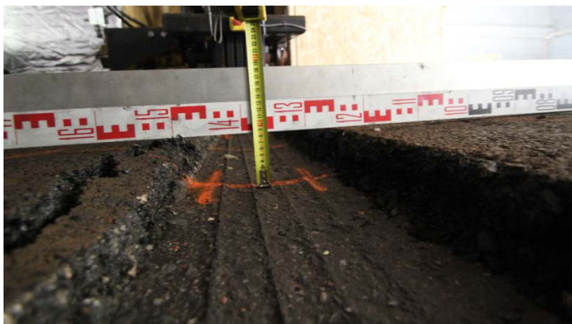
Foto 26. Makimaalne roobas pärast katse lõppu oli 87mm. Autor Sven Sillamäe
