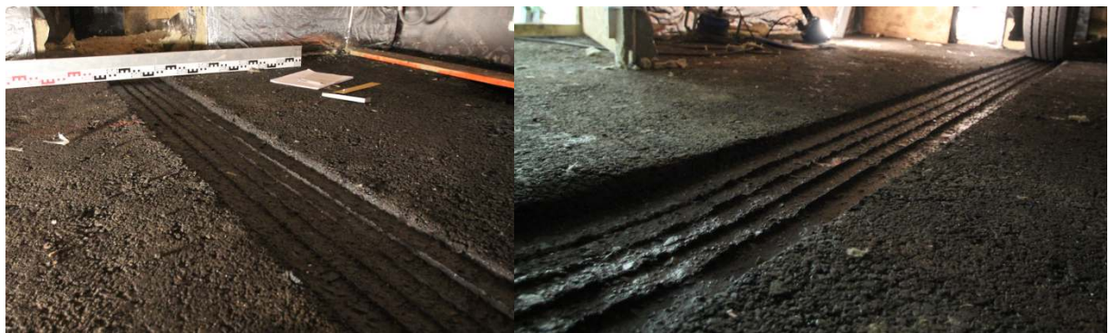
Fotod 27 ja 28. Olukord enne külmutamisega alustamist ehk peale ca 200000 tsükli läbimist, kuupäevaks 6. mai. Autor Sven Sillamäe
