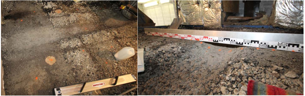
Fotod 32 ja 33. Killustiku pinda tekkinud roobas. Paremal pool on 4...32, keskel 16/32 ja vasakul 0...32. Pane tähele, kuidas peenosid on liikunud 0...32 peal 16/32 peale. Autor Sven Sillamäe
