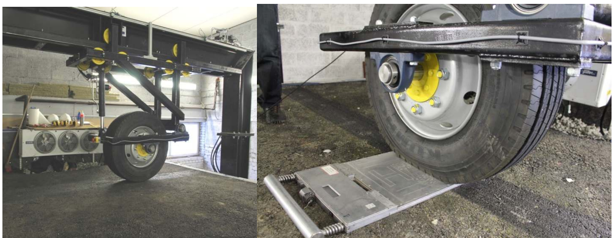
Fotod 5 ja 6. Esimesed fotod pärast ratta valmimist. Katseseadme kalibreerimine. Autor Sven Sillamäe
