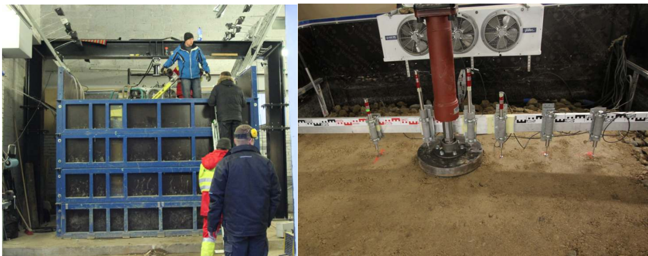
Fotod 1 ja 2. Katseseadme kast ja dünaamiline koormusplaat. Autor Sven Sillamäe
