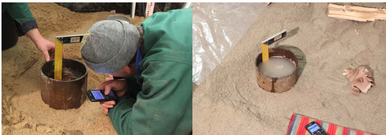
Fotod 18 ja 19. Infiltreerimiskatse ühe silindriga. Autor Sven Sillamäe
