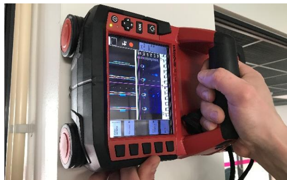
Foto 50. Terasarmatuuri paiknemise, betoonist kaitsekihi ja terasarmatuuri läbimõõdu määramine seadmega Hilti PS 1000 X-Scan
