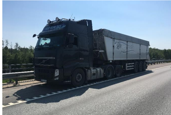
Foto 2. Jõgisoo II silla (keskmise ava) katsetamine
