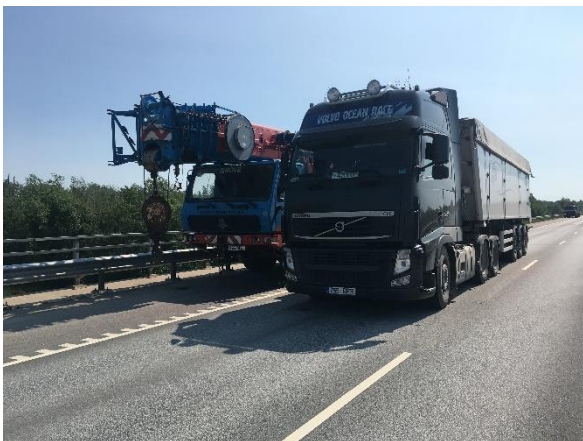
Foto 5. Jõgisoo II silla (keskmise ava) katsetamine
