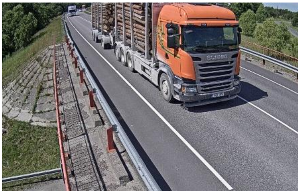
Foto 72. 2018. a Sanga viaduktil iBWIM mõõtmiste käigus fikseeritud veok tegeliku massiga 82,8 t (sisaldab ka dünaamikategurit)
