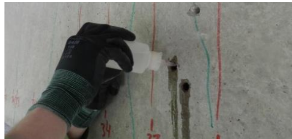
Foto 48. Karboniseerumissügavuse määramine fenoolftaleiini 1% lahusega
