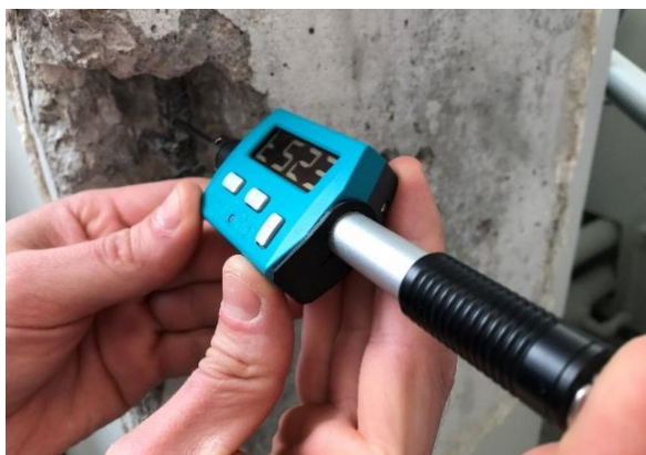
Foto 51. Terasetõmbetugevuse mõõtmine seadmega Proceq Equotip Piccolo 2
