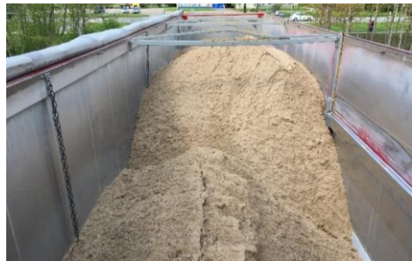
Foto 73. 55 t tegeliku massiga veok Türi-Alliku silla katsetamisel, mille poolhaagis oli pooltühi
