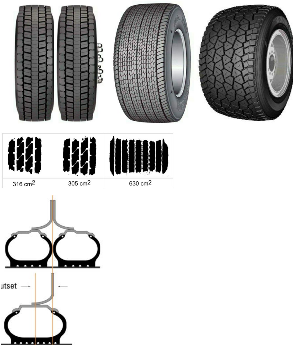
Joonis 31. Paariratas ja uued üksikrehvid (Michelin 445mm ja Goodyear 495mm) ja rattajäljed ehk veoki toetuspinna suurus (D. Grellet, j-P Bilodeau 2012). Alumisel kujutisel on näha 125 mm telje muutust sõiduraja serva poole uute üksikrehvide puhul.
