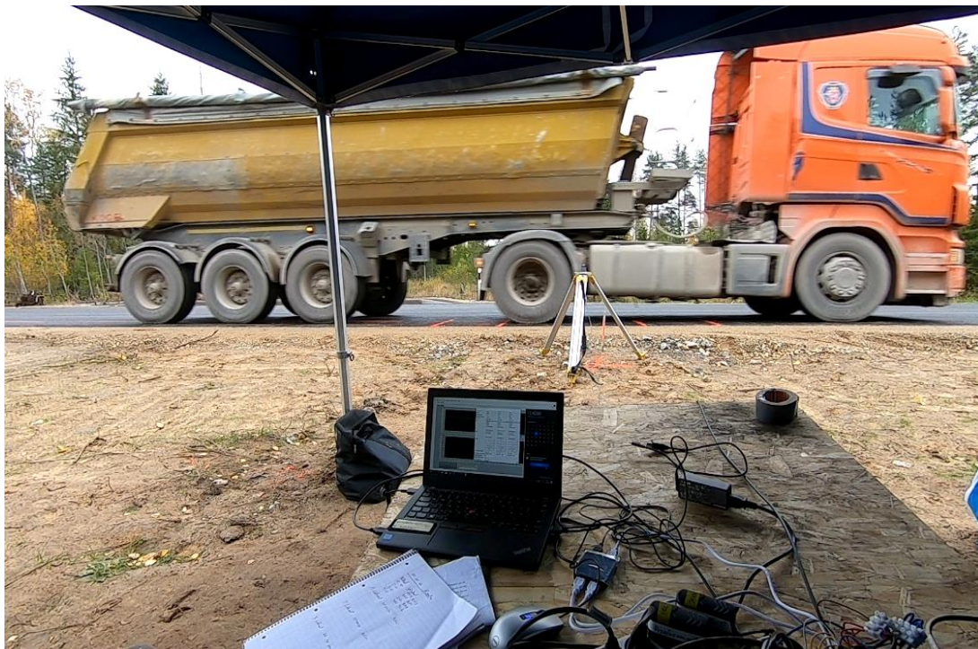
Joonis 17. 40t etalonveoki möödumine ja T35 km 7,5 mõõtepunkt töö.
