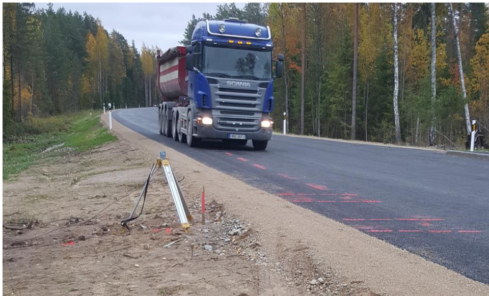
Joonis 22. Teekattele oli märgitud välimise ratta soovitatav trajektoor ning ruudilippudega oli tähistatud vajumisandurite asukohad. Statiivil on laser ja lähenemas 6 teljeline 44 tonnine veok.
