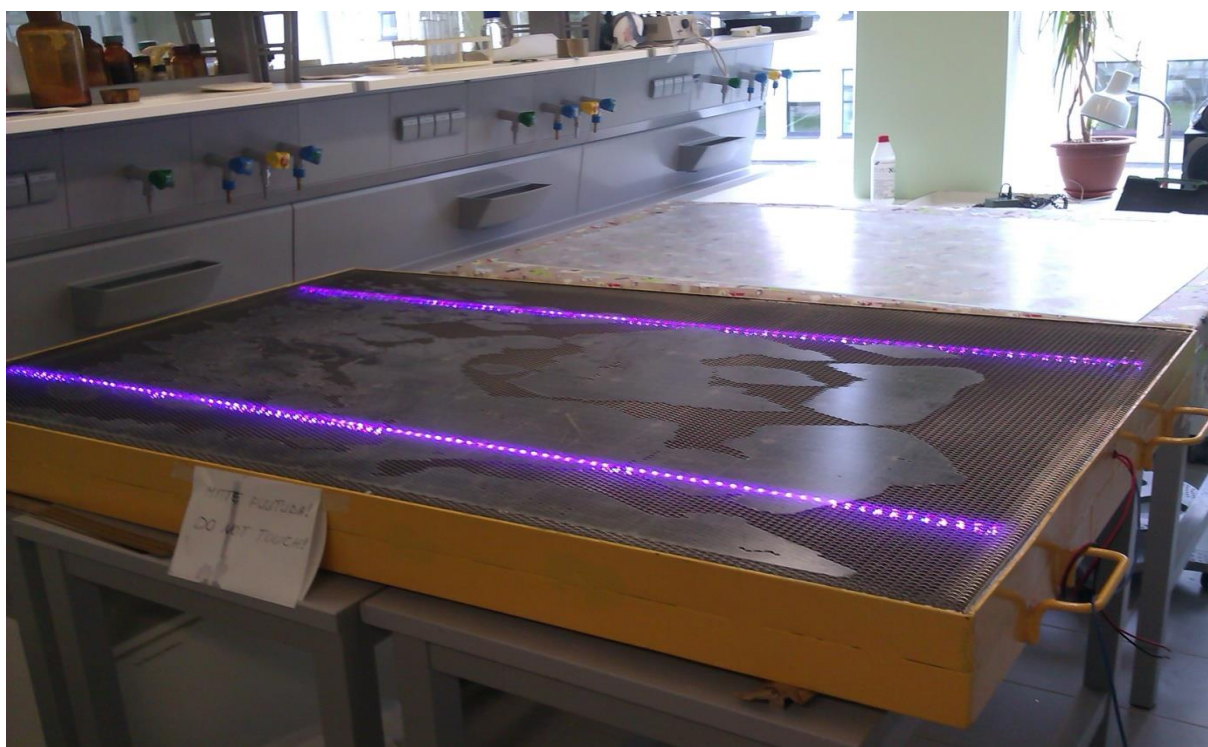
Joonis 3.21 48 tunni möödudes oli võimalik raskused ning klaas eemaldada. Selgus, et pind oli ebaühtlane ning katend vajab täiendavat pinnatöötlust
