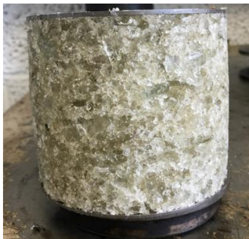
Joonis 2.61 Eksperimentaalse segu tihendatud proovikeha
