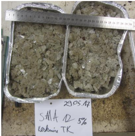
Joonis 2.43 SMA 12 terakoostisele vastav segu – tulemus on visuaalselt liiga tume ning täitematerjal väga plaatjas
