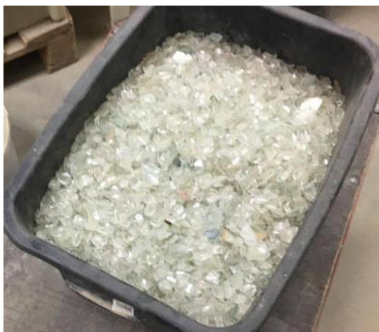
Joonis 2.41 Klaasitehase juurde kuulunud taaskasutusliinist saadud klaasipuru
