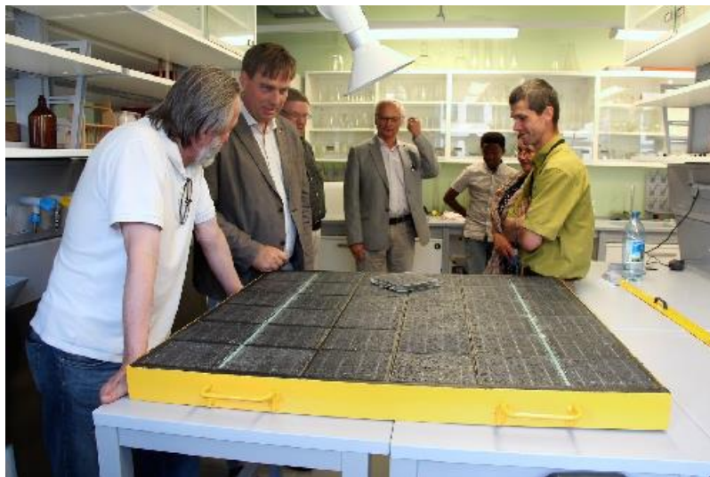
Joonis 3.3 Valmis e-katendi elementidest e-kõnnitee lõik. Elemendid on üksteisega ühendatud silikooniga, mis tagab kogu elektriühenduste veekindluse.
