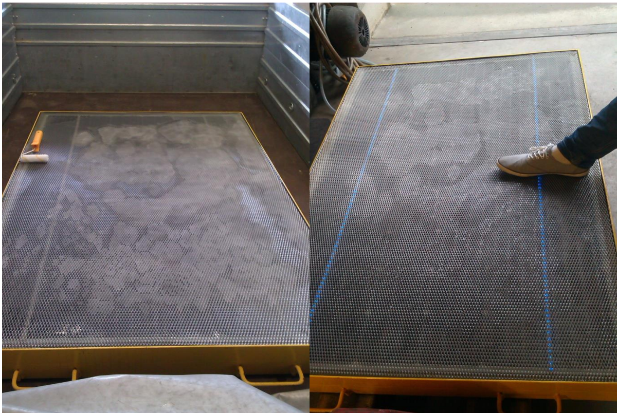
Joonis 3.23 Et maha lihvitud kõrgemad kohad jäid ülejäänud pinnast tunduvalt tuhmimad, kanti pinnale täiendav õhuke kiht EPO-t andes ühtlasema tulemuse
