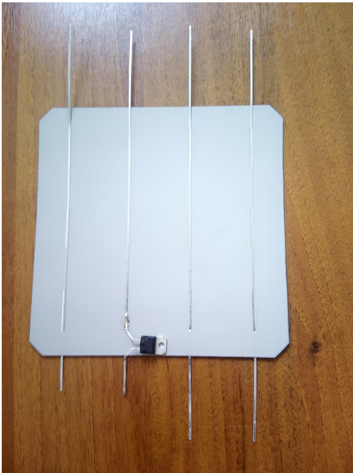
Joonis 2.20 Päikeseelemendi tagumine pool koos joodetud "bypass" diodiga. Sellisel kujul läheb see element mõlemalt poolt polümeeriga katmisele ja nii saadakse nn e-sillutisekivi
