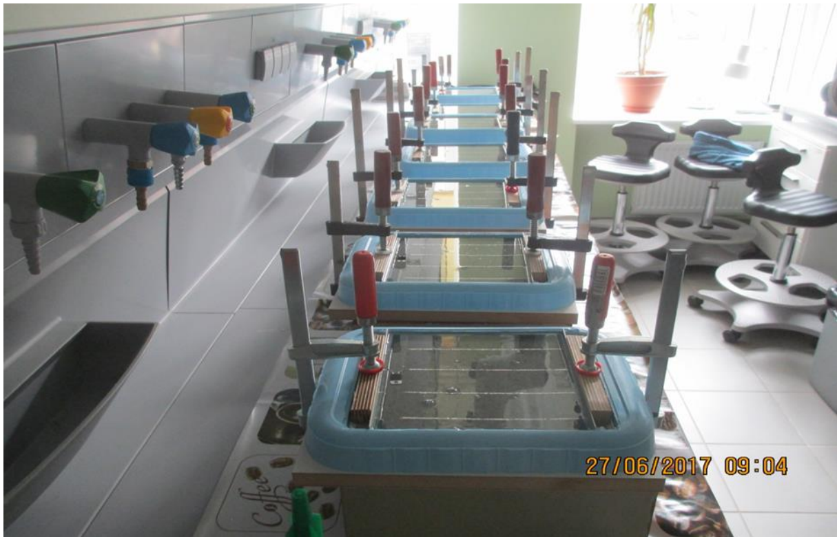
Joonis 3.7 e-tänavakivide kuivamisprotsess
