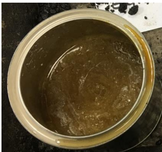
Joonis 2.40 Sulatatud biobituumen
