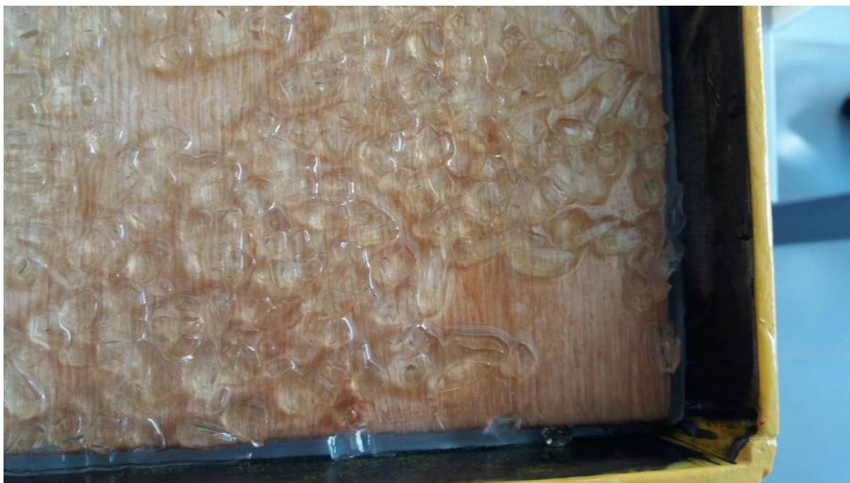
Joonis 3.16 B-tüüpi katsekeha puhul valati kõigepealt ~0,5 cm EPO kiht. EPO kihi sisse asetati ~0,5 cm kiht purustatud karastatud klaasi.
