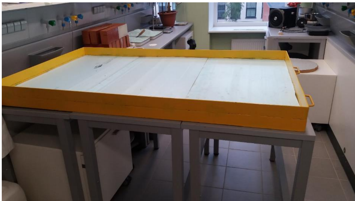
Joonis 3.15 Kasti põhi tehti kahekihiline, alumiseks kihiks vahtplast kõrgusega 7 cm ja ülemiseks kihiks veekindel vineer paksusega 2 cm.
