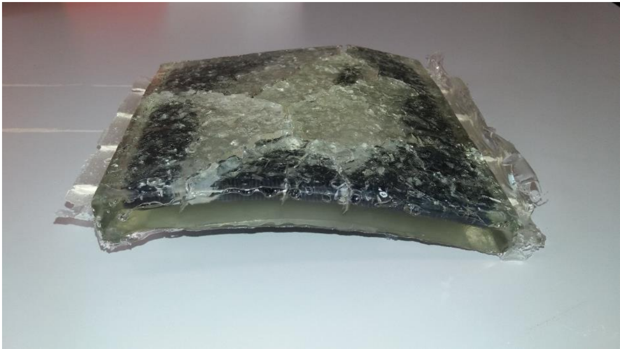
Joonis 3.9 Kõrgendatud temperatuuril kuivanud e-tänavakivi
