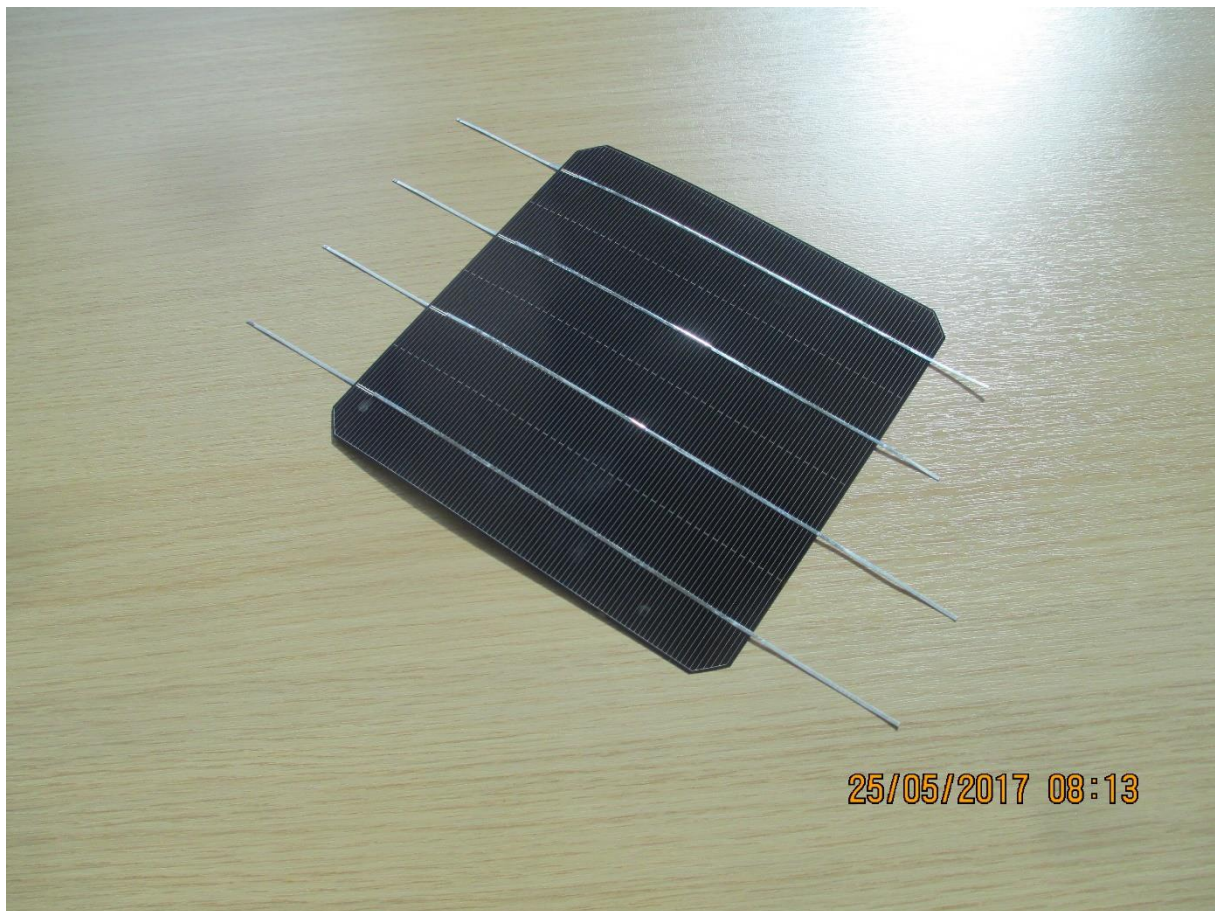
Joonis 2.19 Päikeseelement, monokristalne räni, kasutegur 20.2 %, 16 cmx 16 cm, paksus 0,18 mm. Pinge 0,5V
