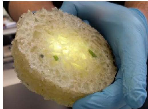
Joonis 2.63 Esiõlgset katsetused lõigatud sektorite valguse läbipaistvuse osas. 1 cm paksune sektor andis parimaid tulemusi, paksemate sektorite läbipaistvus vähenes oluliselt
