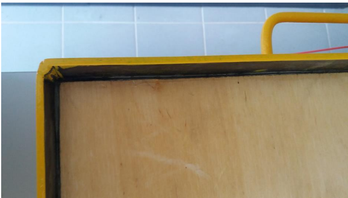
Joonis 3.17 Kõik sisemised vuugid isoleeriti läbipaistva Penosil Universal Silicone hermeetikuga
