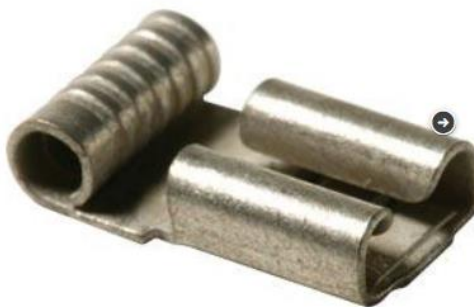
Joonis 4.1. Põhiline ühendustarvik. Kaks 3 cm juhtmega kokkujoodetud tarvikut moodustavad jootevaba ühenduse nii päikeseelemendi, kui ka LED valgustite vahel .
