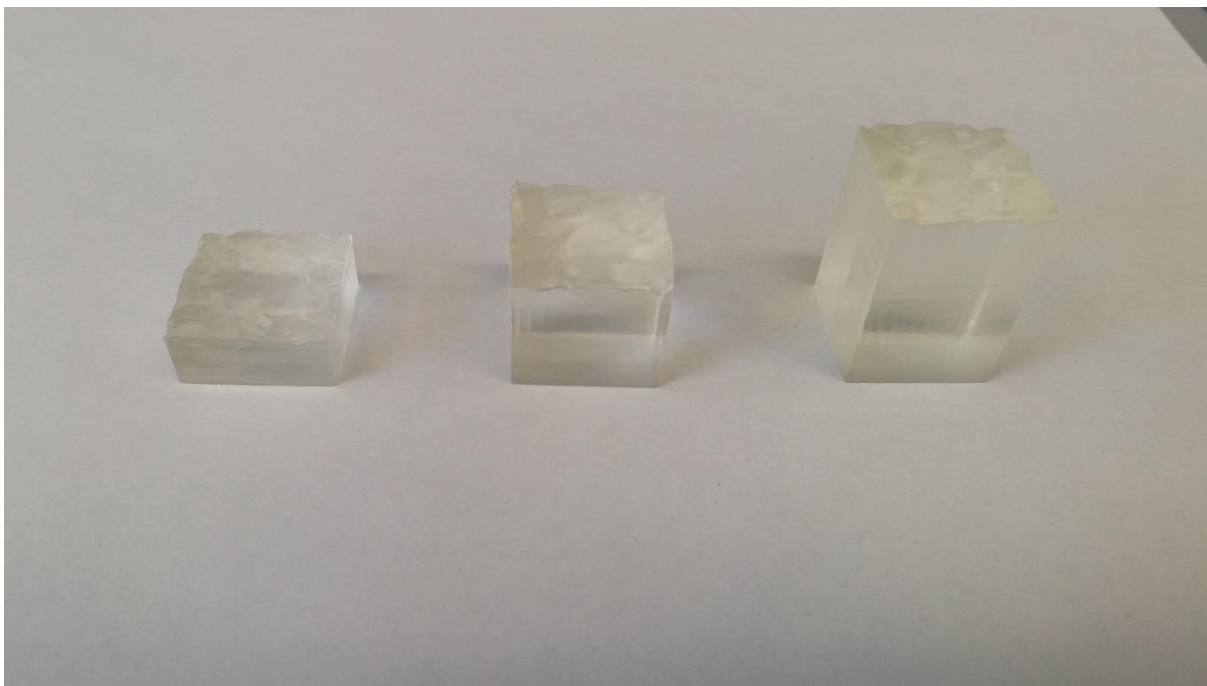
Joonis 2.26 Asfaldimustriga katsekehad kõrgustega 1 cm, 2 cm ja 3 cm
