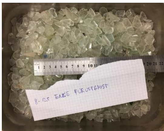
Joonis 2.43 Klaasipuru fr. 8...12.5 mm enne purustamist
