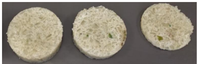
Joonis 2.62 Eri paksusega kihtideks saetud proovikeha
