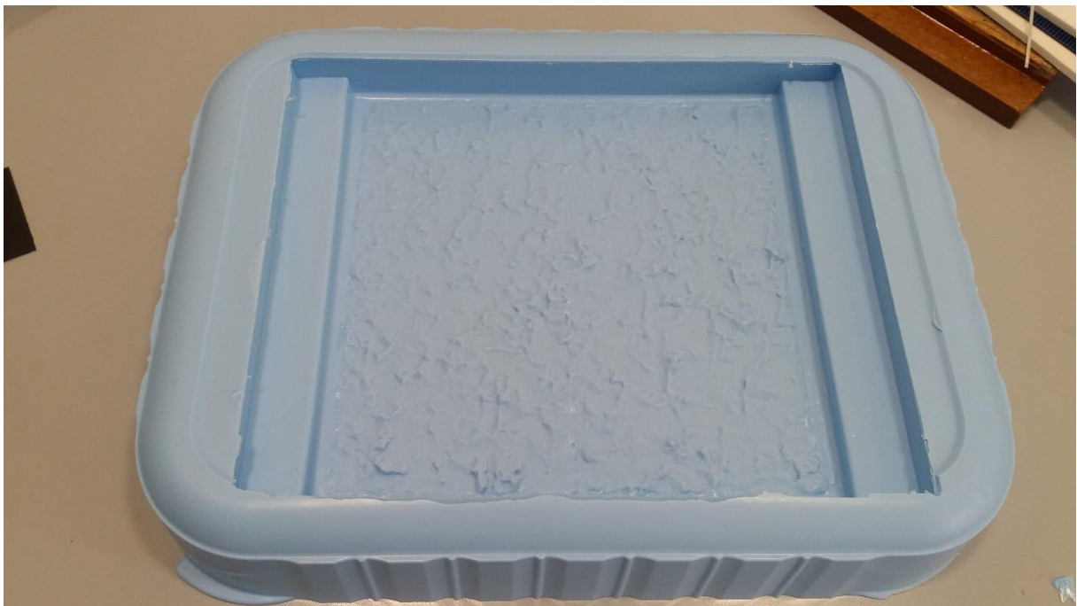
Joonis 2.36 17 cm x 17 cm silikoonvorm prototüübi valmistamiseks
