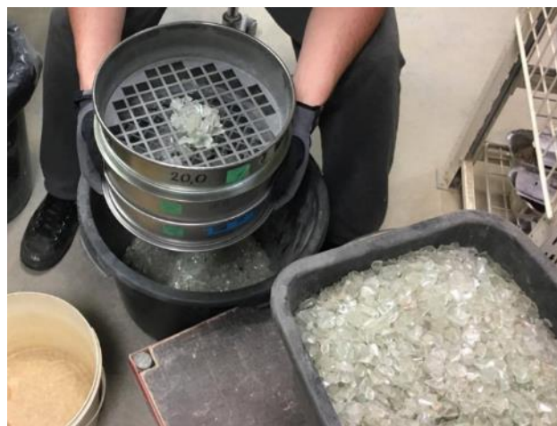
Joonis 2.42 Klaasipuru sõelumine, määramaks materjali fraktsioone
