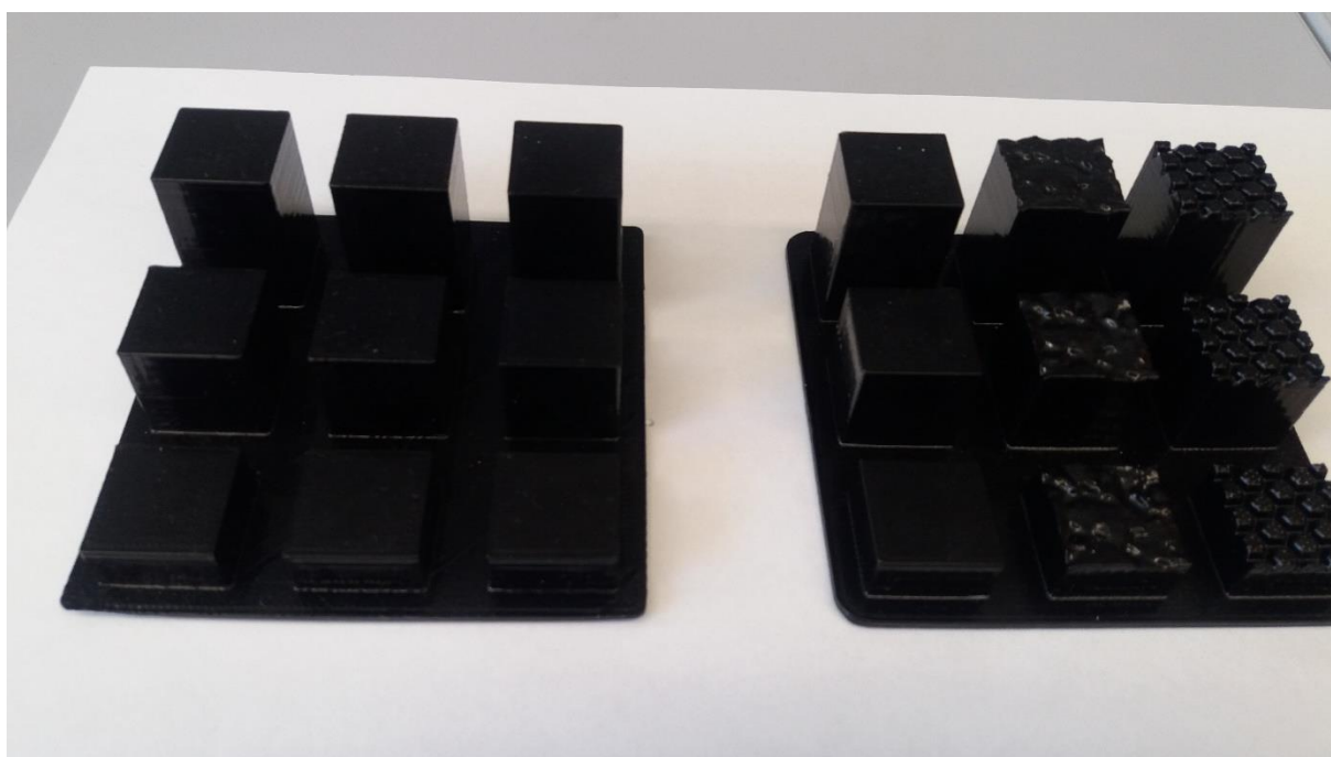
Joonis 2.23 3D-prinditud 9-pesalised šabloonid
