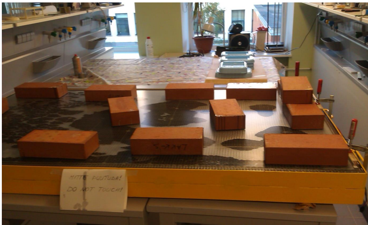
Joonis 3.20 Järgnevalt valati pealiskihiks 0,5 cm EPO vaiku metallvõrgu kinnitamiseks katendile. Metallvõrk asetati paika, millele asetati tasase pinna saavutamiseks karastatud klaas ning täiendavad raskused (tellised)
