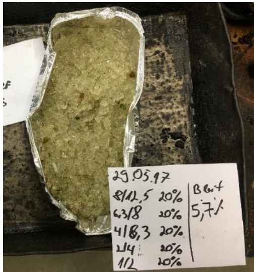
Joonis 2.59 Valmis segatud asfaltsegu, milles kasutati võrdsetes osades fraktsioone (igat 20 %) 1...2 mm, 2...4 mm, 4...6.3 mm, 6.3...8 mm ja 8...12.5 mm
