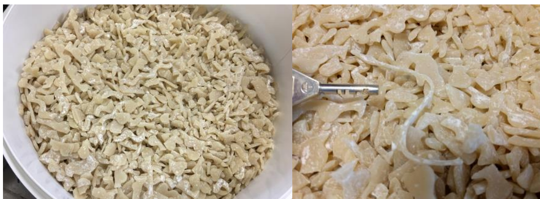
Joonis 2.39 Biobituumeni graanulid
