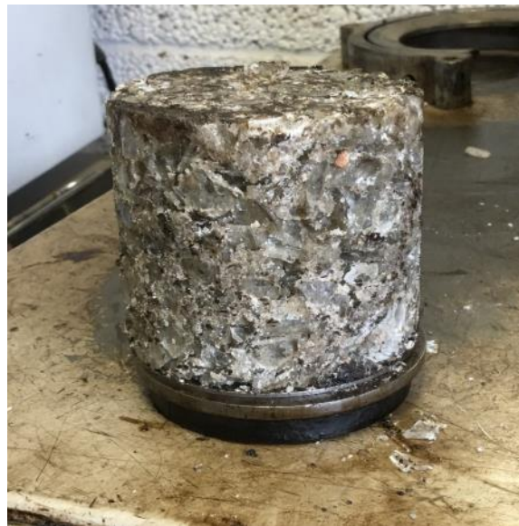
Joonis 2.58 SMA 12 terakoostisele vastav tihendatud proovikeha
