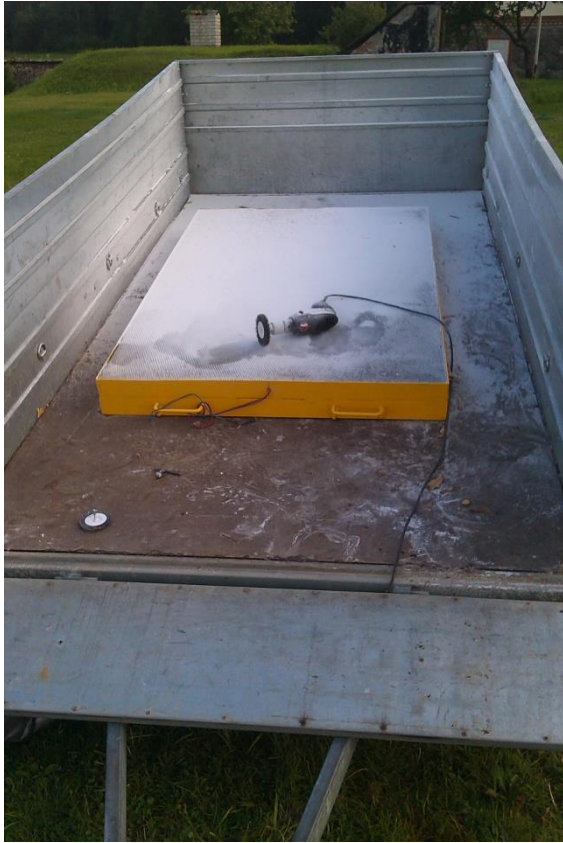
Joonis 3.22 Kõrgemad kohad lihviti maha, et metallvõrk täielikult katendi pinnalt välja ulatuks
