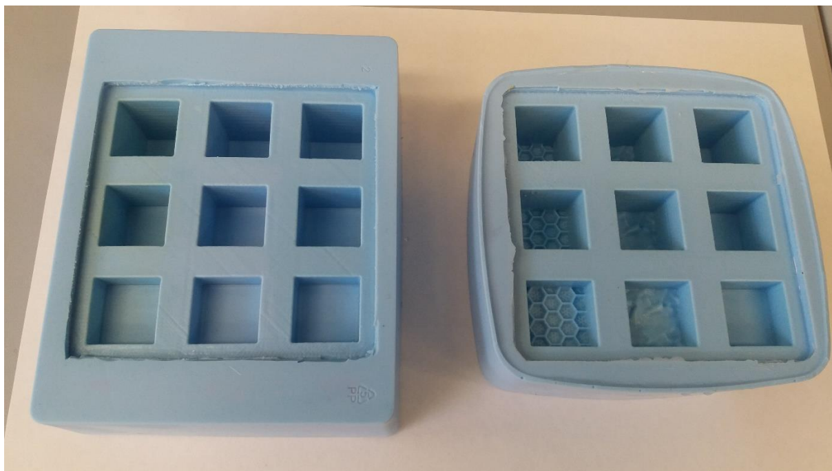
Joonis 2.24 Silikoonvormid 2 cm x 2 cm katsekehade valamiseks
