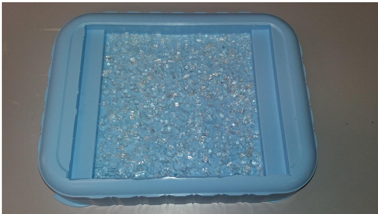
Joonis 2.37 17 cm x 17 cm vorm täidetud klaasiga
