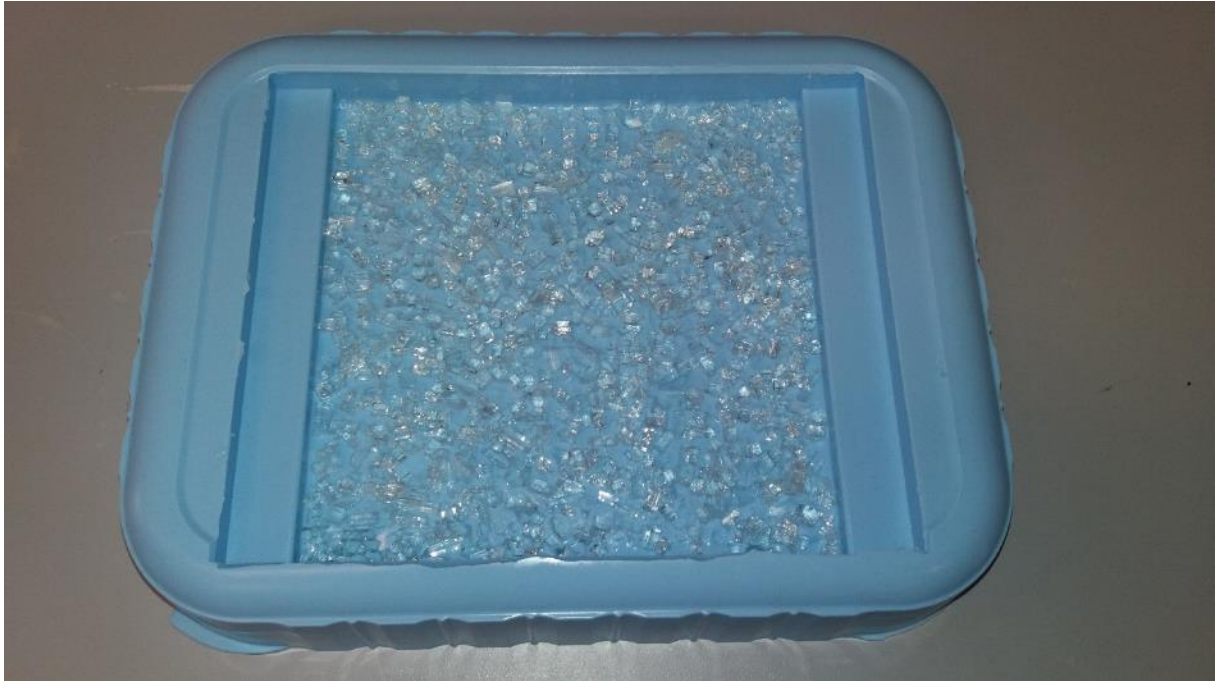
Joonis 3.5 Purustatud klaasiga valuvorm
