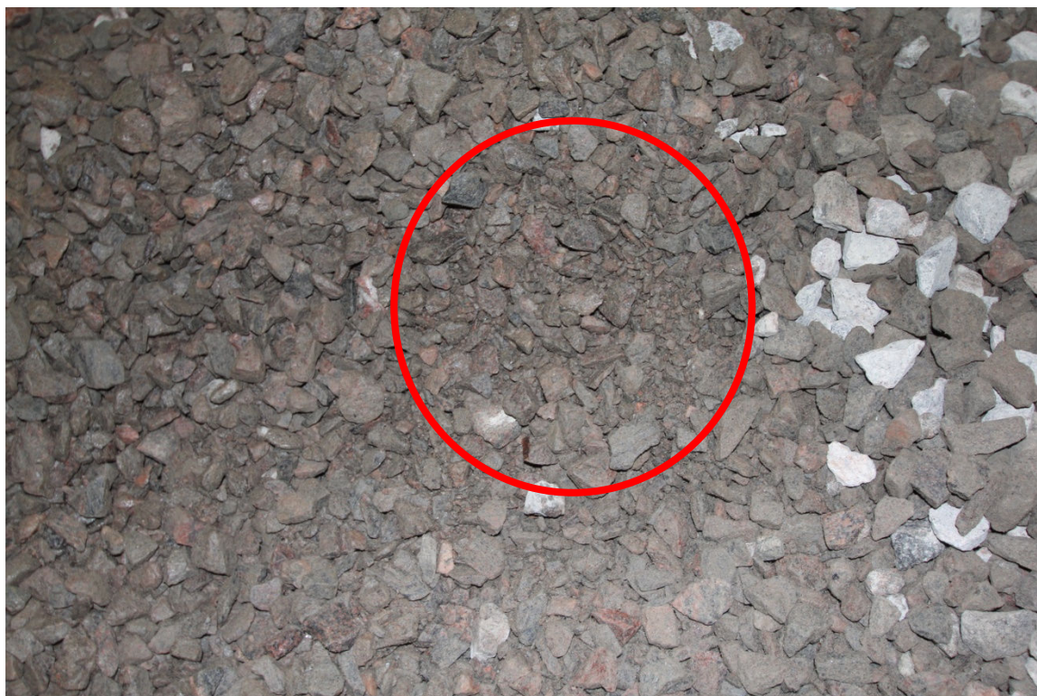
Joonis 34. Tarnitud graniitkivikillustikus oli kohati ohtralt peenemat puru
