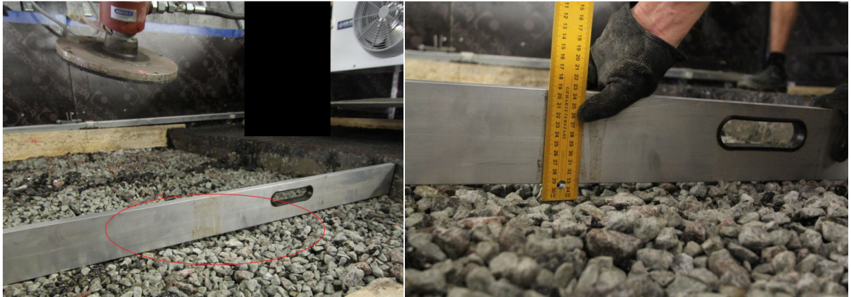
Joonised 23 ja 24. Vajum killustiku peal
