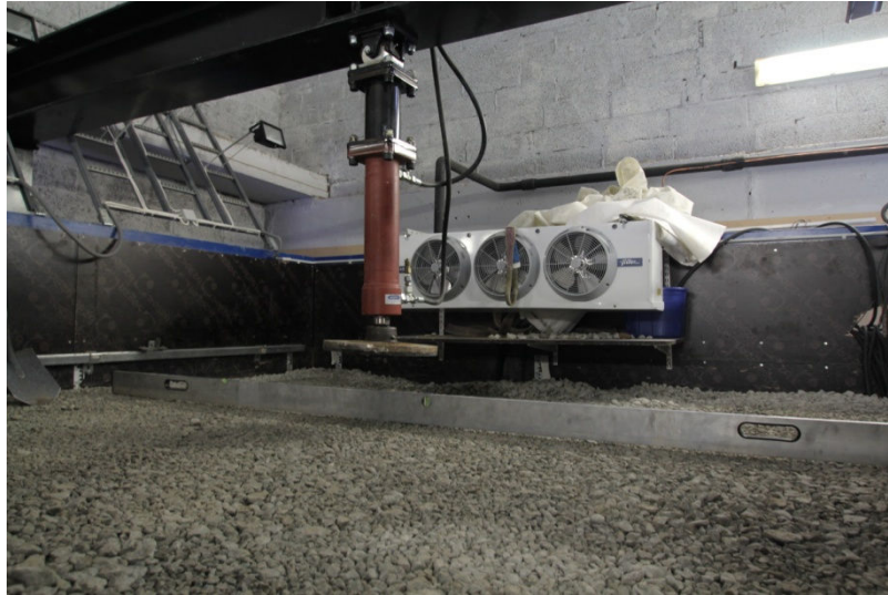
Joonis 30. Killustiku pind peale tihendamist
