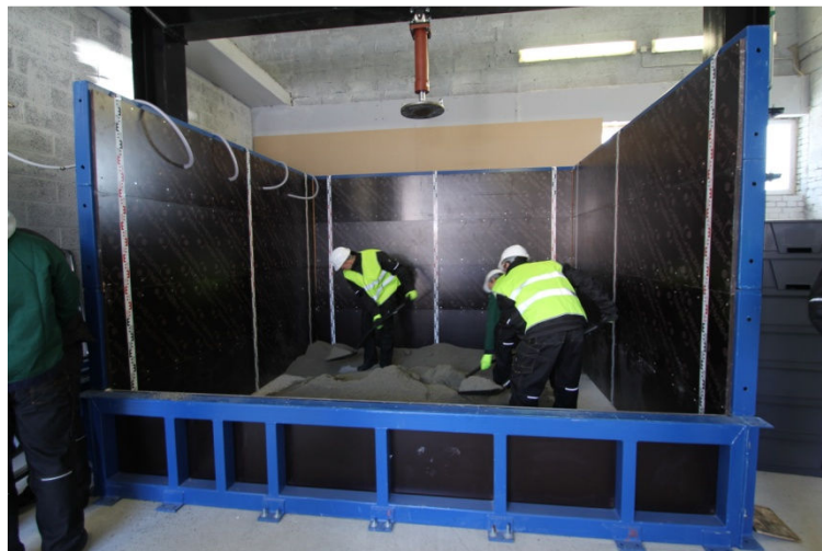
Joonis 1. Tallinna Tehnikakõrgkooli teekonstruktsioonide simulatsiooniseade
