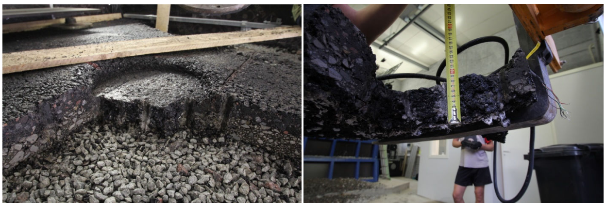
Joonised 21 ja 22. Asfaldikiht peale katsetust lammutamise käigus ja kihipaksus koormustalla all
