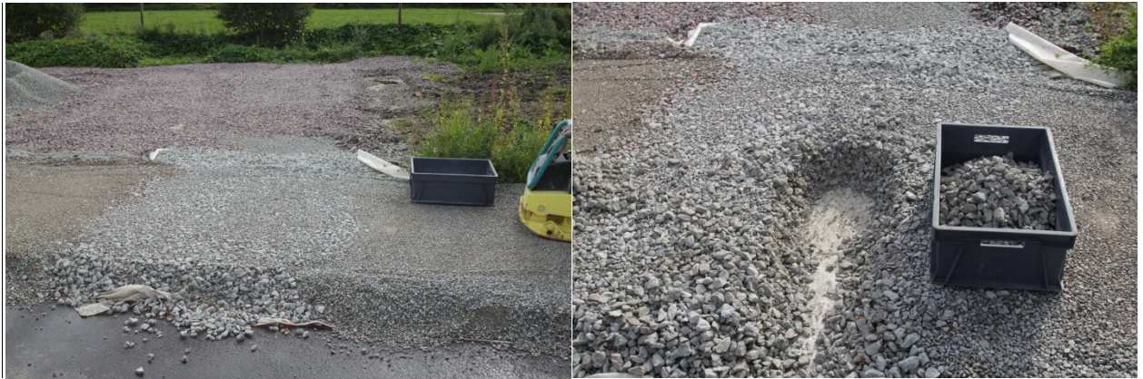
Joonised 16 ja 17. Tihendatud killustiku proov kastist ja katselõik teise katse puhul
