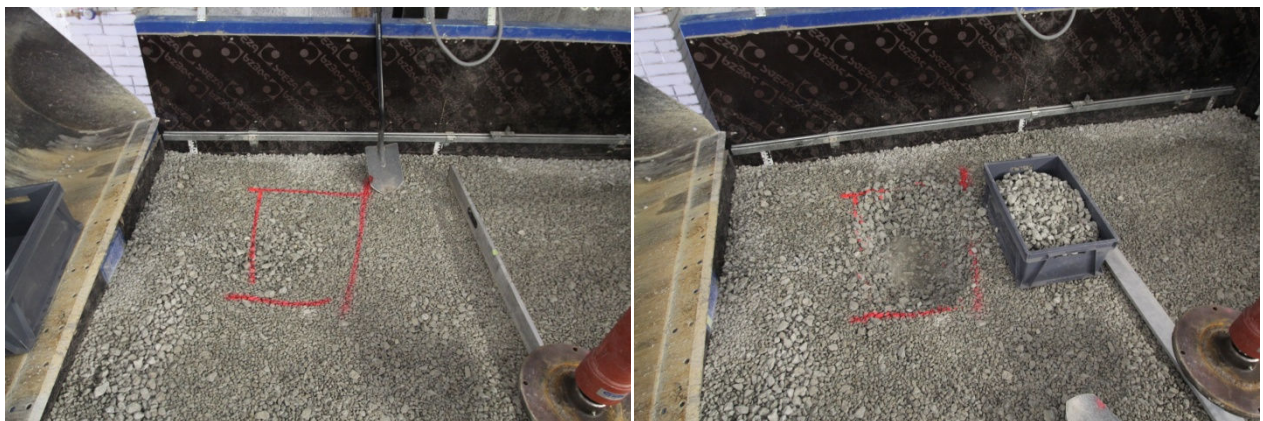
Joonised 14 ja 15. Lubjakivikillustikust võetud proovid pärast tihendamist kastist
