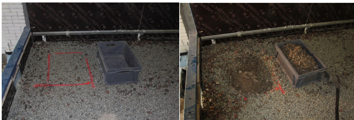
Joonised 12 ja 13. Tardkivikillustikust võetud proovid pärast tihendamist
