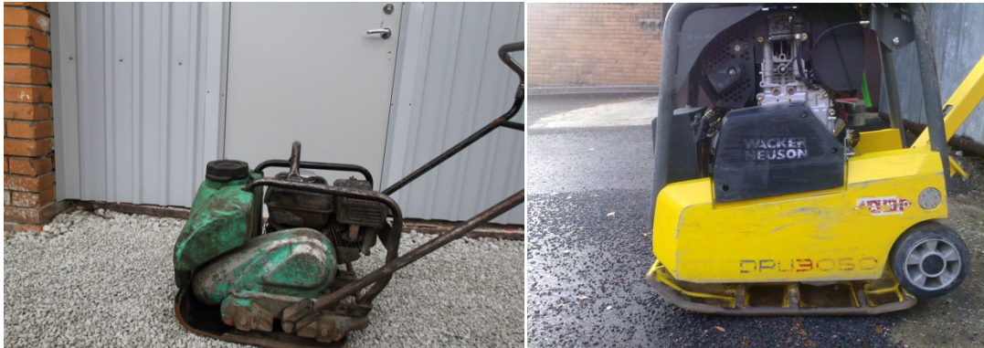
Joonised 9 ja 10. Asfaltbetooni tihendamiseks kasutatud vibroplaadid
