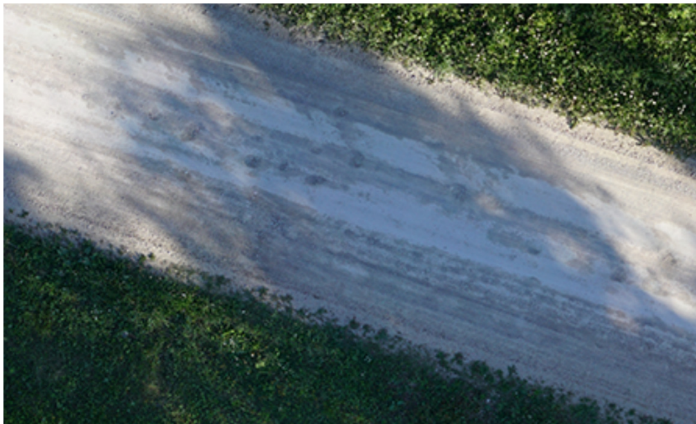
Joonis 21. Varjulises kohas on varjud segavaks faktoriks, kuid tee seisukord koos aukudega on siiski hästi nähtav.
