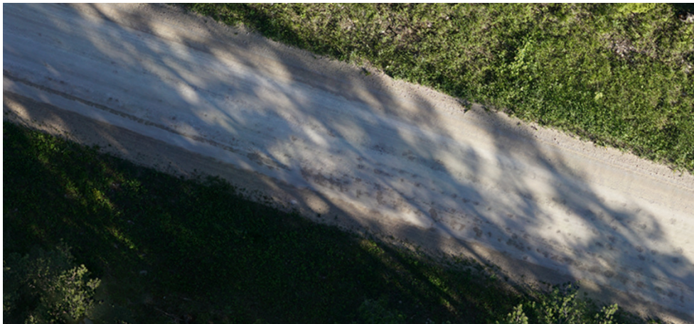
Joonis 20. Varjulises kohas on varjud segavaks faktoriks, kuid tee seisukord koos aukudega on siiski hästi nähtav.
