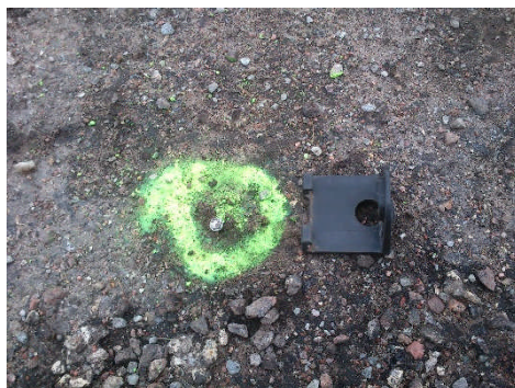
Joonis 7. Silla koormuskatsetusel kasutatud mõõtepunkt (kuuskantpeaga kruvi sisestatud asfaltkatendisse)
