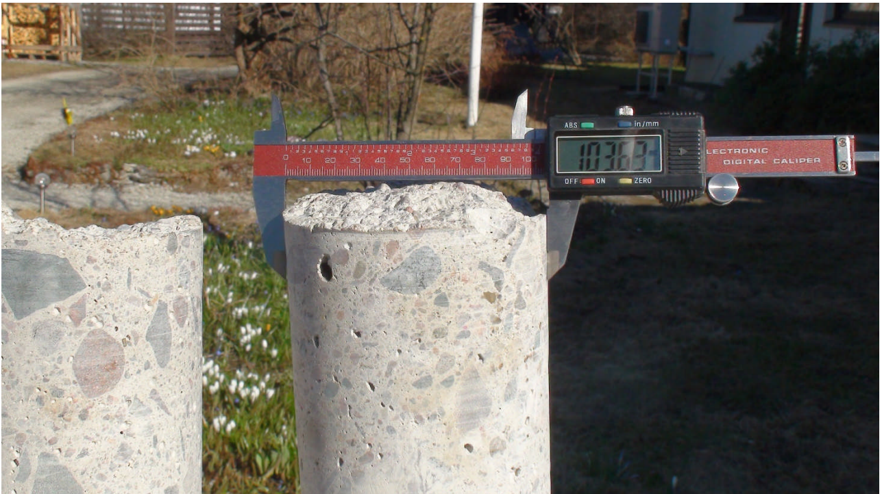
Foto 6. . Peatalast väljapuuritud südamikud betooni survetugevus määramiseks(pikkus 310 mm, läbimõõt 103,4 mm)
