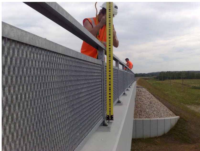
Joonis 2. Nivelleerimisel kasutatud 2 m pikkune invarribaga koodlatt LD12 (foto pärineb ühelt varasemalt sillakatsetuselt).
