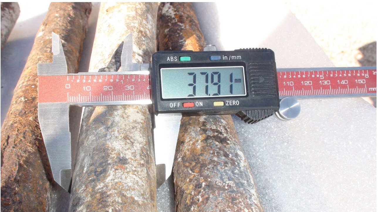
Foto 3. Proovikehadeks kasutatud varraste seisund, Ø 36 – 38 mm.
