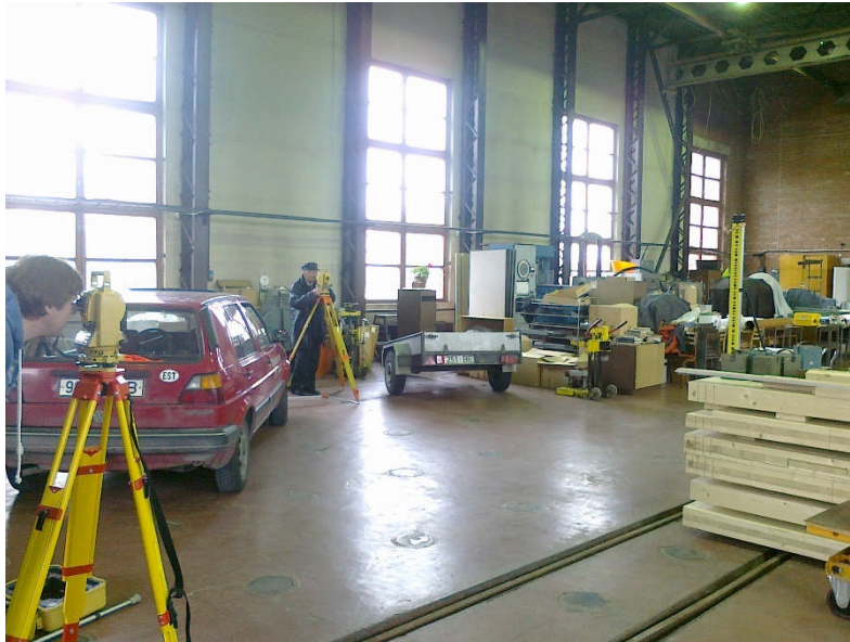
Joonis 3. Invarlati ja ümarvesiloodi telgede paralleelsuse kontroll ja justeerimine kahe elektron-tahhümeetriga
