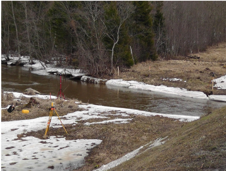
Joonis 18. Tahhümeeter M3 ning tähised T1, T2 ja N1 põhjapoolisel küljel
