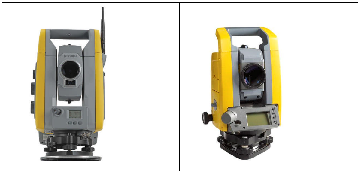
Joonis 13. Loobu sillamõõtmistel kasutatud laser-tahhümeetrid Trimble S6 (vasakul) ja M3 (paremal)
