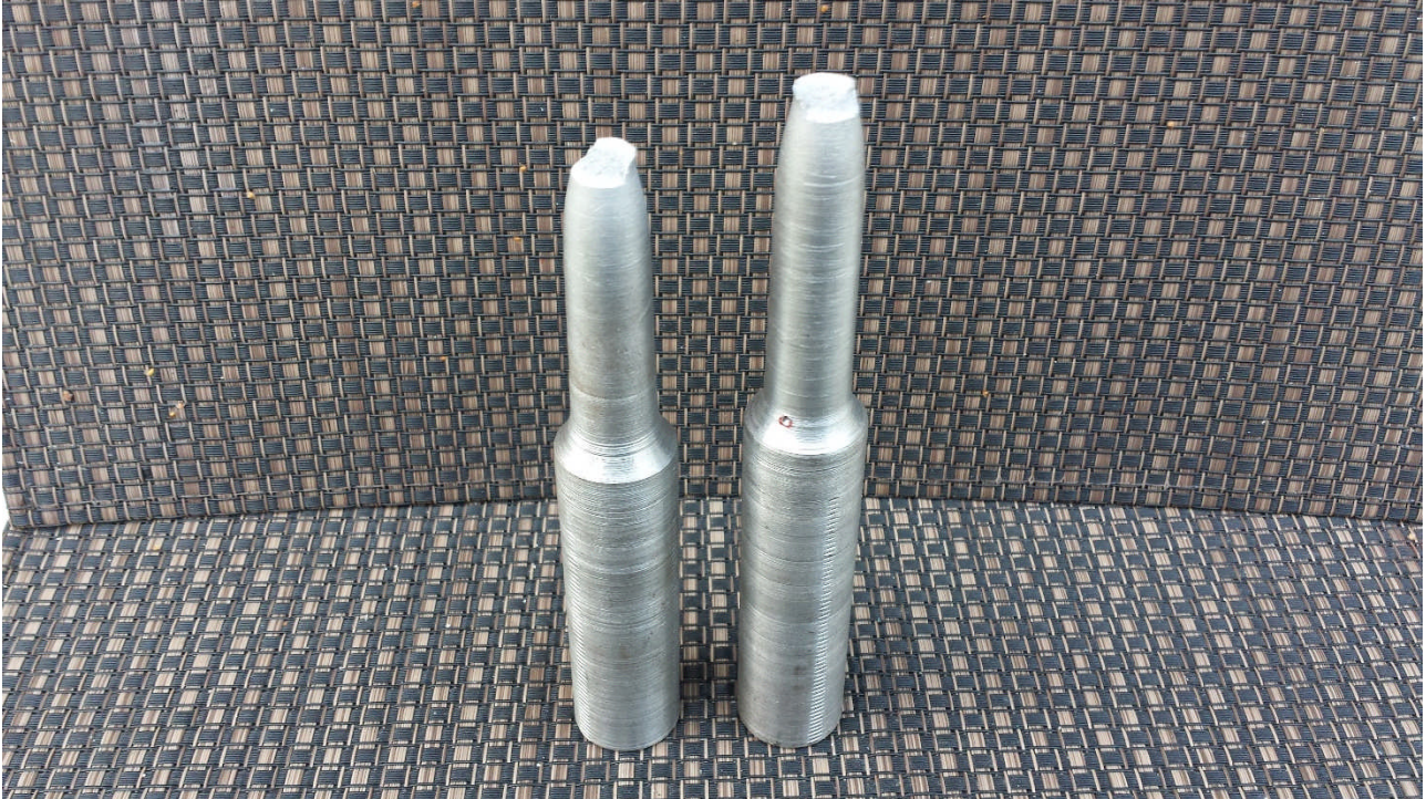
Foto 4. Loobu II silla peatala armatuuri proovikehad peale katsetamist
