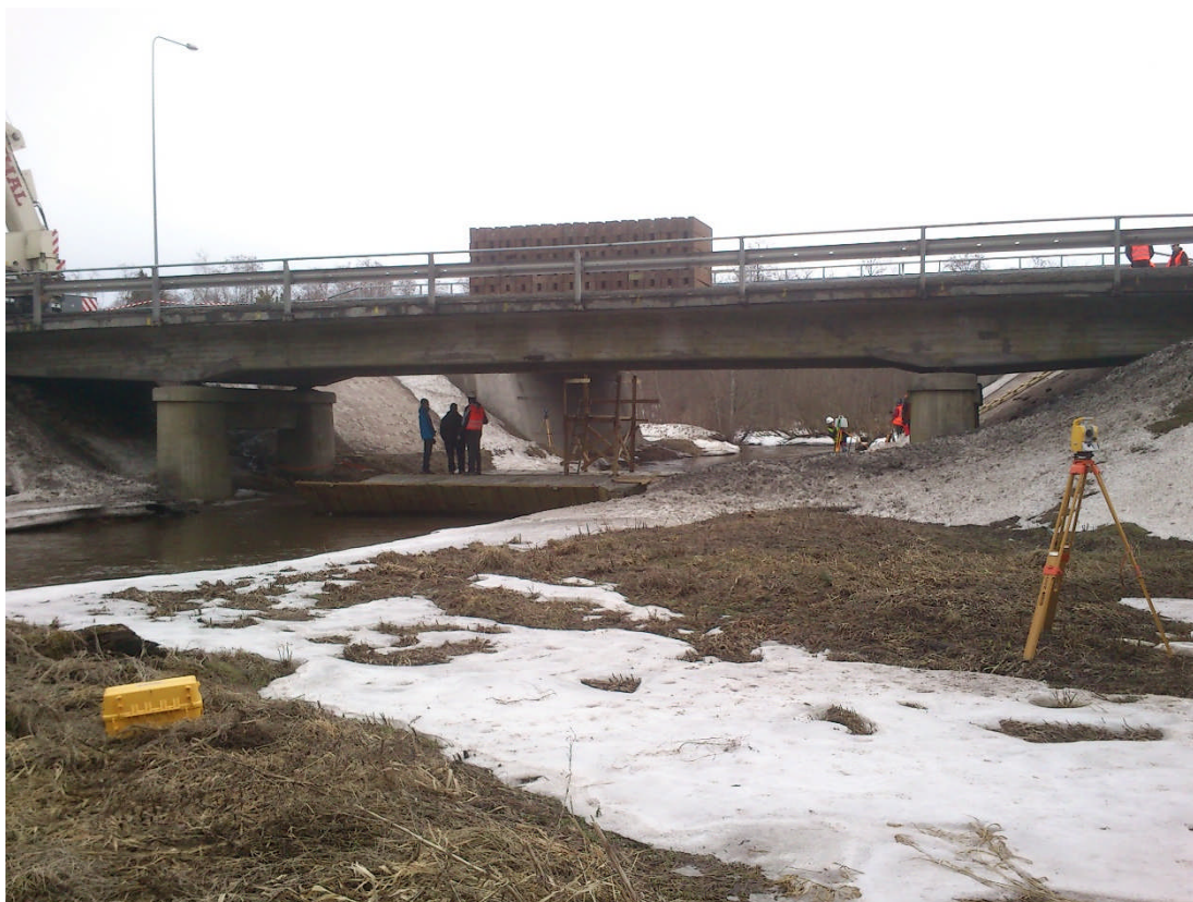
Joonis 6. Katsetatav Loobu maantee-sild, metallkoormused on laotud silla keskmise ava kohale lõunapoolsele sõidurajale. Vaade lõunasuunda, esiplaanil paremal põhjapoolne lasertahhümeetria jaam
