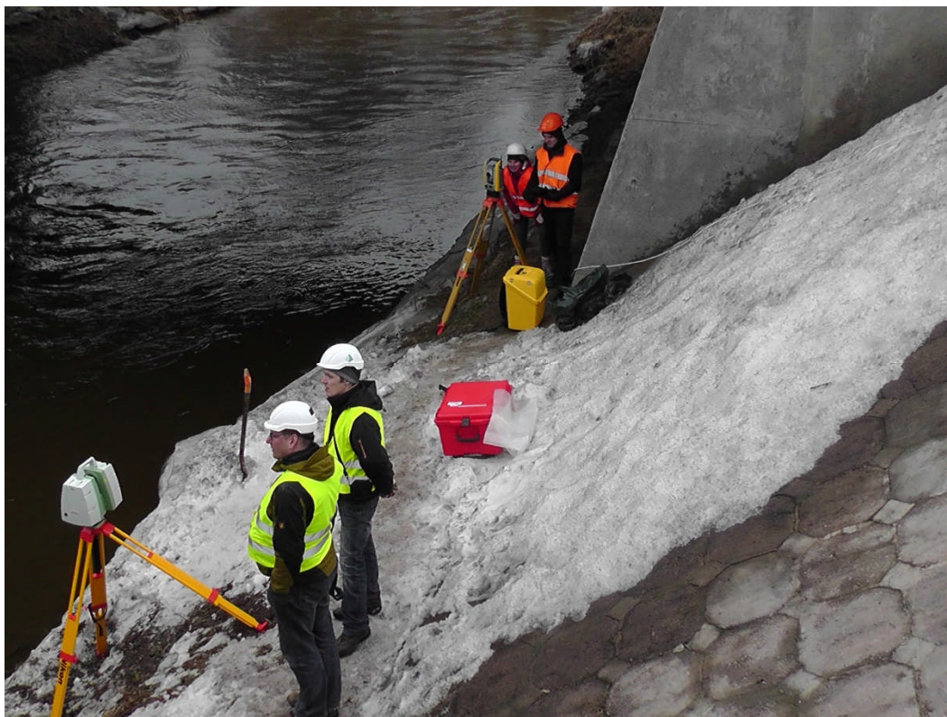
Joonis 14. Tahhümeeter Trimble S6 ning terrestriline laserskanner silla lõunapoolsel küljel
