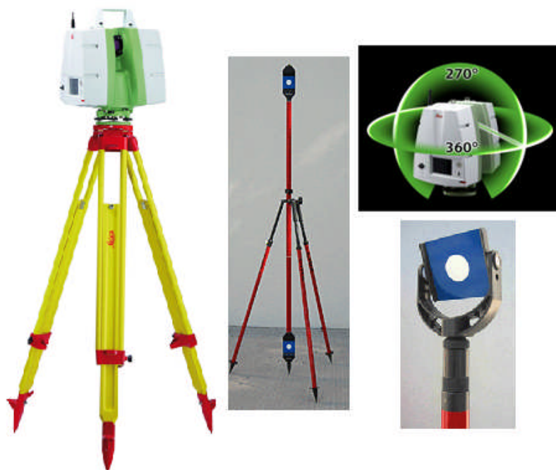
Joonis 25. Laserskanner, tähised ning mõõtmisulatus
