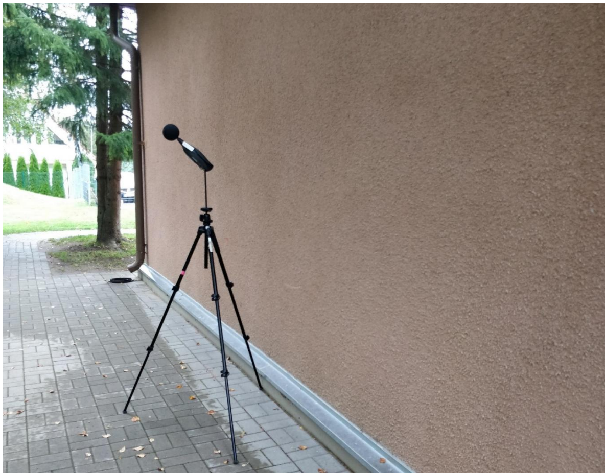
Foto 2. Liikluse müra mõõtmine koherentse peegelduse ehk +3 dB tingimustes
