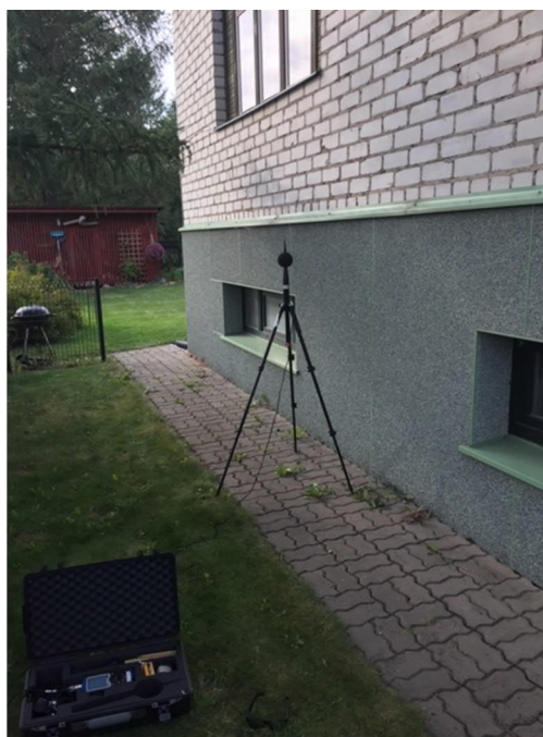
Foto 2. Liiklusrüüra mõõtmine koherentse peegelduse ehk +3 dB tingimustes
