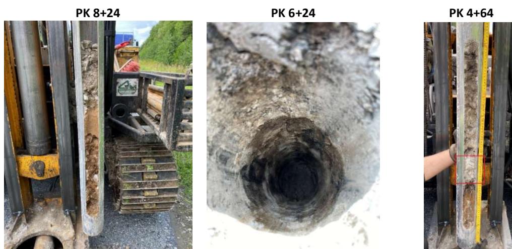
Joonis 7.6. Ristlõige PK 8+32, vana stabikiht ei ulata tänase teekatte alla täies laiuses. PK 6+24, põikpragu ulatub läbi asfaltkatte kui uue stabikihi kuni vana betoonitaolise kihini. PK 4+64 oli vana stabikiht nõrk, mida oli võimalik proovliga läbistada (märgistatud punase ristkülikuga)
