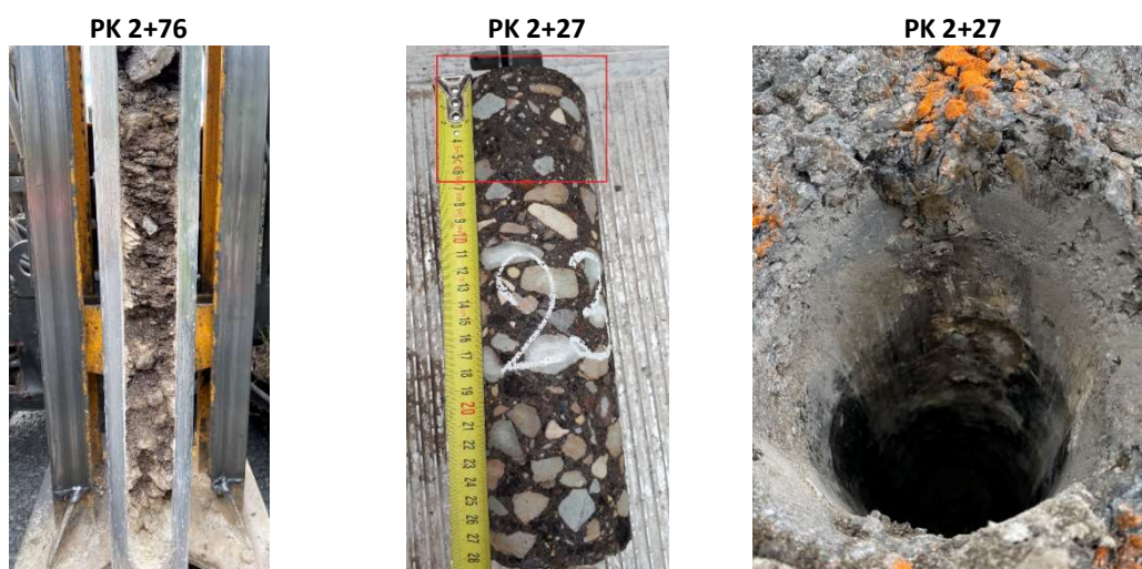
Joonis 7.7. Ristlõige PK 2+76. Uue stabikihi ülaosa oli väga tihe, millest proovliga läbimine oli raskendatud. Stabikiht justkui koosneks kahest erinevast kihist, mis tuleb esile ka mõningate puurkehade põhjal (nr 23, 20, 19, 18, 17). PK 2+27 põhjal nähtus, et põikpragu ulatus on kuni uue stabikihi tiheda osa lõpuni, kus enam edasi ei lähe.
