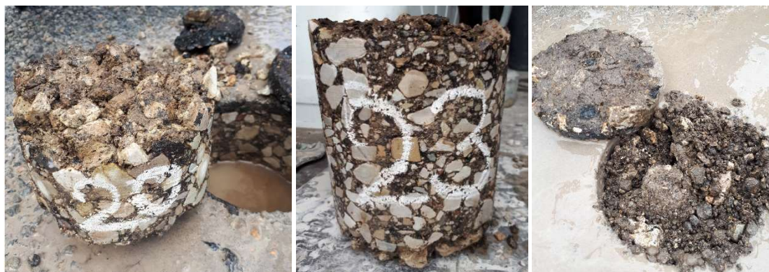
Joonis 7.9. Puurkehad nr 20, 23 ja puurauk nr 30. Puurkehad on võrreldes tuhkstabiliseeritud kihiga selgelt nõrgemad ja halvemas seisukorras. Mass-stabiliseerimata turbaga lõigult ei olnud võimalik kätte saada ühtegi tervet puurkeha.
