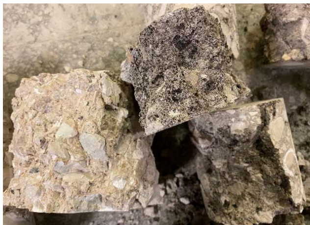
Joonis 7.4. CFB tuhaga stabiliseeritud proovikehade võrdlus peale survetugevustesti läbimist: vasakul on ilma freespuruta Simuna-Vaiatu proovikeha ja paremal freespuruga Narva-Mustajõe; viimane on rabedama ja „pehmem“ koostisega.
