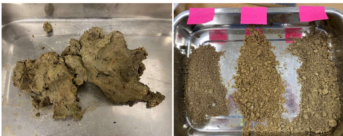
Joonis 7.15. Segades kõrge veesisaldusega plastse pinnase (antud juhul 8%) põlevkivituhaga, muutus pinnas liivataoliseks.
