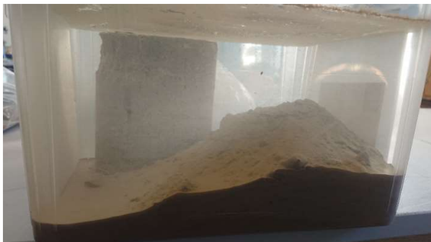
Joonis 7.13. Veekonteineris seisev 4% CFB põlevkivituhaga stabiliseeritud katsekeha võrdlusena stabiliseerimata materjaliga. Katsekeha on eelnevalt läbinud survetugevuse testi, mis purustas selle ääred ning tekitas kehasse pragusid. Sellegipoolest püsib katsekeha tervena.
