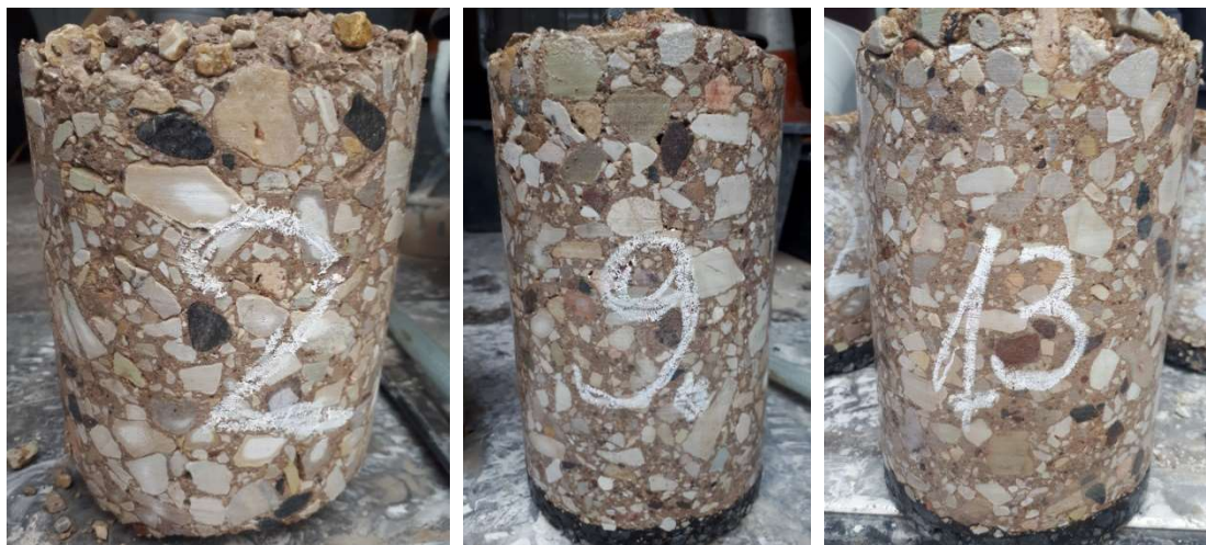
Joonis 7.8. Fotod puurkehadest, puurkeha nr 2 on võetud mass-stabiliseerimata turbaga lõigult ja kihis on võimalik näha mikropragusid. Mass-stabiliseeritud turbaga lõikudelt võetud puurkehad on väga heas seisukorras.
