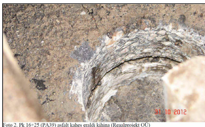
Foto 7.9. 2012aastal katselõigu E puurauk ja kätte saadud stabiliseeritud kihi proov.
