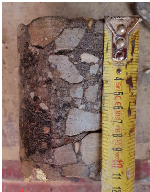
Foto 7.5. Puurkeha Narva-Mustajõe objekti katselõigult C
