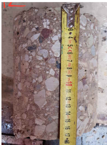
Foto 7.14. Mass-stabiliseeritud lõigul olid tuhkstabi proovikehad väga heas seisukorras.
