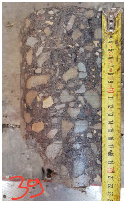
Foto 7.3. Puurkeha Narva-Mustajõe objekti katselõigult B
