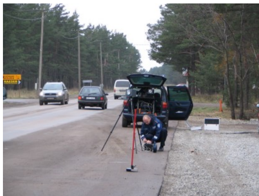
Foto 2-3. Radarseadme ettevalmistamine mõõtmisteks
