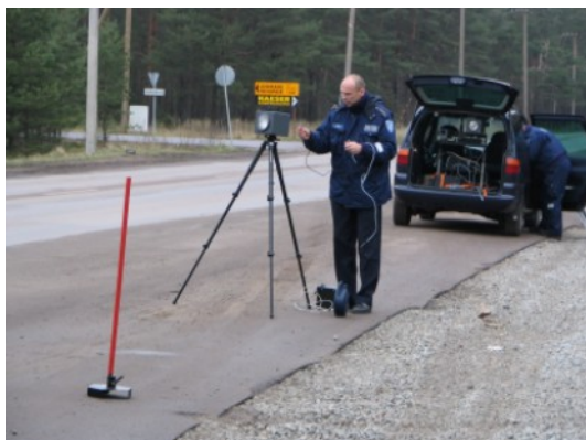
Foto 2-3. Radarseadme ettevalmistamine mõõtmisteks
