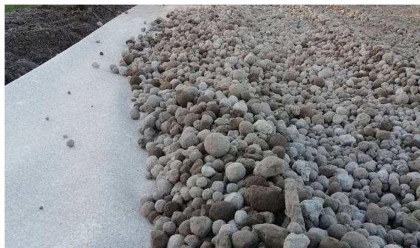
Foto 4.22. Elektriijaama tuhost tehtud kerg-graanulid, millel on liivaga võrreldes oluliselt paremad soojusisolatsiooniomadused [foto: Östergård Anders]. Taolise materjali tegemist on uurinud ka Eesti Energia, see on võimalik, kuid täna veel liiga kallid.
