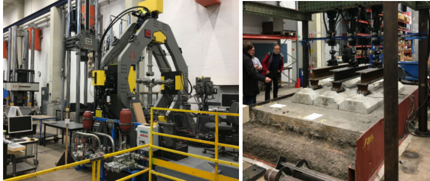
Fotod 4.20 ja 4.21. Proovikeha mitmetelgset tõmmet, surumist ja väänet võimaldav katseseade. Asfaltbetoonkatte testimine raudteeliiprite all.
