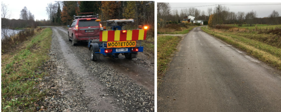
Fotod 3.10 ja 3.11. Veskitaguse tee oli nõrga kandevõimega kruusatee, mille katteks oli freespuru. Mõned mõõtepunktid võeti ka pinnatud sektsioonidelt.
