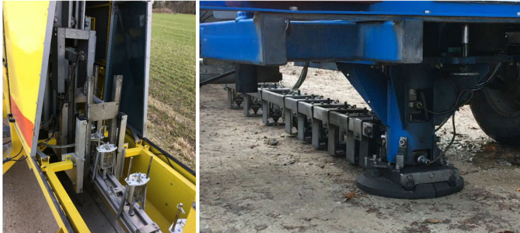
Fotod 3.4 ja 3.5. KUABi sisemus, kus on näha kahemassilist koosmussüsteemi ja seismomeetreid võrdluses Dynatesti anduritega [fotod: Sven Sillamäe]
