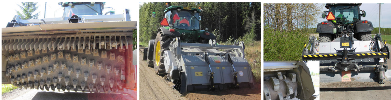
Foto 4.25. Kergem frees ja kivipurusti, mida Soomes kasutatakse pinnatud kruusatee muutmiseks kruuskattega teeks. [fotod: Oiva Huuskonen]
