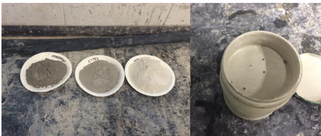
Foto 2. Kaalutud kogustega lisandid (vasakult paremale Penetron Admix , Xypex Admix C-1000 , Betocrete C-36 ) suspensiooni valmistamiseks ja valmis suspensioon ( Betocrete C-36 )
