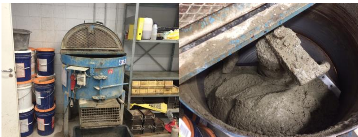
Foto 3. Gravitatsioonisegistist ja segu gravitatsioonisegistis
