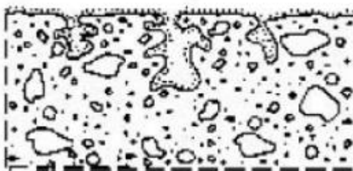
Joonis 1. Tüüpilise hüdrofoobitud pinna skemaatiline kujutis [10]
