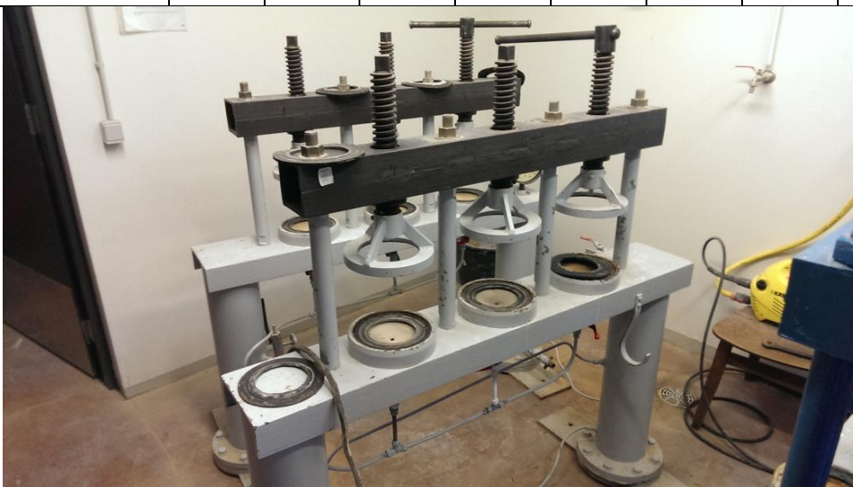
Foto 10. Katseseade betooni veepidavusklassi määramiseks GOST 12730.5-84 järgi
