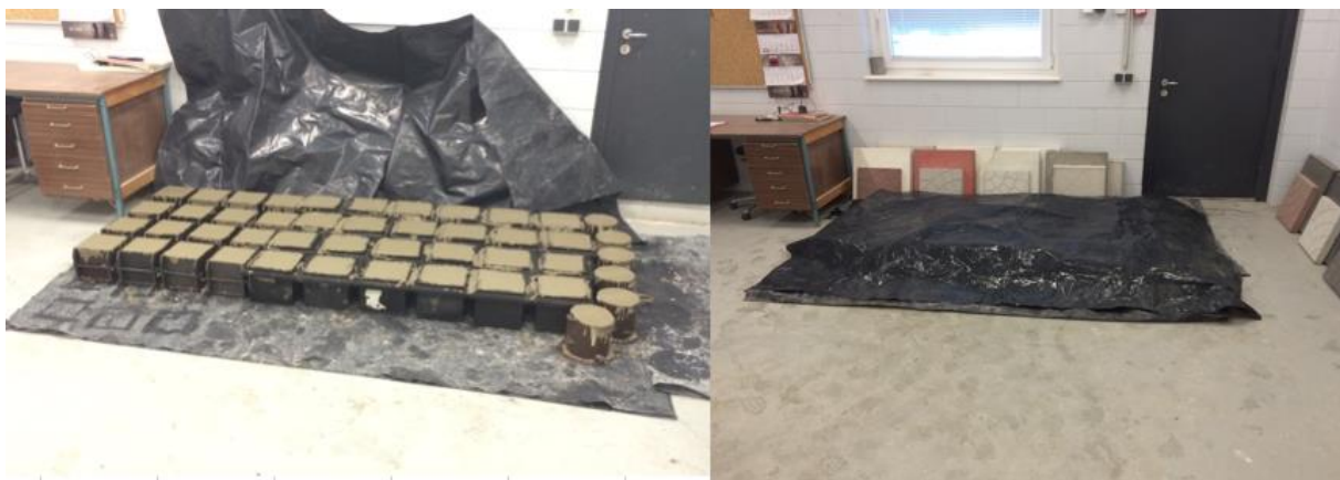
Foto 4. Valmistatud katsekehad lahtiselt ja kile all
