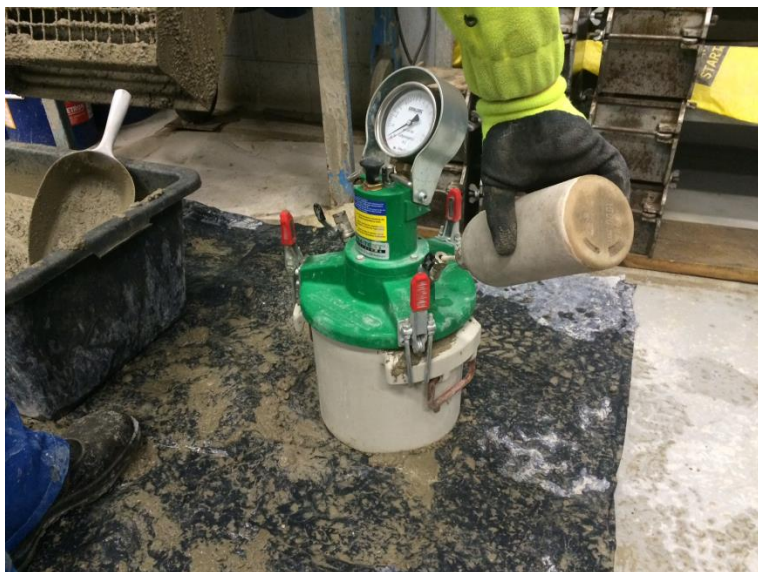
Foto 7. Rõhumõõtur betooni õhusisalduse määramiseks
