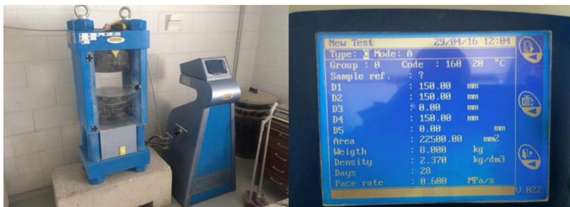
Foto 8. Survekatsemasin vasakul ja masinale esitatud parameetrid, mida arvestatakse survetugevuse arvutamisel paremal
