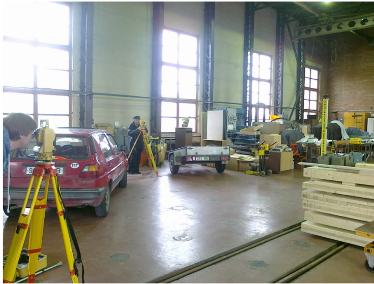
Joonis 7.21. Invarlati ja ümarvesiloodi telgede paralleelsuse kontroll ja justeerimine kahe elektron-tahhümeetriga.
