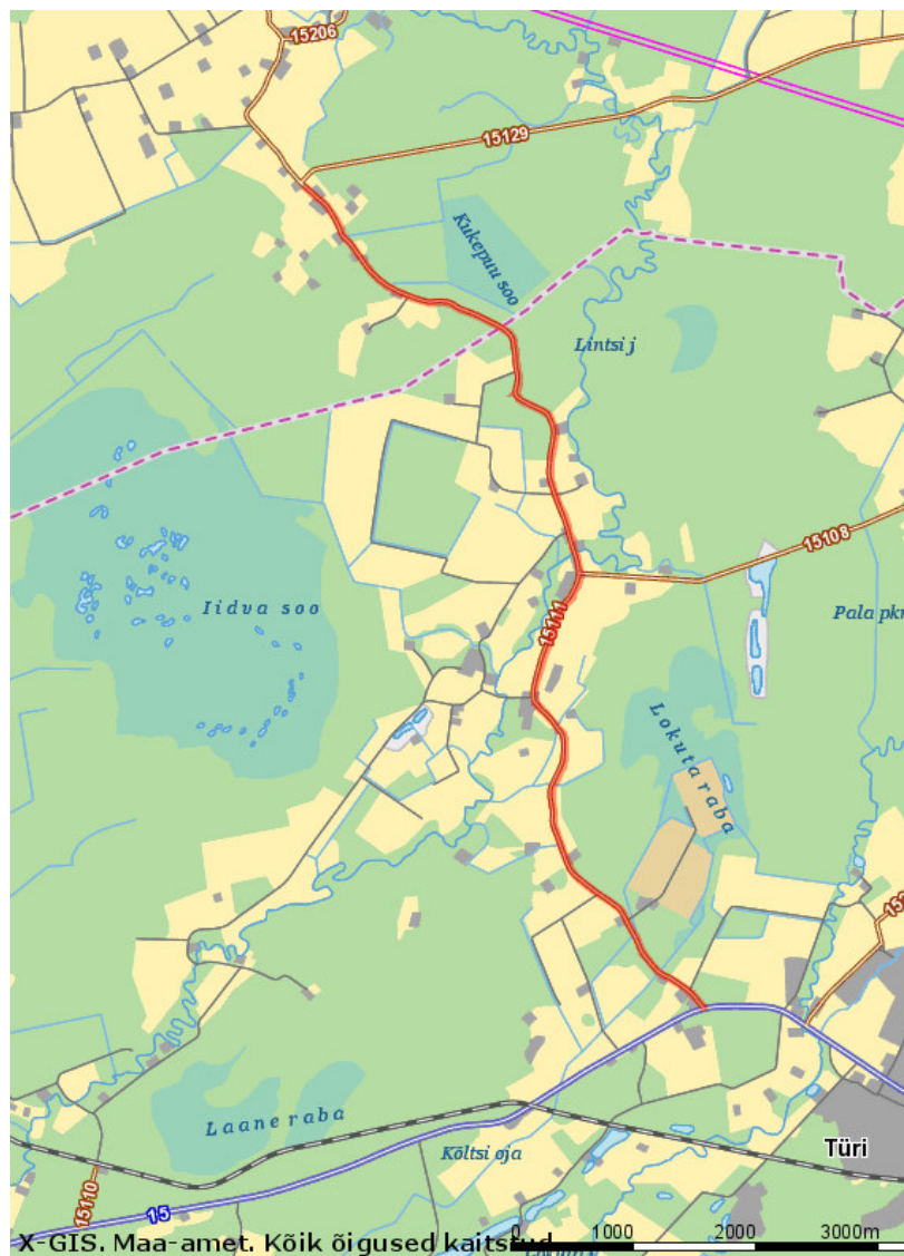
Joonis 2.1. Maantee 15111 Lokuta-Roovere km 0,0-8,7 trassi plaan
