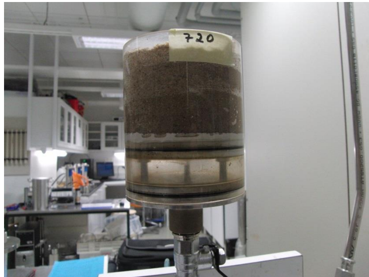
Kuva 2. Kapillaarisen nousukorkeuden määrittäminen Sahi-menetelmällä.
