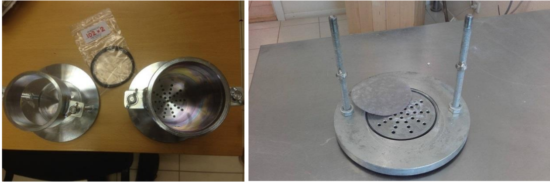
Joonis 3.5. Vasakul Proctor vormi pealtvaade erinevatele alustele ja kummitihendid. Paremal alus koos sõelaga. [Sten-Kristjan Saariku fotod]
