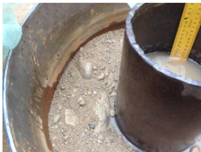
Joonis 2.11. Infiltromeetrikatse ei ole kruuspinnase puhul võimalik, kuna rõngaid ei saa suruda pinnasesse. [Sten-Kristjan Saariku foto]
