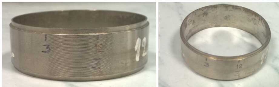
Joonis 1.54. Külmakerketesti rõngas KLABi laboris. [Sven Sillamäe foto]
