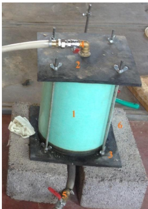
Joonis 3.8. Püsiva rõhuga permeameetri katsesilinder koos osade numbriliste tähistustega. [Sten-Kristjan Saariku foto]
