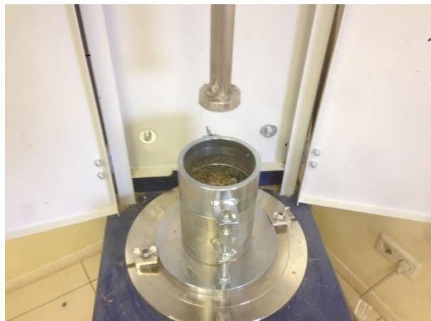
Joonis 3.6. Proctor tihendusseade koos vormiga. [Sten-Kristjan Saariku foto]
