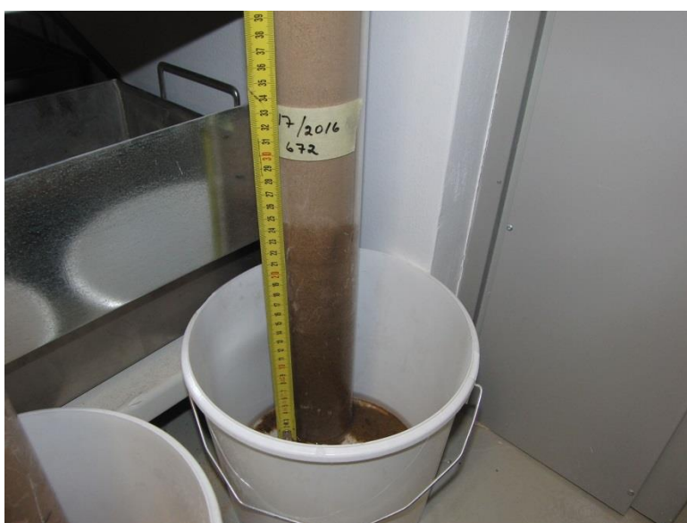
Kuva 1. Suoran putkimenetelmän koejärjestelyt ja tiivistyksessä käytetty täryrauta.
