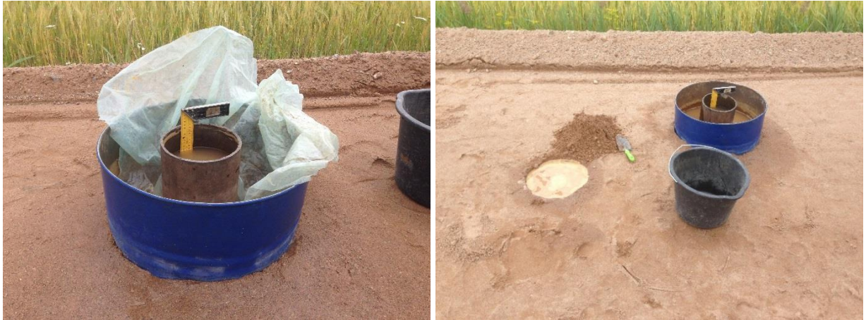
Joonis 2.5. Sissevalamiskatsed kahe rõngaga infiltromeetriga [Sten-Kristjan Saariku fotod]
