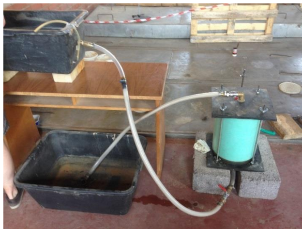
Joonis 3.12. Permeameetri veega küllastamine. [Sten-Kristjan Saariku foto]
