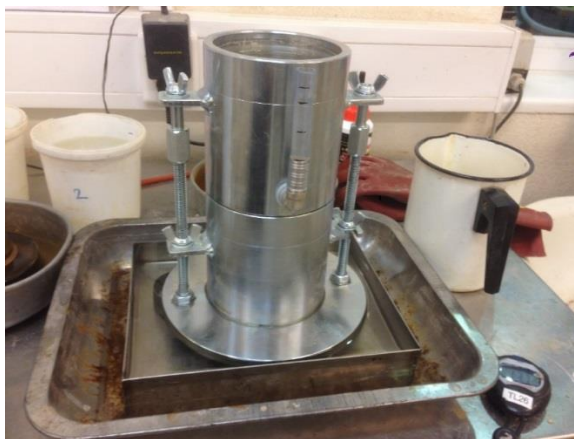
Joonis 3.7. Filtratsiooni mõõtmine modifitseeritud Proctor vormis. [Sten-Kristjan Saariku foto]
