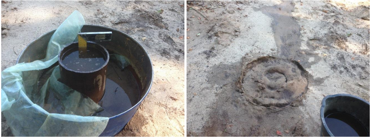
Joonis 2.8. Infiltratsioon kahe rõngaga enne ja pärast katset. [Sten-Kristjan Saariku fotod]
