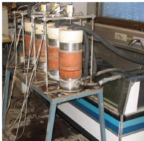
Joonis 1.47. Külmakerketesti proovikehad peale katsetust, kui soojustus on eemaldatud ja katsekehad on veevannist välja tõstetud. [22]
