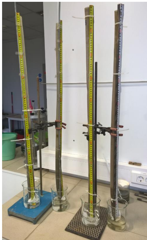
Joonis 1.57. Kapillaartõusu määramine KLABi laboris. [Sven Sillamäe foto]
