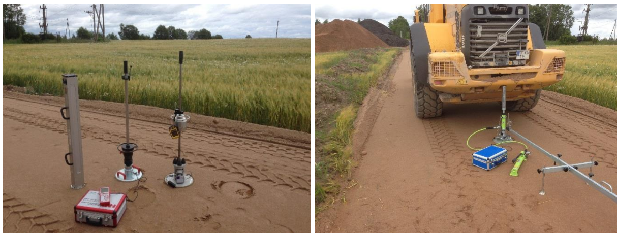
Joonised 2.2 ja 2.3. Seadmed, millega mõõdeti objektidelt liiv- ja kruuspinnase kandevõimed [Sten-Kristjan Saariku fotod]
