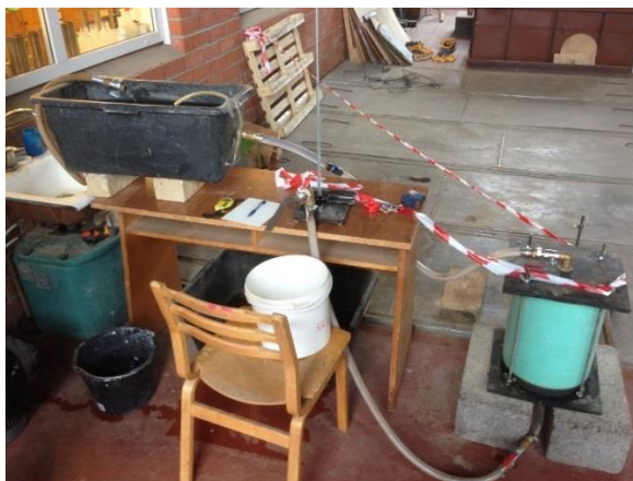
Joonis 3.13. Filtratsiooni mõõtmiseks ühendatud katseseade. [Sten-Kristjan Saariku foto]
