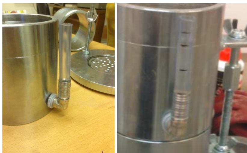
Joonis 3.4. Piesomeeter vee liikumiskiiruse mõõtmiseks. [Sten-Kristjan Saariku fotod]
