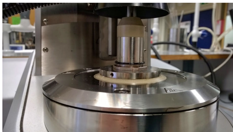
Joonis 4.7. Bituumeni proov 25 mm plaatide vahel [Sven Sillamäe]
