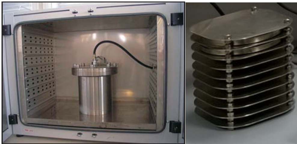
Joonised 4.3 ja 4.4. PAV-ahju sisemuses on survekamber, mille sees on riiulid, kuhu omakorda paigutatakse pannid bituumeniga [Sven Sillamäe]
