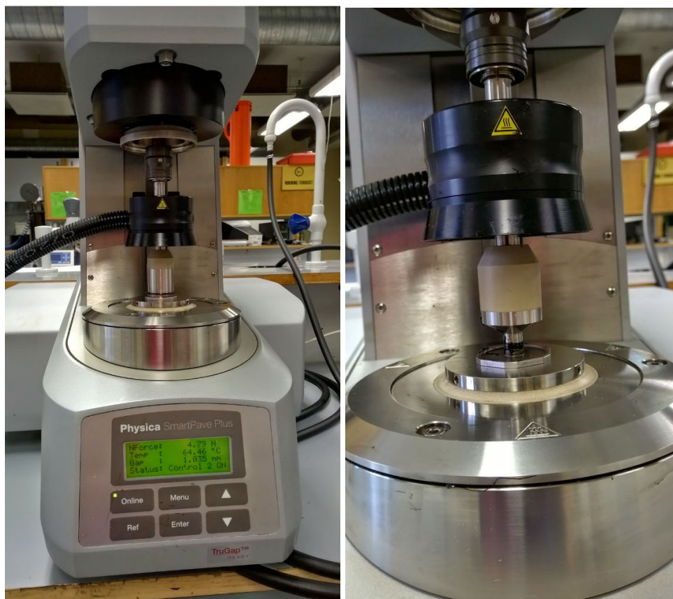
Joonised 4.5 ja 4.6. Dynamic Shear Rheometer 25 ja 8 mm plaatidega [Sven Sillamäe]
