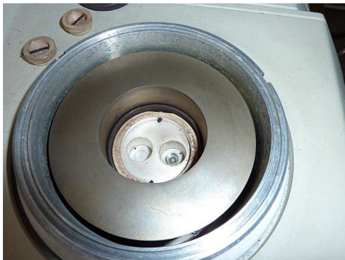
Joonis 7.13. DSC seadme katsekamber. Ühte silindrisse paigutatakse uuritav materjal ning teine jääb tühjaks ehk see on referentsnäiduks [Wikipedia].
