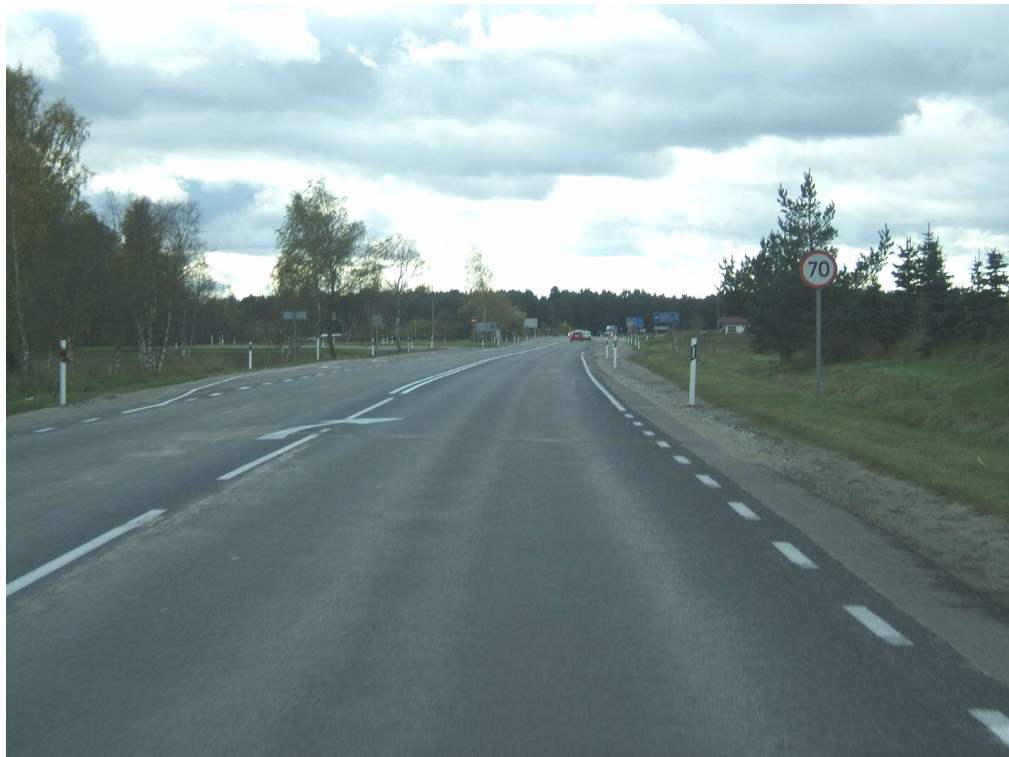
Km 8,3. Möödasõidukeeld peaks algama varem enne ristmiku piirkonda. Pahatihti jäetakse naasmine oma sõiduratta viimasele hetkele, mis võib põhjustada konflikti nii T15-lt vasakpöörajaga kui ka T 11-lt parempöörajaga (ei oska sõidukit sellelt rajalt oodata, ebaselgus tee andmisel).
