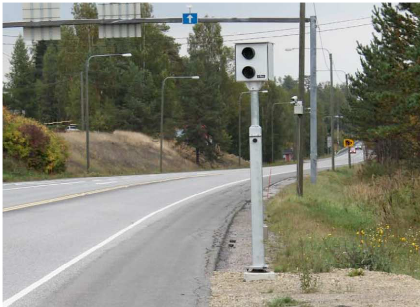
Joonis 7.3. ASSC testiteelõigu esimene kiiruskaamera riigimaanteel nr. 5 Heinola lähisel. Järgmise posti küljes on uurimistöös kasutatud VTT kiiruskaamera (Rajamäki, 2010)
