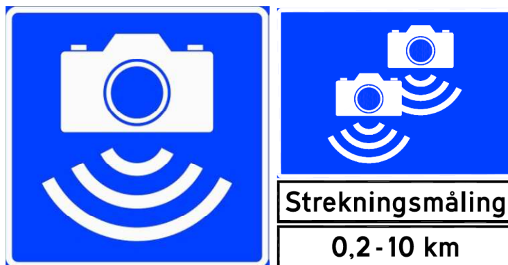
Joonis 6.3. Statsionaarsest kiiruskaamerast ja teelõigu läbimise keskmise kiiruse mõõtmisest (ASSC seadmetest) teavitavad liiklusmärgid Norras (Strekningmåling – teelõigul põhinev mõõtmine).
