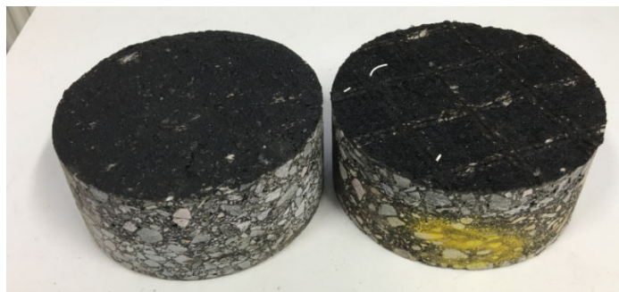
Joonis 1.85. Tensari testimine – tulemuseks saadi 1,33 kN, irdus pealmine asfaltkate geosünteedi küljest.
