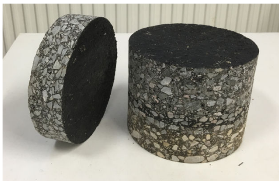
Joonis 1.86. Kulumiskihi testimine. Tulemuseks saadi vaid 0,8 kN.
