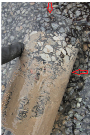
Joonis 5.8. Teine vaevunähtava praoga puurkeha. Kommentaariks saab öelda sama, mis joonise 5.7 puhul.
