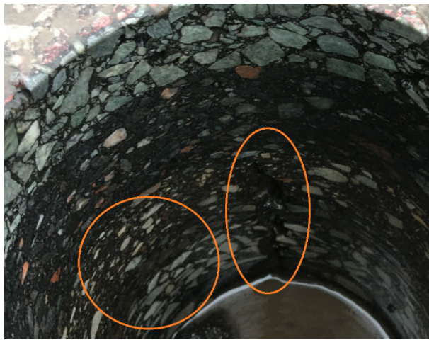
Joonis 1.77. Vaade puuraugu sisse näitab ka teise prao olemasolu, mida puurkehast ei nähtu.
