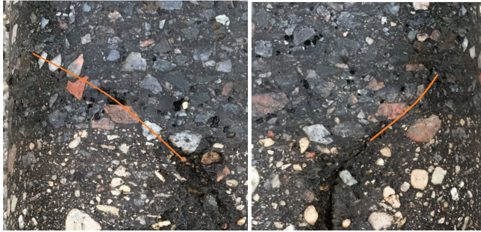
Joonis 1.76. Vaadates lähemalt joonisel 1.75 kujutatud puurkeha leiab justkui ilminguid sellele, et pragu oleks hakanud liikuma alt ülespoole.
