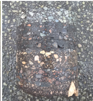
Joonised 1.91 ja 1.92. Puurkeha puurimine kõige sügavama roopaga kohast.
