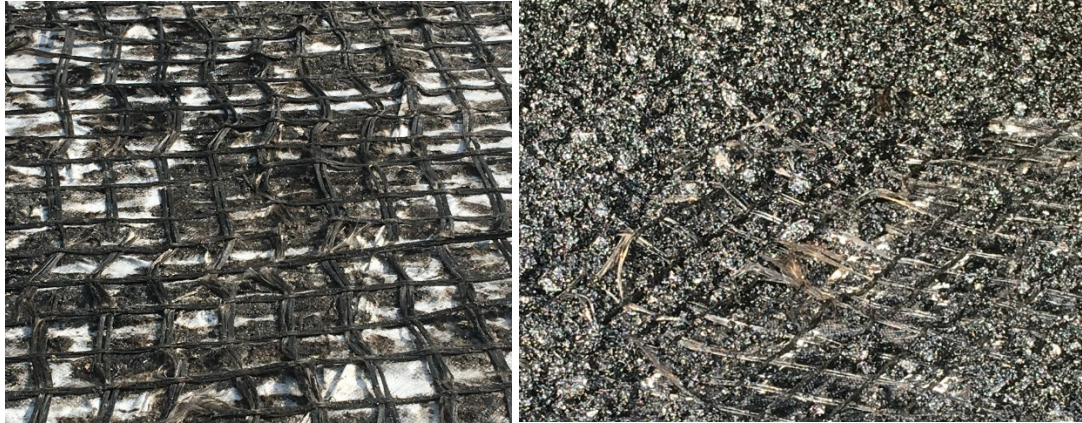
Joonis 5.42. Klaaskiud on rabe ja puruneb kergesti, kui seda „vääntutada“.
