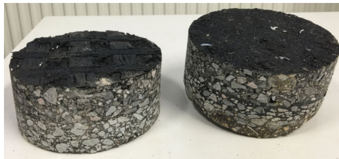
Joonis 1.84. Teise Stargridi testimine – tulemust kirja ei saadud, võrk irdus alumiselt kihilt.
