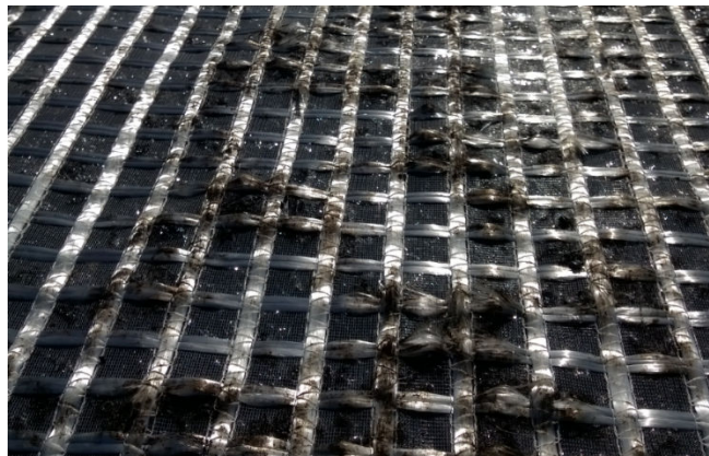
Joonis 5.36. Klaaskiud on olemuselt väga rabe. Kui aluse ebatasasused on liiga teravad, materjal puruneb. Samuti oli probleem selles, kui auto sõitis materjali peal, hakkas see tõmbelemente puruks rebima, kuna materjal ei olnud aluse küljes piisavalt tugevalt kinni.
